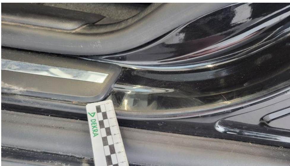
Fot. 73. Próg L - Rysa/odprysk 1
