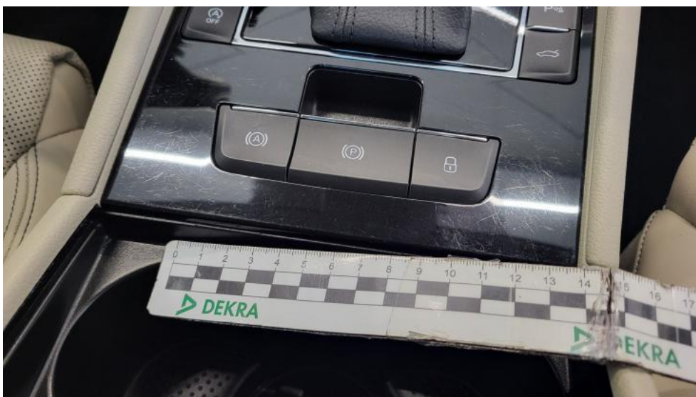
Fot. 58. Konsola tunelu śr. - Rysa/odprysk 1
