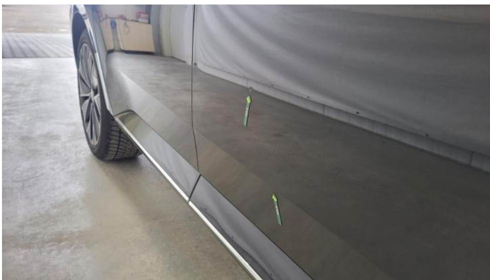
Fot. 47. Drzwi przednie P - Wgniecenie/odkształcenie 1
