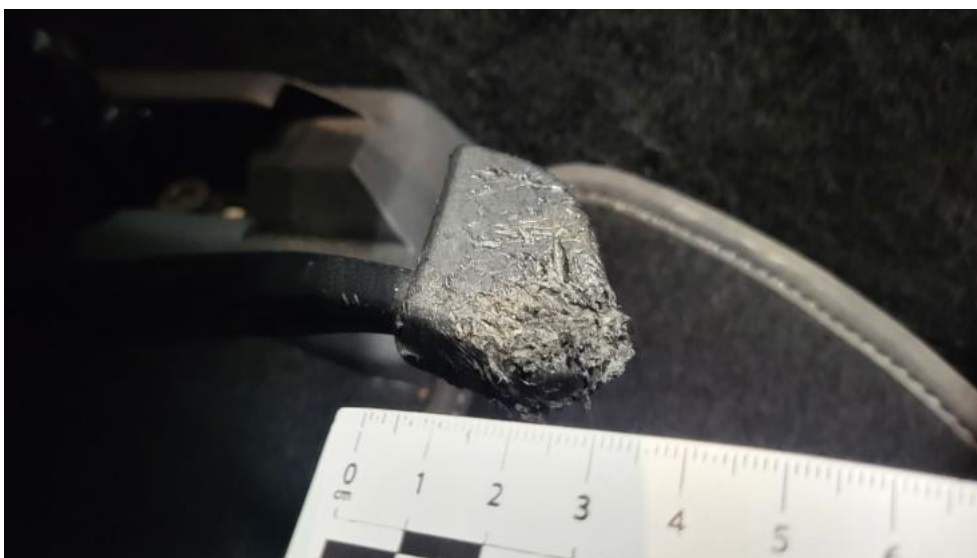
Fot. 74. Fotel prz. praw. - Rysa/odprysk 1
