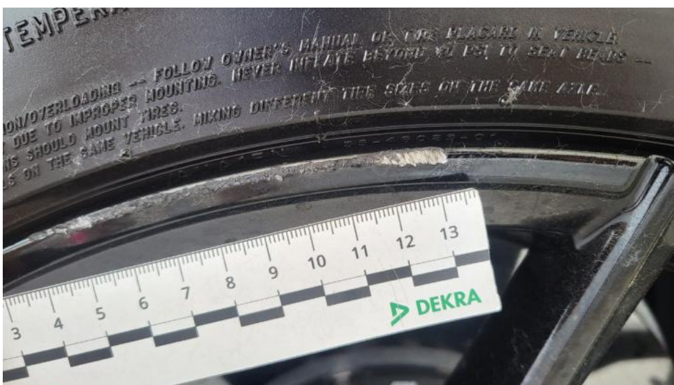
Fot. 56. Felga aluminiowa tylna P - Rysa/odprysk 1
