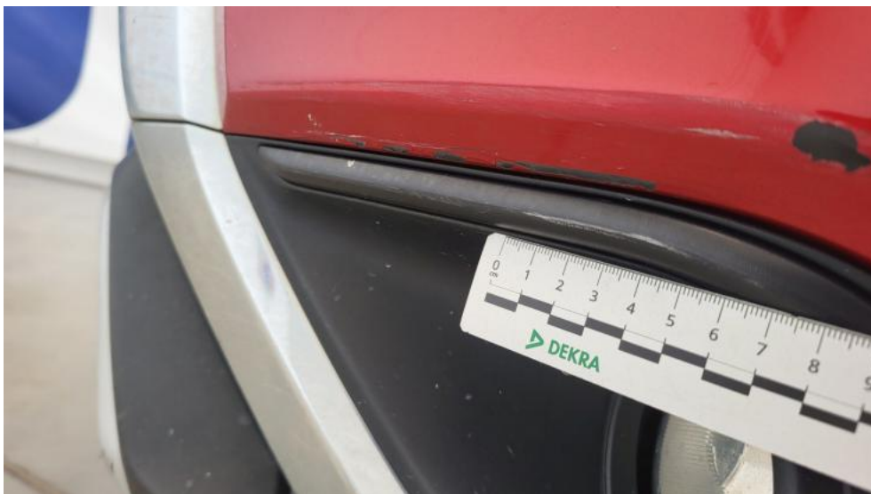
Photo 40. Kratka/zaślepka halogenu L - Rysa/odprysk 1
