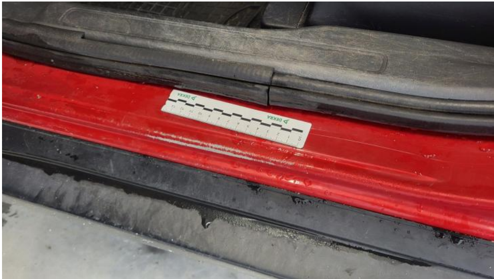
Photo 117. Próg L - Rysa/odprysk 2
