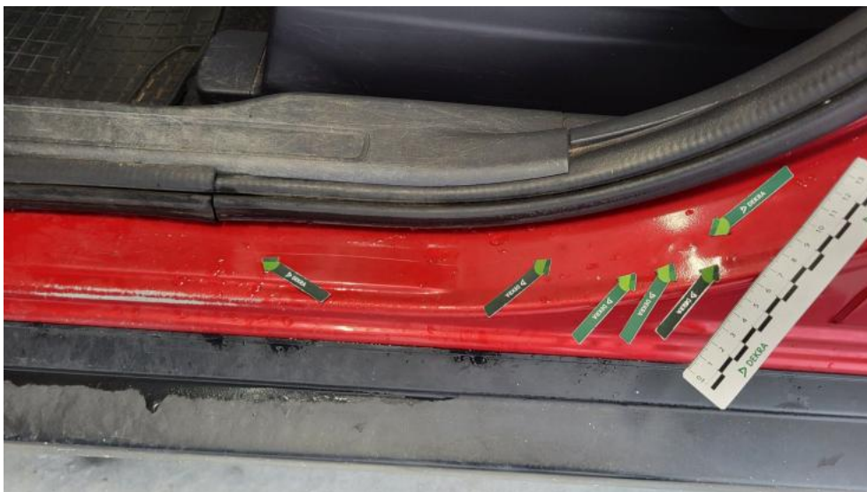
Photo 118. Próg L - Wgniecenie/odkształcenie 1
