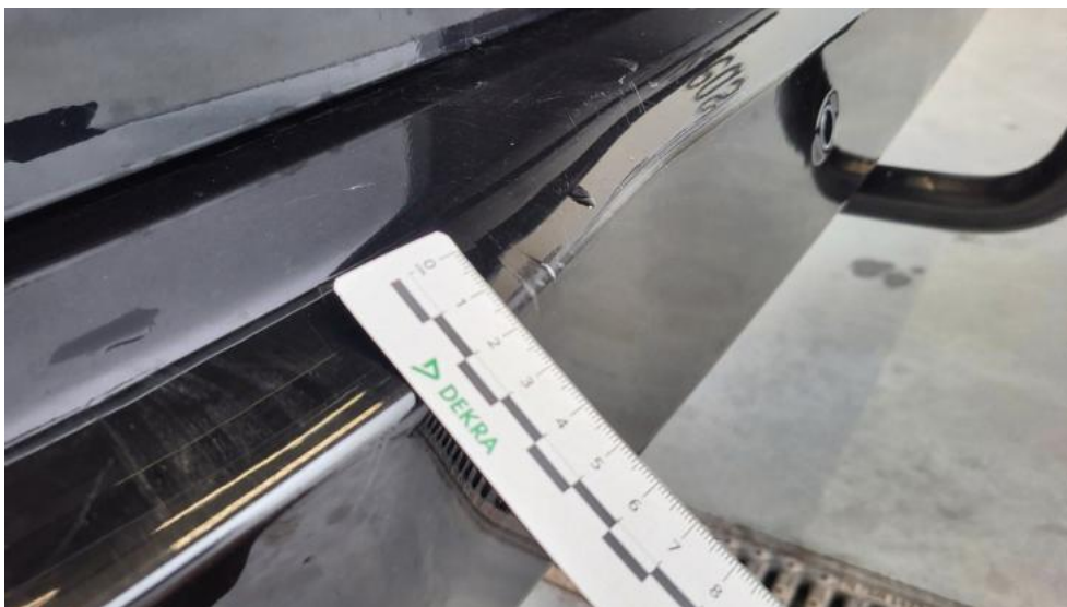
Fot. 60. Zderzak tylny - Wgniecenie/odkształcenie 2
