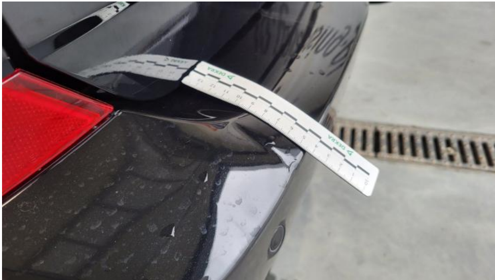
Fot. 59. Zderzak tylny - Wgniecenie/odkształcenie 1
