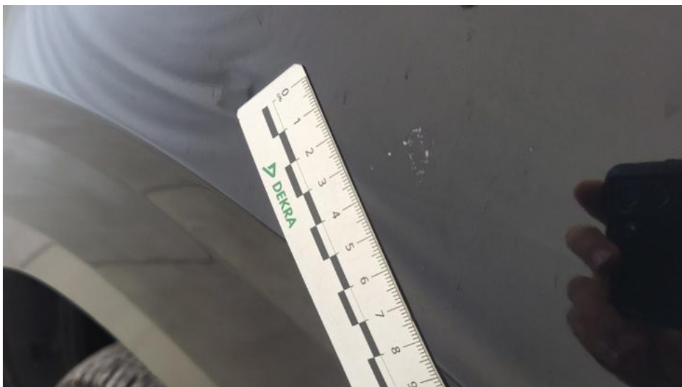
Fot. 44. Błotnik przedni P - Rysa/odprysk 1
