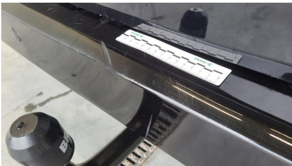
Fot. 58. Zderzak tylny - Rysa/odprysk 2
