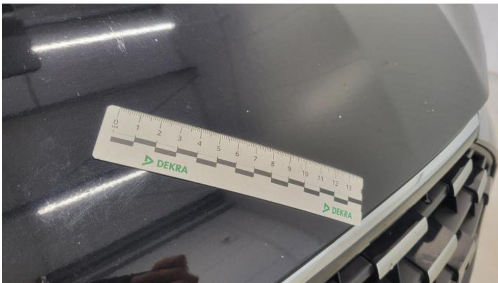
Fot. 39. Pokrywa komory silnika - Rysa/odprysk 1
