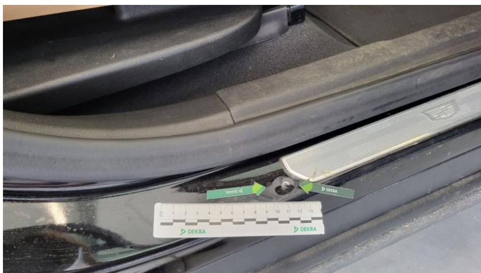
Fot. 67. Próg P - Wgniecenie/odkształcenie 1
