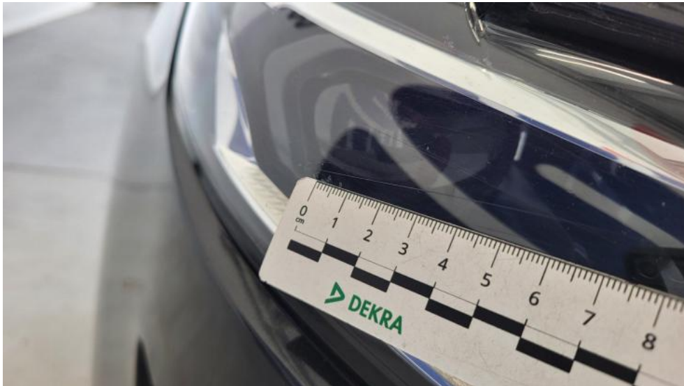
Fot. 61. Reflektor P - Rysa/odprysk 1
