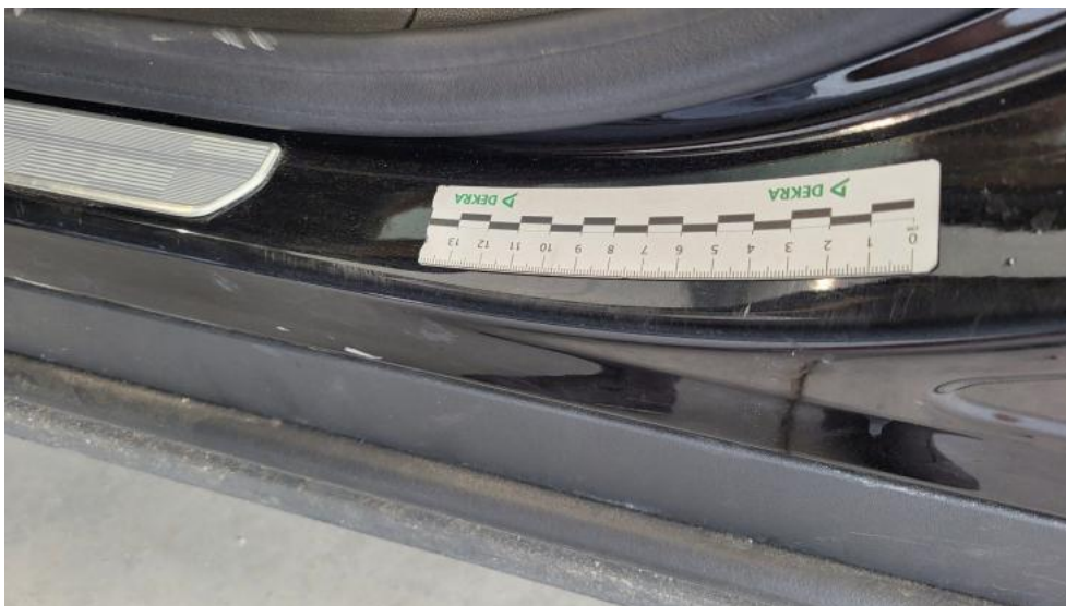
Fot. 89. Próg L - Rysa/odprysk 1
