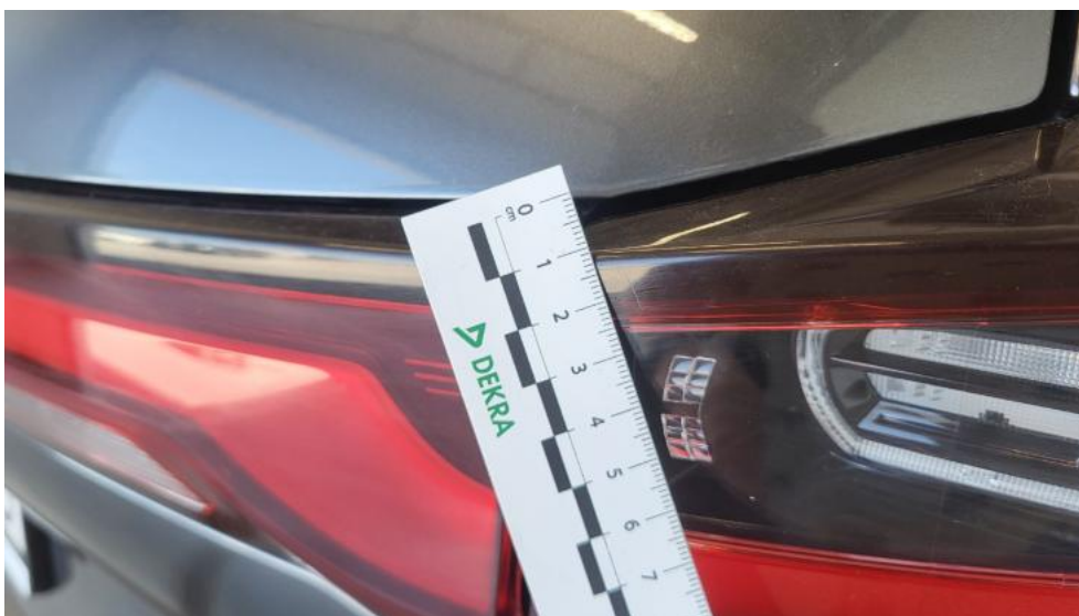
Fot. 48. Lampa tylna zew P - Rysa/odprysk 1
