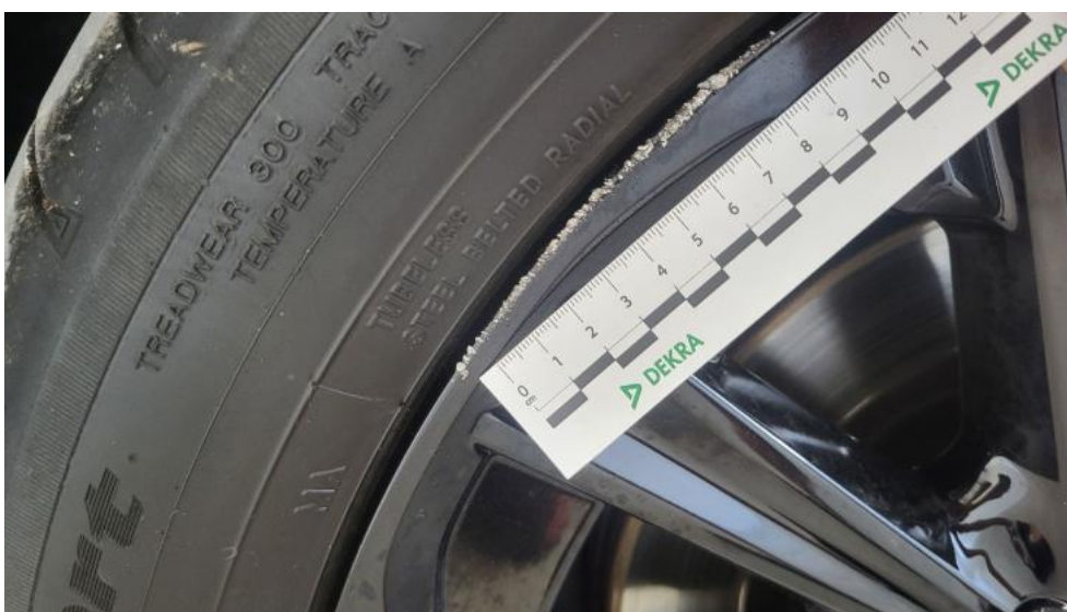
Fot. 56. Felga Aluminiowa przednia L - Rysa/odprysk 1
