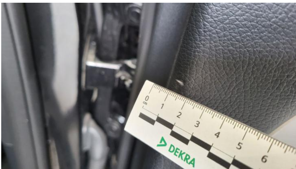
Fot. 66. Tapicerka drzwi tylnych P - Wgniecenie/odkształcenie 1
