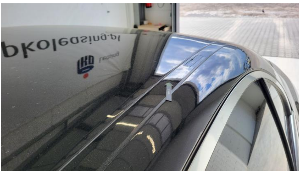
Fot. 50. Listwy dachu lew. - Wgniecenie/odkształcenie 1
