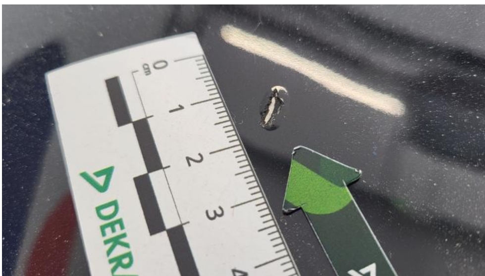
Fot. 42. Pokrywa komory silnika - Rysa/odprysk 1
