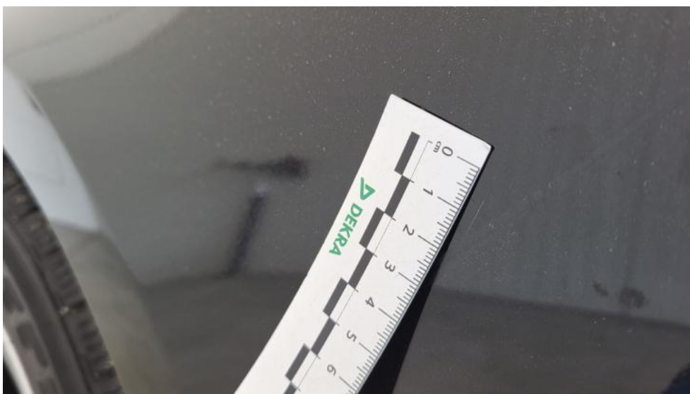
Fot. 60. Błotnik przedni L - Rysa/odprysk 1
