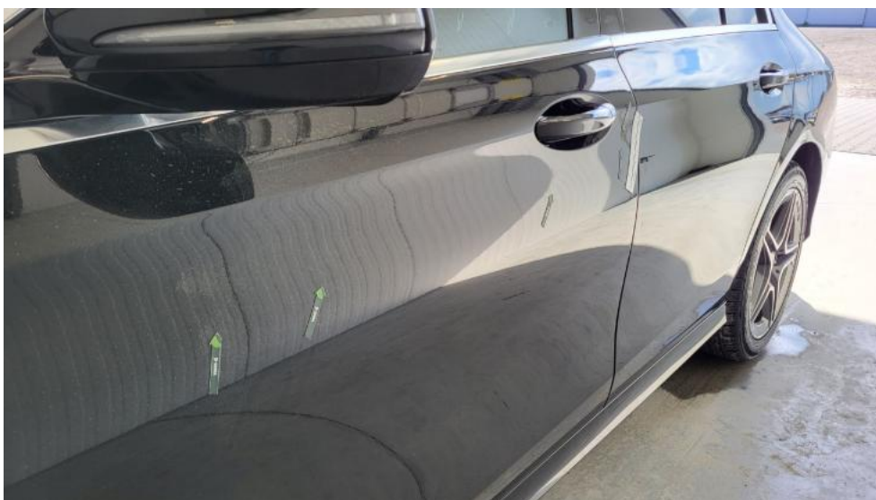
Fot. 54. Drzwi przed L - Wgniecenie/odkształcenie 1
