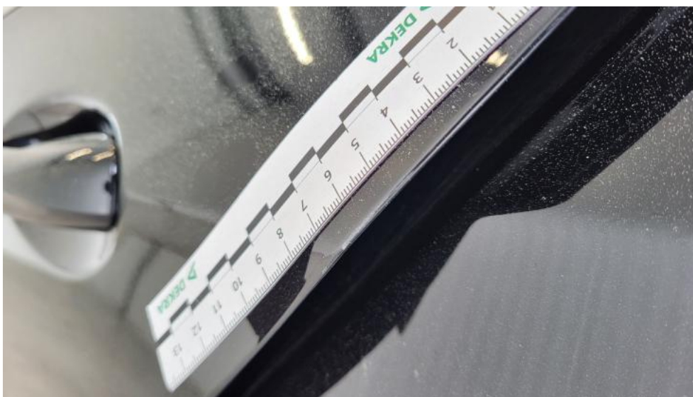
Fot. 55. Drzwi tylne L - Rysa/odprysk 1
