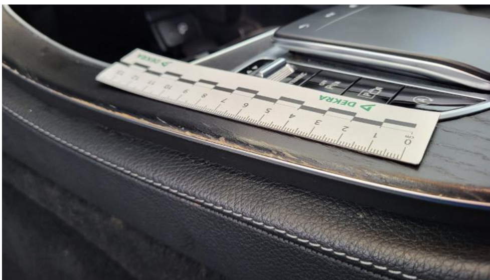
Fot. 63. Konsola tunelu śr. - Rysa/odprysk 1
