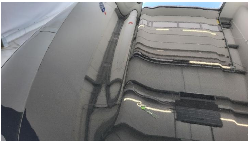
Fot. 43. Pokrywa komory silnika - Wgniecenie/odkształcenie 1
