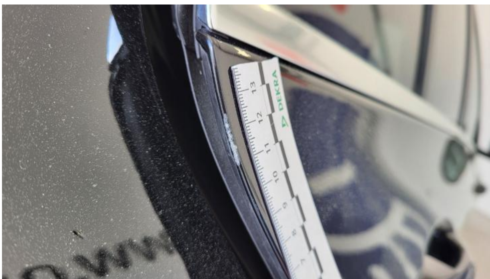
Fot. 46. Drzwi tylne P - Rysa/odprysk 1
