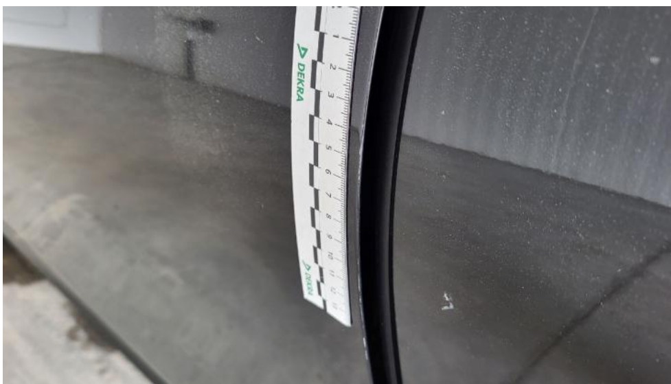
Fot. 53. Drzwi przed L - Rysa/odprysk 1
