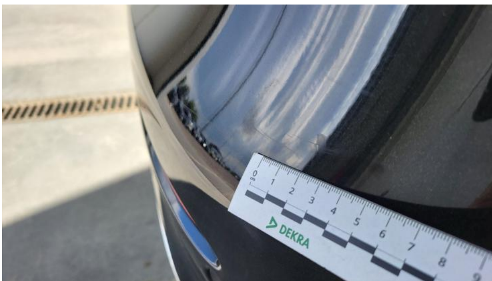
Fot. 49. Zderzak tylny - Rysa/odprysk 1
