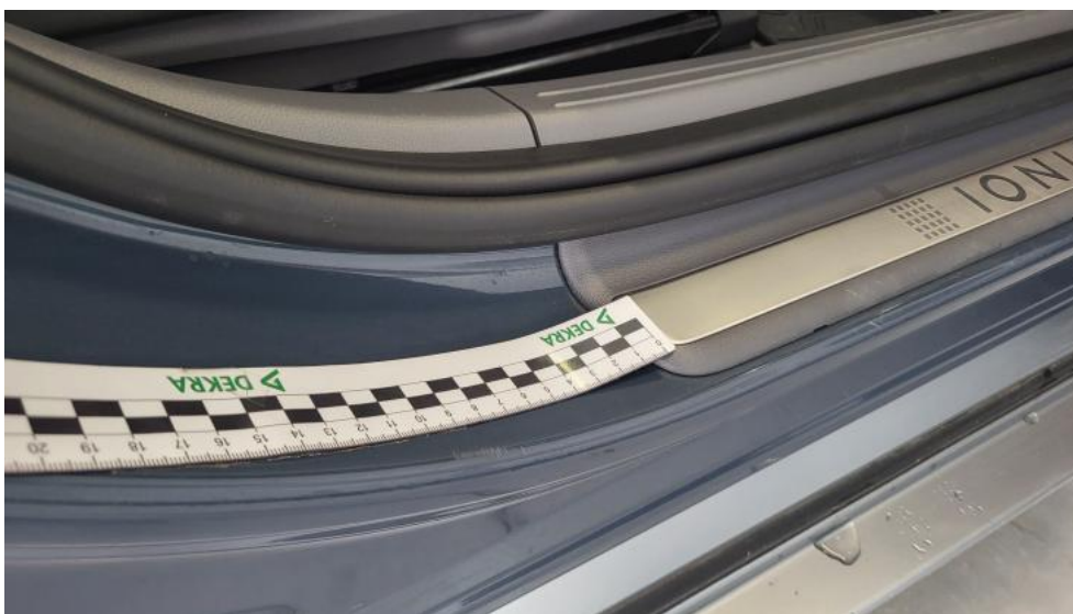
Fot. 57. Próg P - Rysa/odprysk 1
