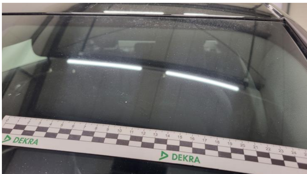
Photo 50. Szyba czołowa - Rysa/odprysk 1
