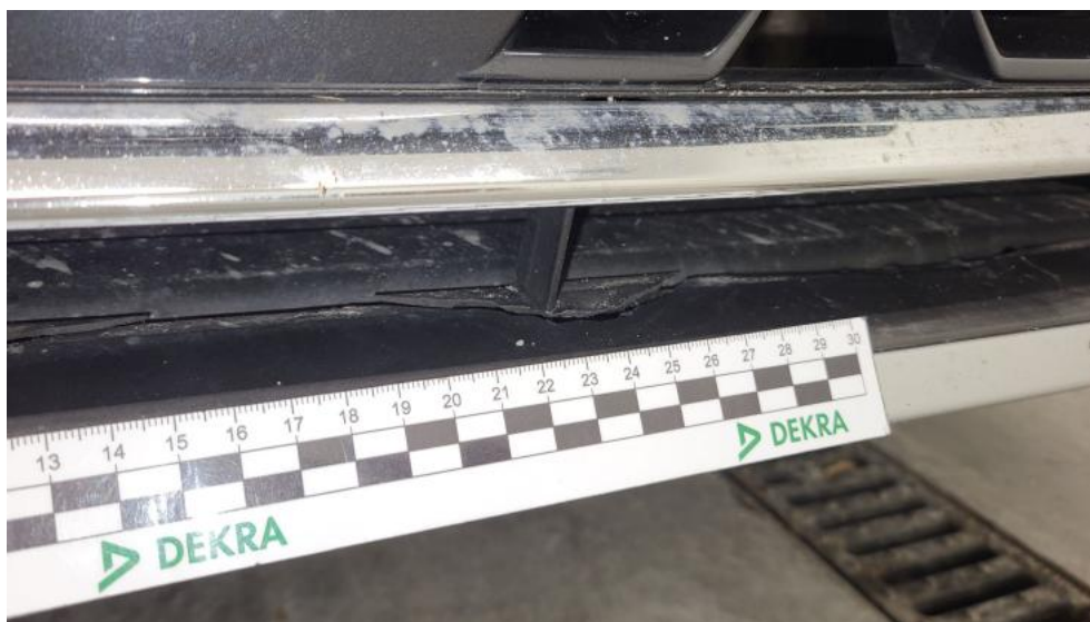
Photo 45. Krata zderzaka prz. - Pęknięcie/rozerwanie 2
