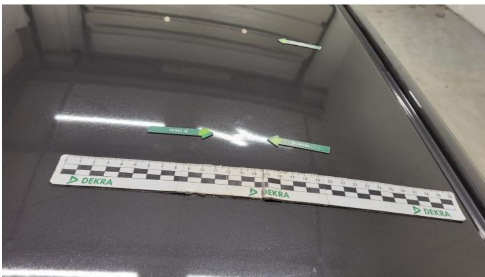
Fot. 78. Dach - Wgniecenie/odkształcenie 1
