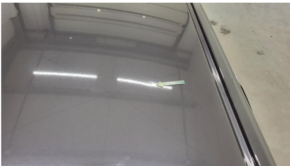
Fot. 79. Dach - Wgniecenie/odkształcenie 2
