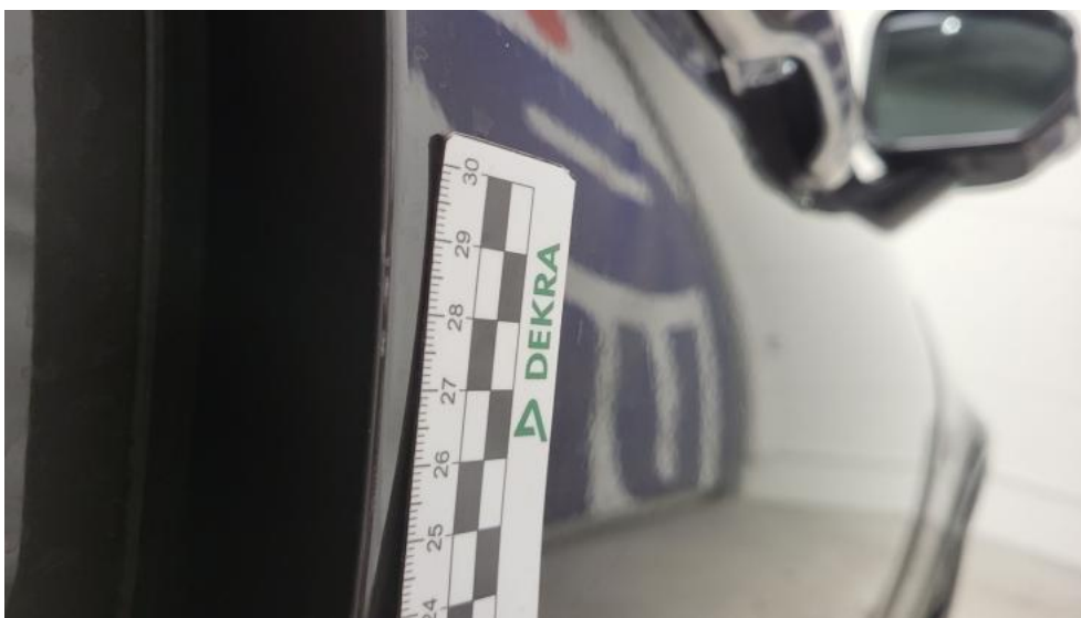
Fot. 65. Drzwi przednie P - Rysa/odprysk 1
