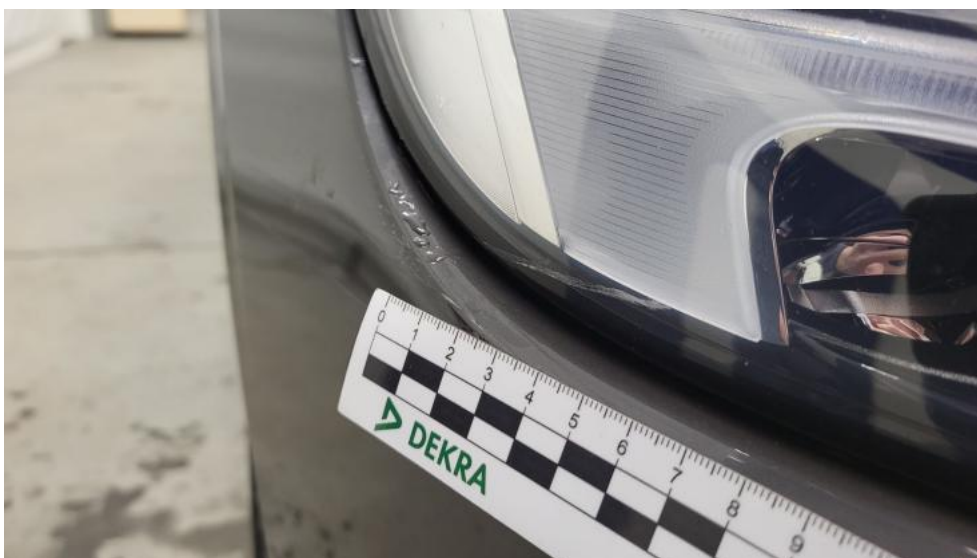
Fot. 64. Reflektor P - Rysa/odprysk 1
