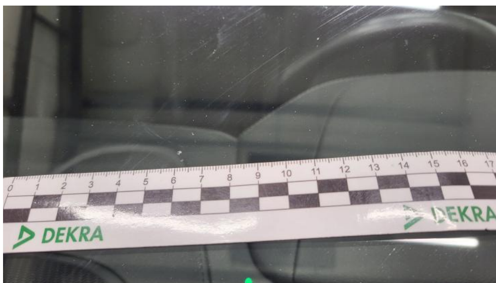
Fot. 56. Szyba czołowa - Rysa/odprysk 1
