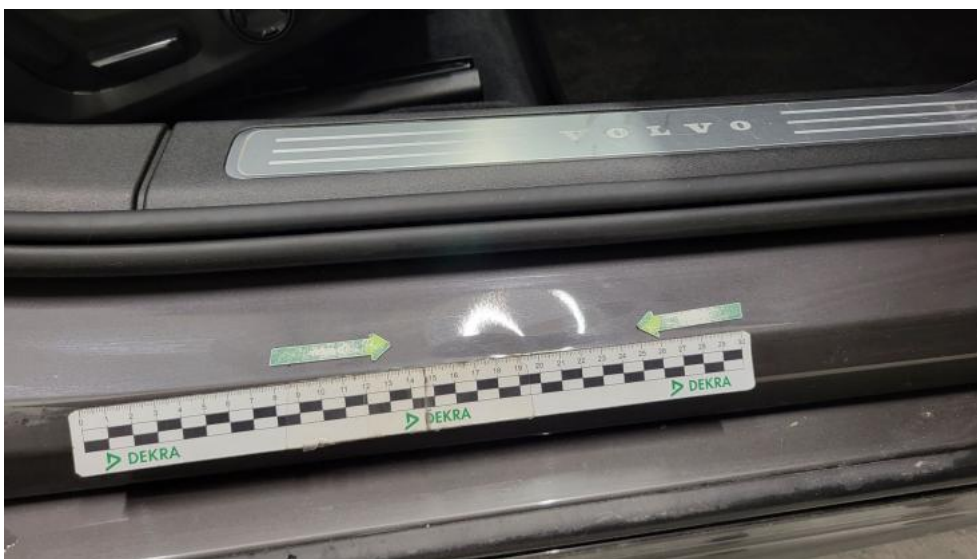
Fot. 67. Próg P - Wgniecenie/odkształcenie 1
