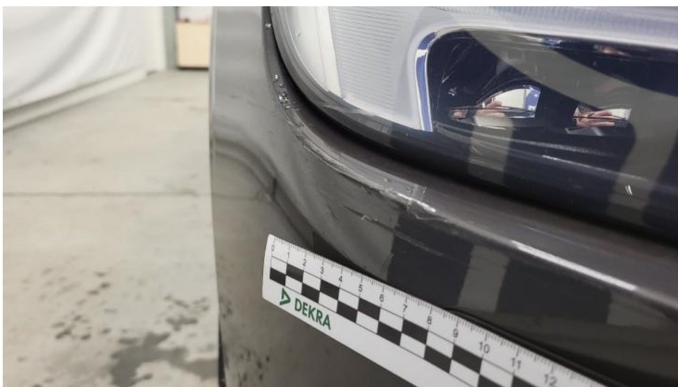
Fot. 58. Zderzak - Rysa/odprysk 1
