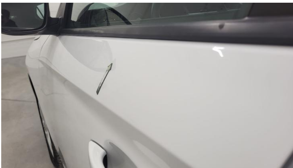
Fot. 65. Drzwi przed L - Wgniecenie/odkształcenie 1
