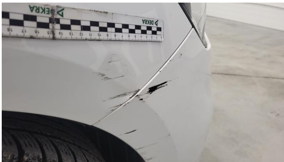
Fot. 41. Błotnik przedni P - Rysa/odprysk 1
