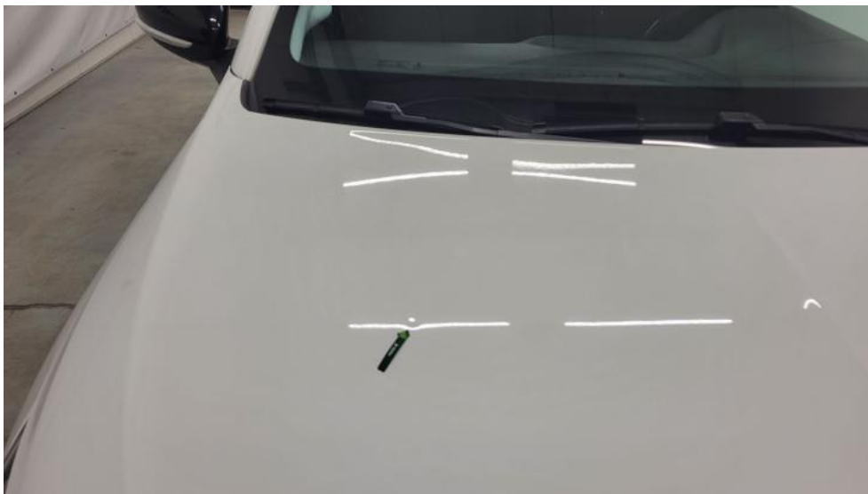
Fot. 37. Pokrywa komory silnika - Wgniecenie/odkształcenie 1
