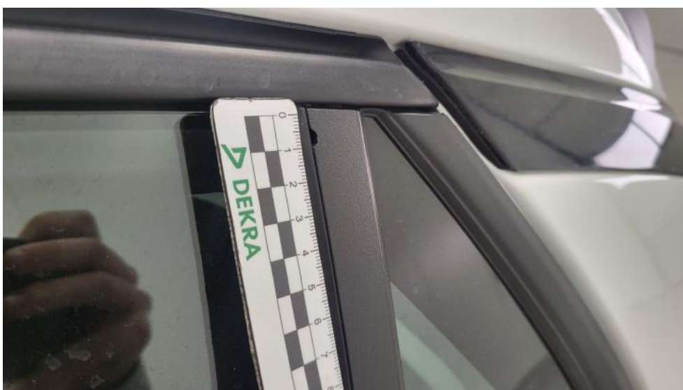
Fot. 68. Listwa drzwi przednich L - Pęknięcie/rozerwanie 1
