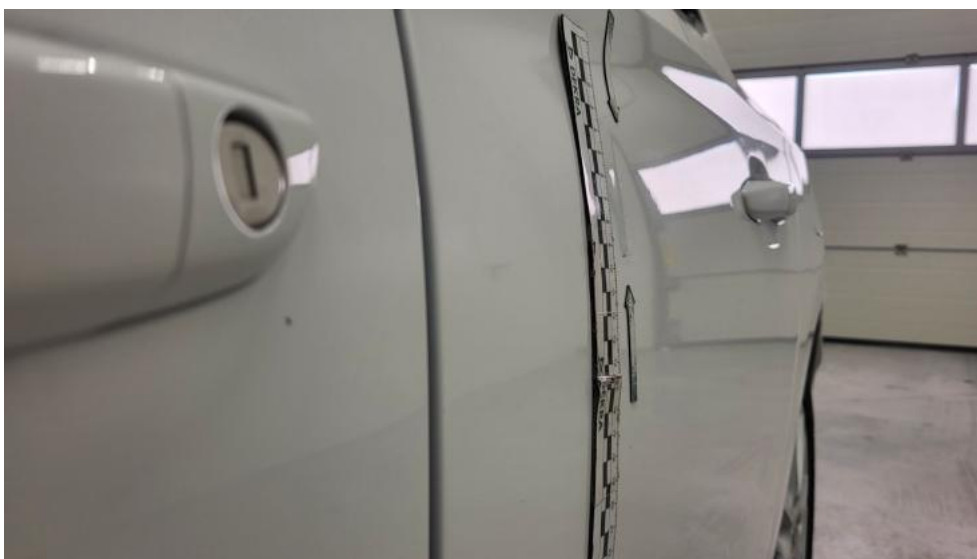
Fot. 67. Drzwi tylne L - Wgniecenie/odkształcenie 1
