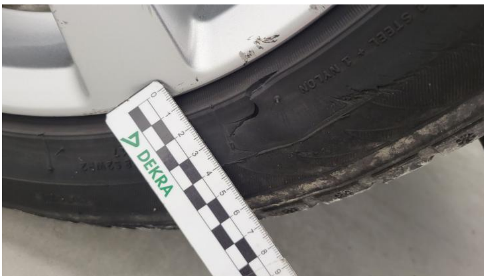
Fot. 46. Opona przednia P - Pęknięcie/rozerwanie 2
