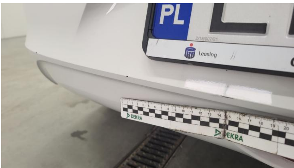
Fot. 60. Zderzak tylny() - Rysa/odprysk 3
