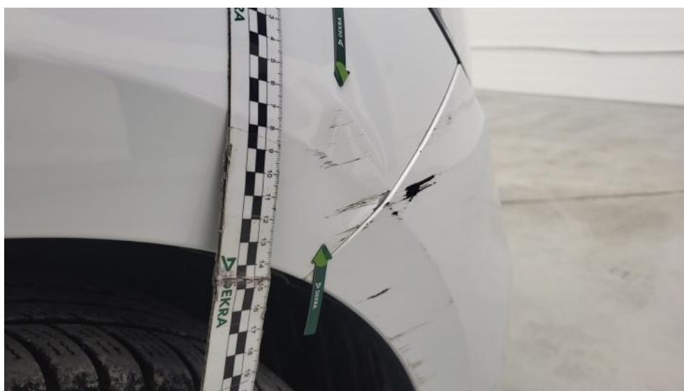
Fot. 42. Błotnik przedni P - Wgniecenie/odkształcenie 1
