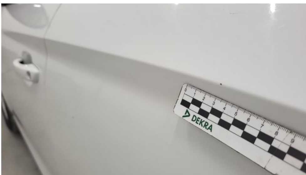
Fot. 66. Drzwi tylne L - Rysa/odprysk 1
