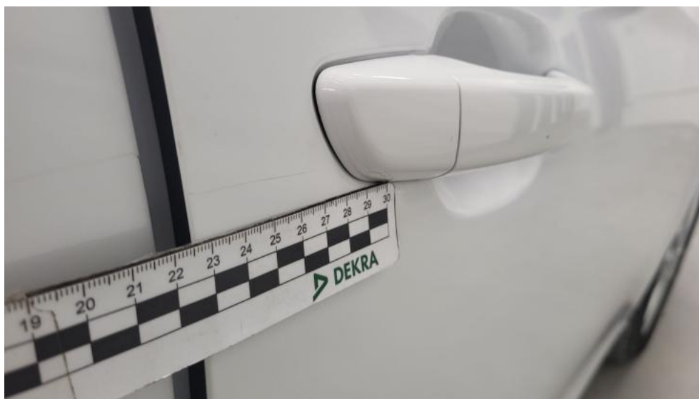
Fot. 47. Drzwi przednie P - Rysa/odprysk 1
