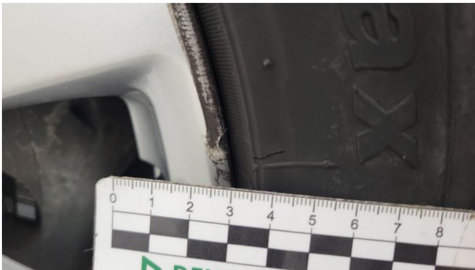
Fot. 45. Opona przednia P - Pęknięcie/rozerwanie 1
