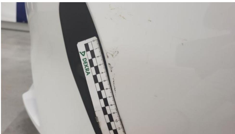
Fot. 38. Zderzak - Rysa/odprysk 1
