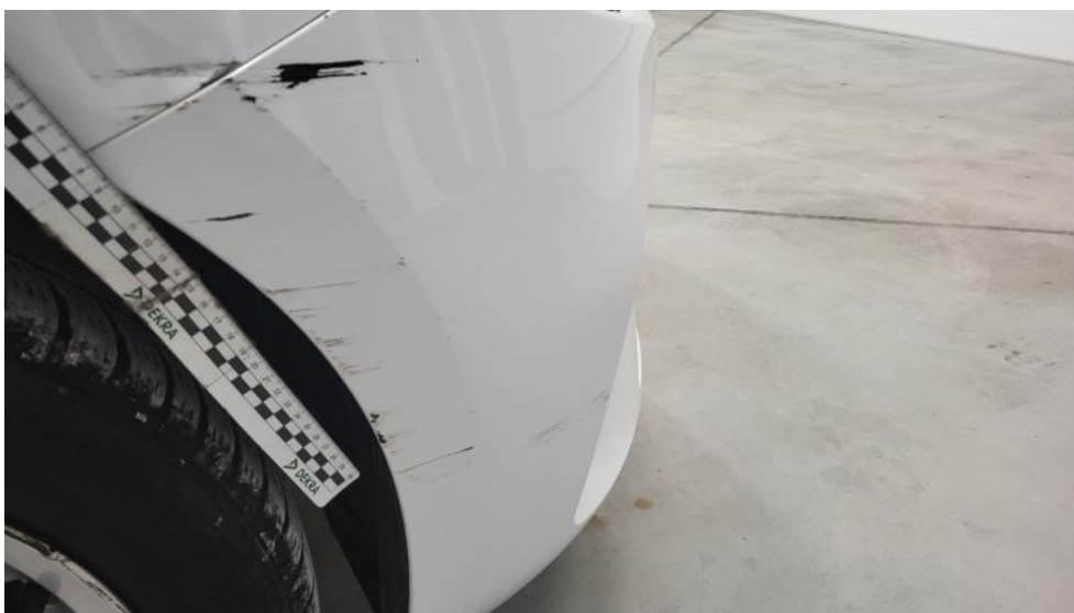
Fot. 40. Zderzak() - Rysa/odprysk 3
