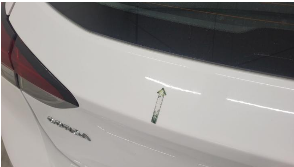
Fot. 57. Pokrywy bagażnika - Wgniecenie/odkształcenie 1
