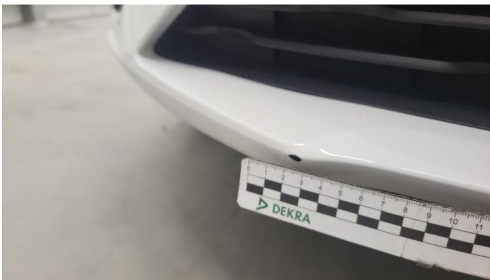
Fot. 39. Zderzak - Rysa/odprysk 2
