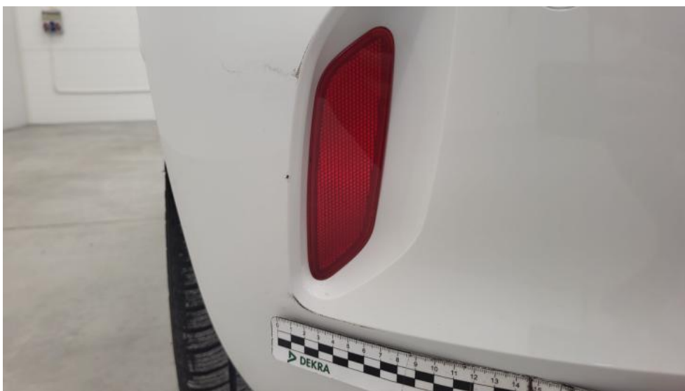
Fot. 58. Zderzak tylny - Rysa/odprysk 1
