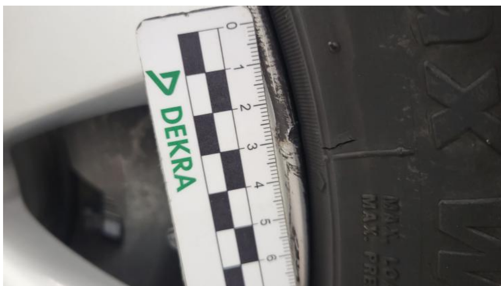
Fot. 44. Felga aluminiowa przednia P - Rysa/odprysk 2
