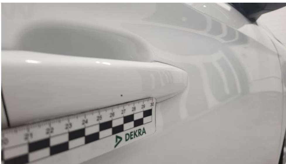
Fot. 53. Klamka drzwi prz P - Rysa/odprysk 1
