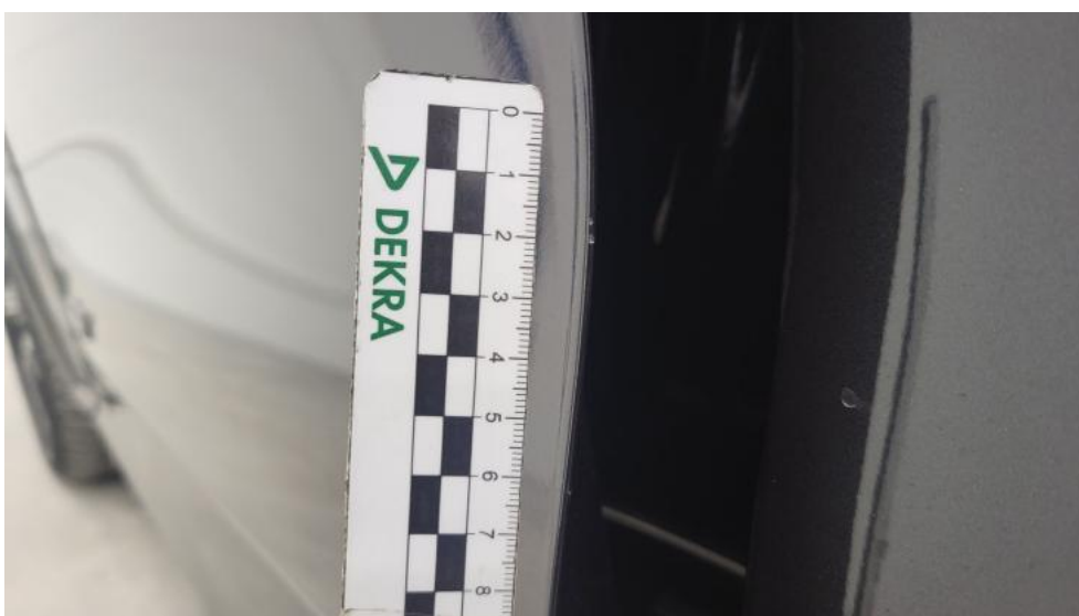
Fot. 56. Drzwi przed L - Rysa/odprysk 1
