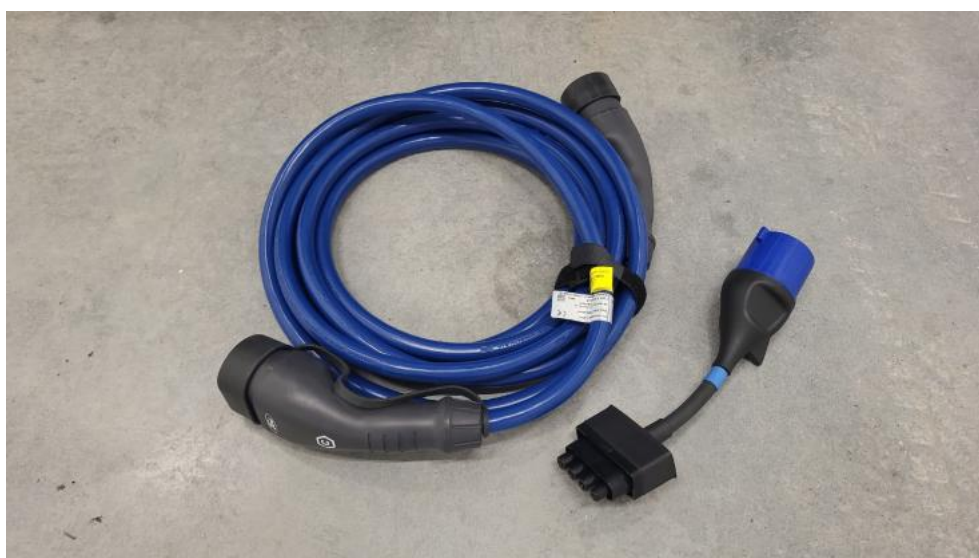
Fot. 34. Przewód ładowania baterii trakcyjnej
