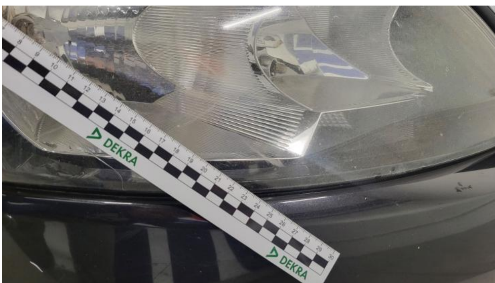
Photo 60. Reflektor P - Rysa/odprysk 2
