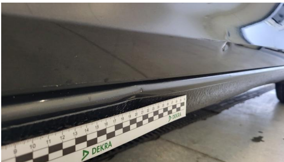
Photo 157. Próg L - Wgniecenie/odkształcenie 1
