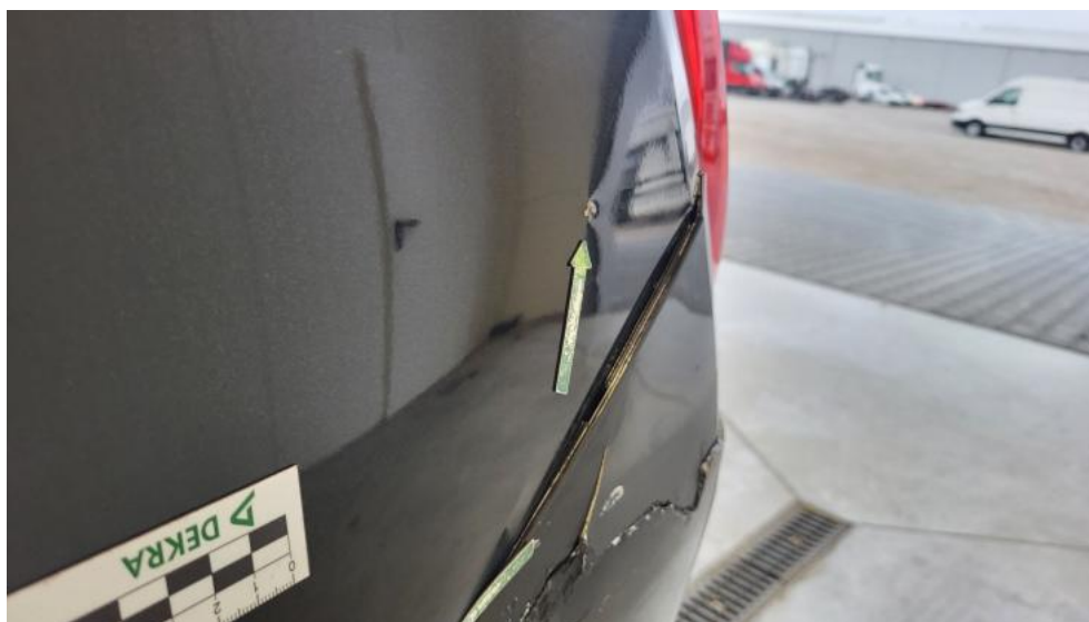
Photo 137. Błotnik tylny L / Ściana boczna L - Wgniecenie/odkształcenie 2
