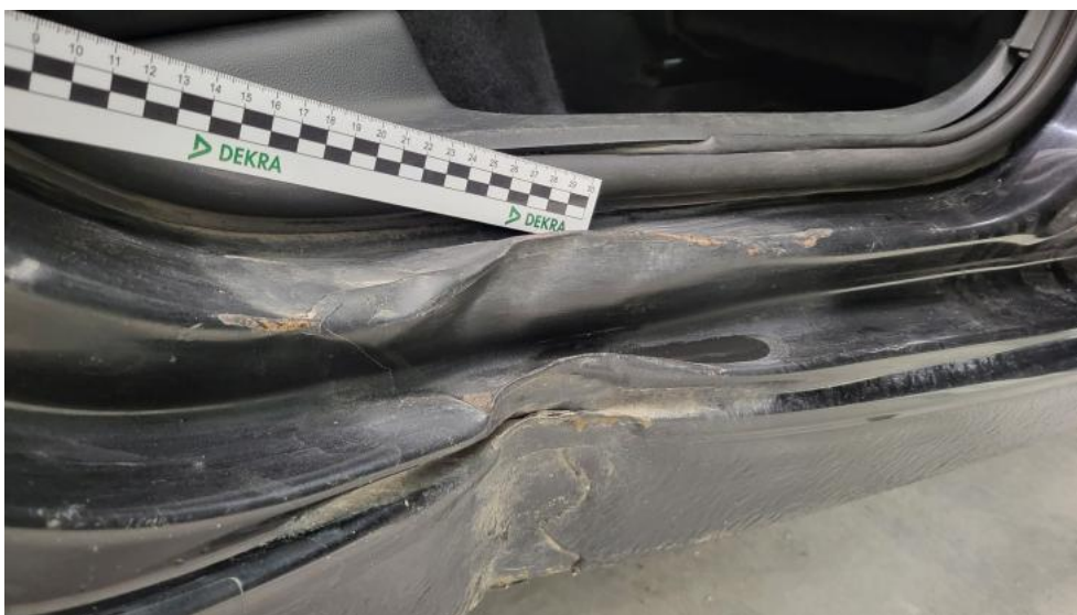
Photo 88. Próg P - Wgniecenie/odkształcenie 2
