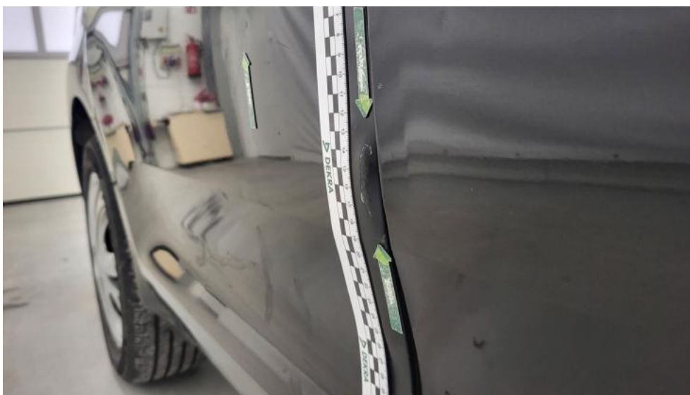
Photo 77. Drzwi tylne P - Wgniecenie/odkształcenie 1
