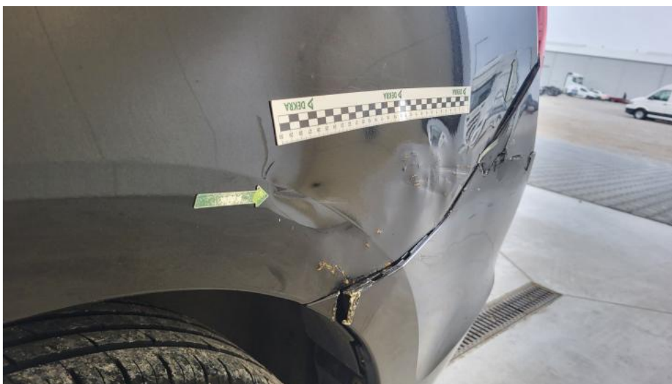
Photo 136. Błotnik tylny L / Ściana boczna L - Wgniecenie/odkształcenie 1
