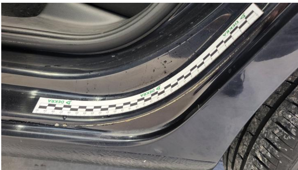
Photo 155. Próg L - Rysa/odprysk 1
