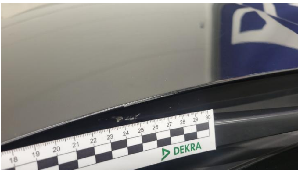
Photo 40. Pokrywa komory silnika - Rysa/odprysk 1
