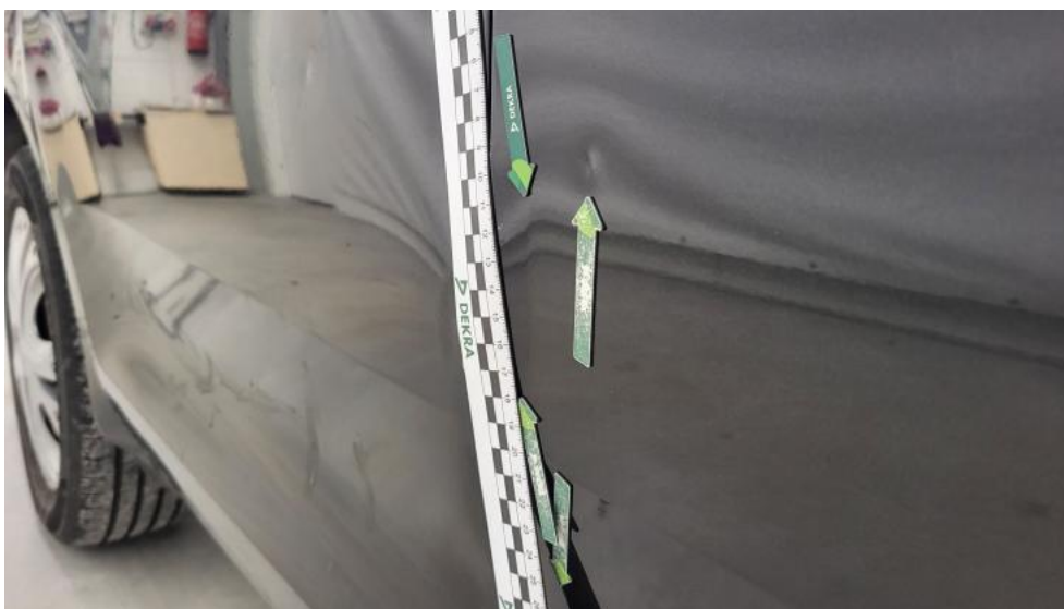
Photo 67. Drzwi przednie P - Wgniecenie/odkształcenie 2
