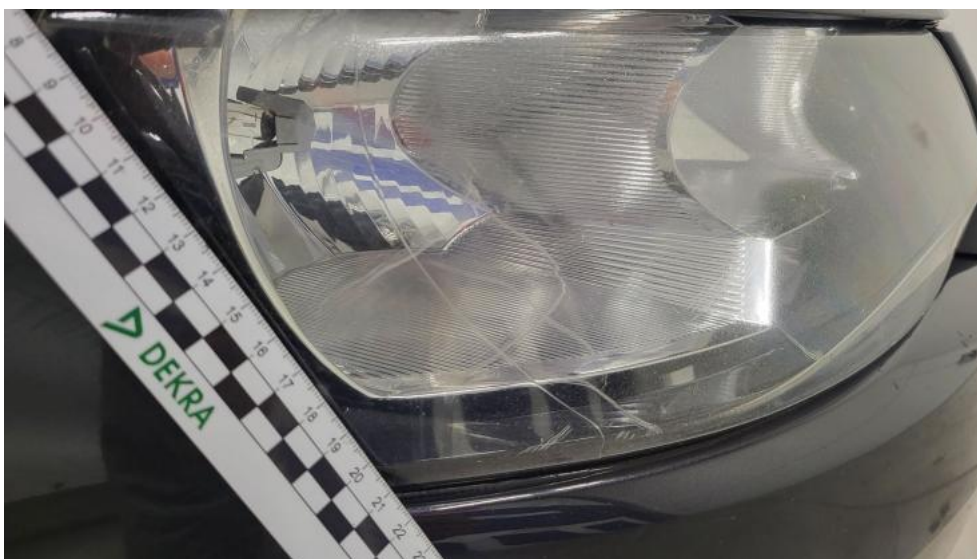
Photo 59. Reflektor P - Rysa/odprysk 1
