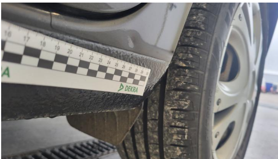
Photo 158. Próg L - Wgniecenie/odkształcenie 2
