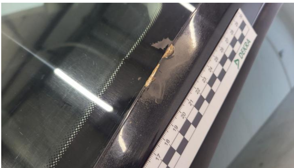
Photo 161. Stupek przedni L - Rysa/odprysk 1
