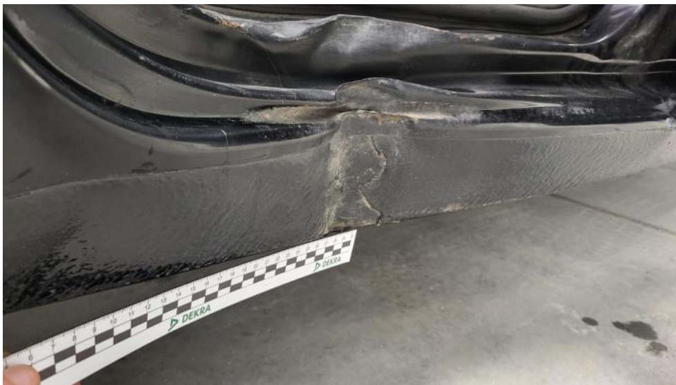
Photo 87. Próg P - Wgniecenie/odkształcenie 1
