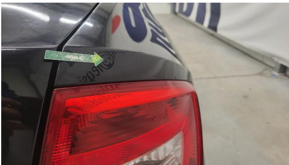
Photo 101. Błotnik tylny P / Ściana boczna P - Wgniecenie/odkształcenie 2
