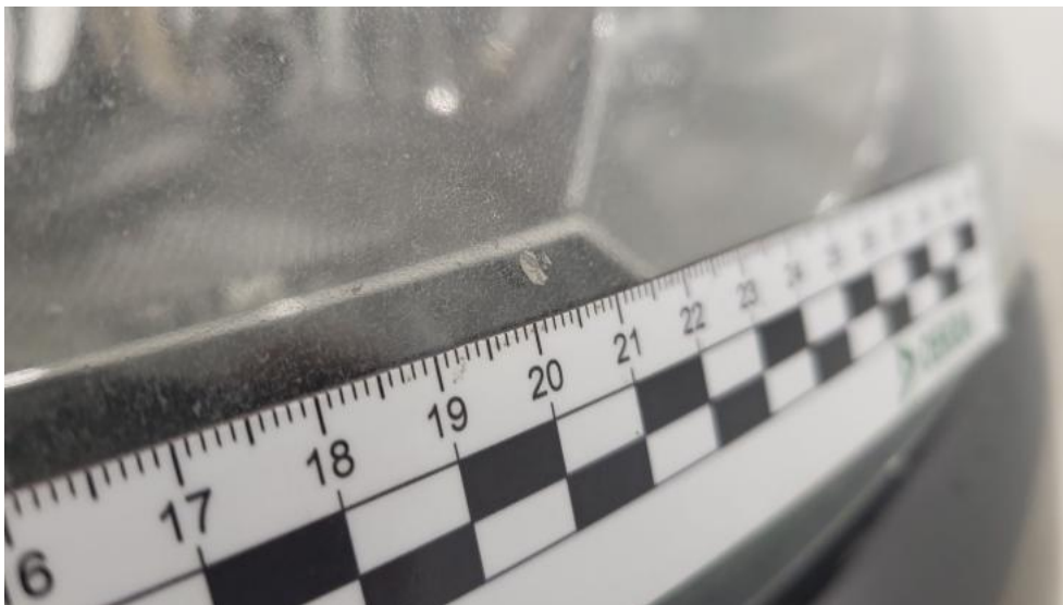
Photo 167. Reflektor L - Pęknięcie/rozerwanie 1
