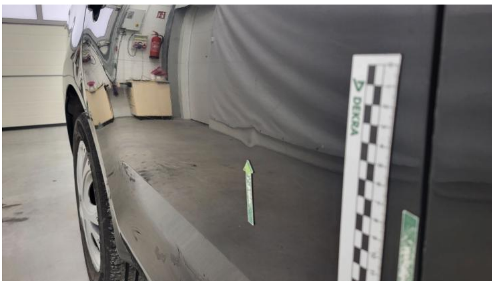
Photo 78. Drzwi tylne P - Wgniecenie/odkształcenie 2
