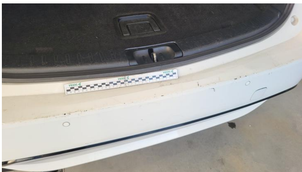
Fot. 94. Zderzak tylny - Pęknięcie/rozerwanie 2
