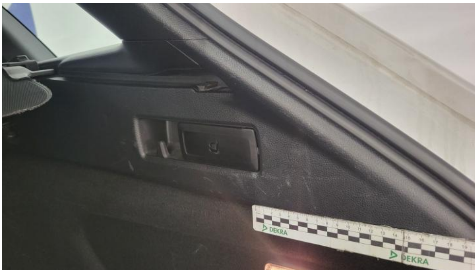
Fot. 129. Wykładzina przestrzeni bagażowej - Rysa/odprysk 2
