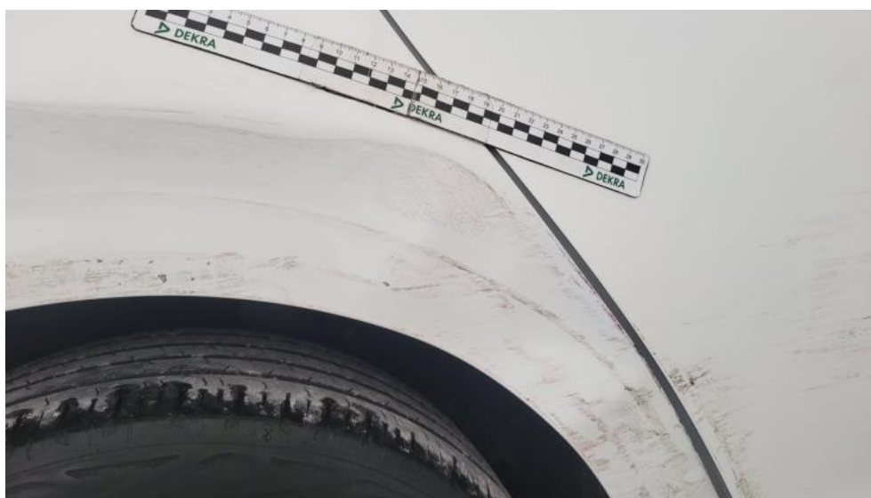
Fot. 78. Błotnik tylny P / Ściana boczna P() - Rysa/odprysk 3
