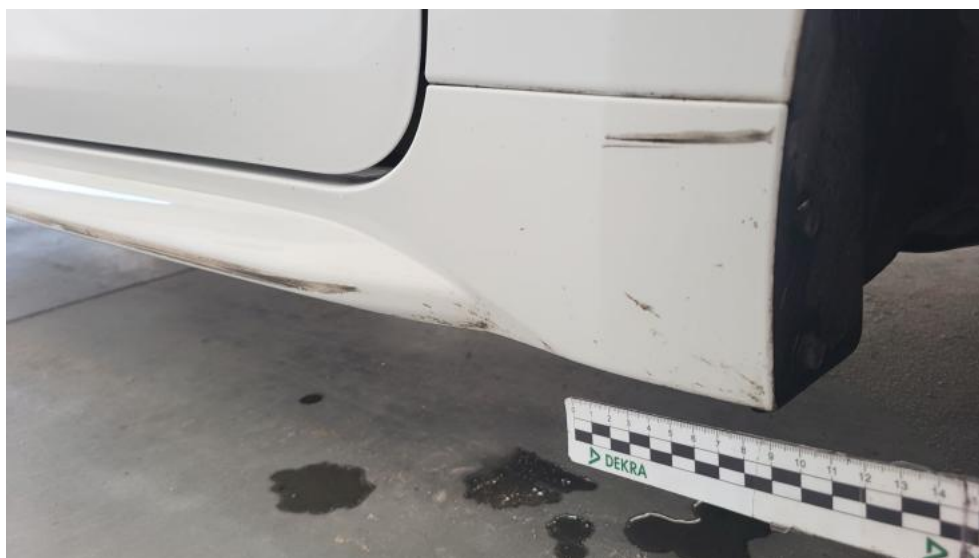
Fot. 72. Próg P - Rysa/odprysk 1
