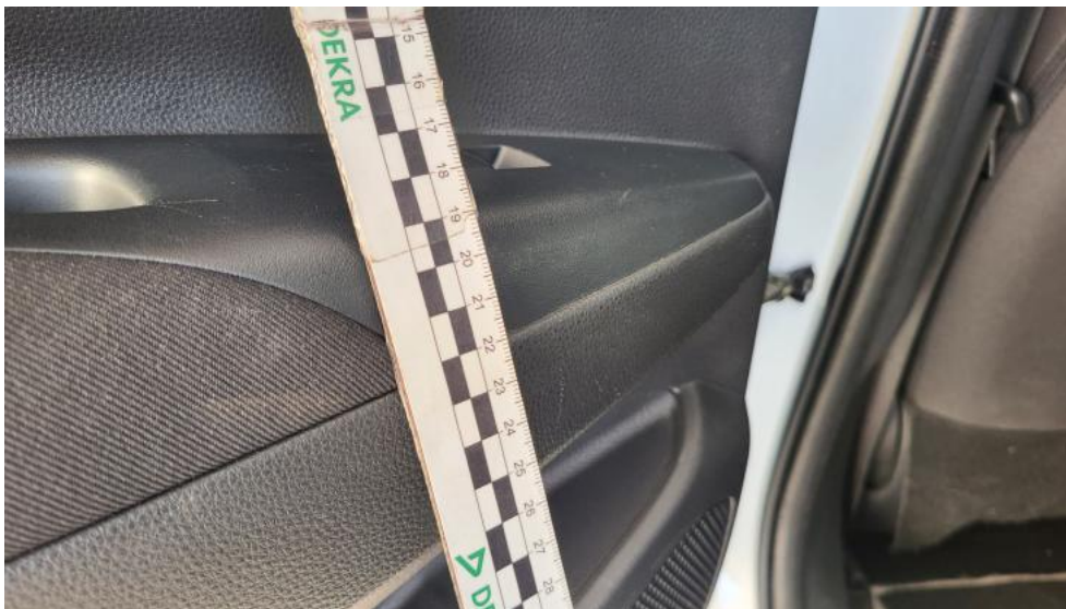
Fot. 115. Tapicerka drzwi tylnych L - Rysa/odprysk 1
