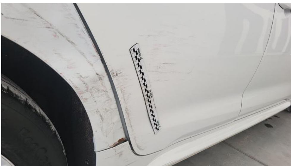
Fot. 65. Drzwi tylne P - Rysa/odprysk 2
