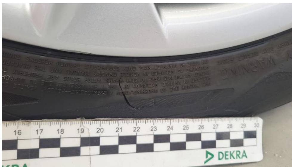
Fot. 54. Opona przednia P() - Pęknięcie/rozerwanie 3
