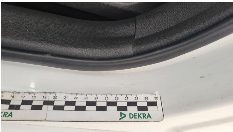
Fot. 104. Próg L - Rysa/odprysk 2
