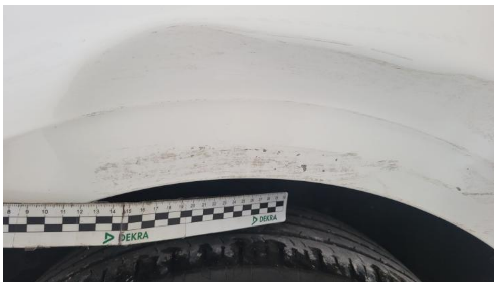
Fot. 77. Błotnik tylny P / Ściana boczna P - Rysa/odprysk 2
