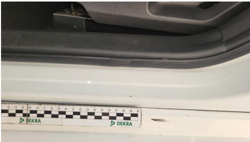
Fot. 103. Próg L - Rysa/odprysk 1
