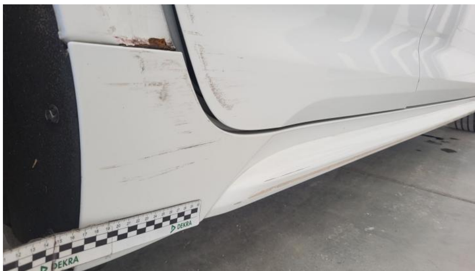
Fot. 73. Próg P - Rysa/odprysk 2
