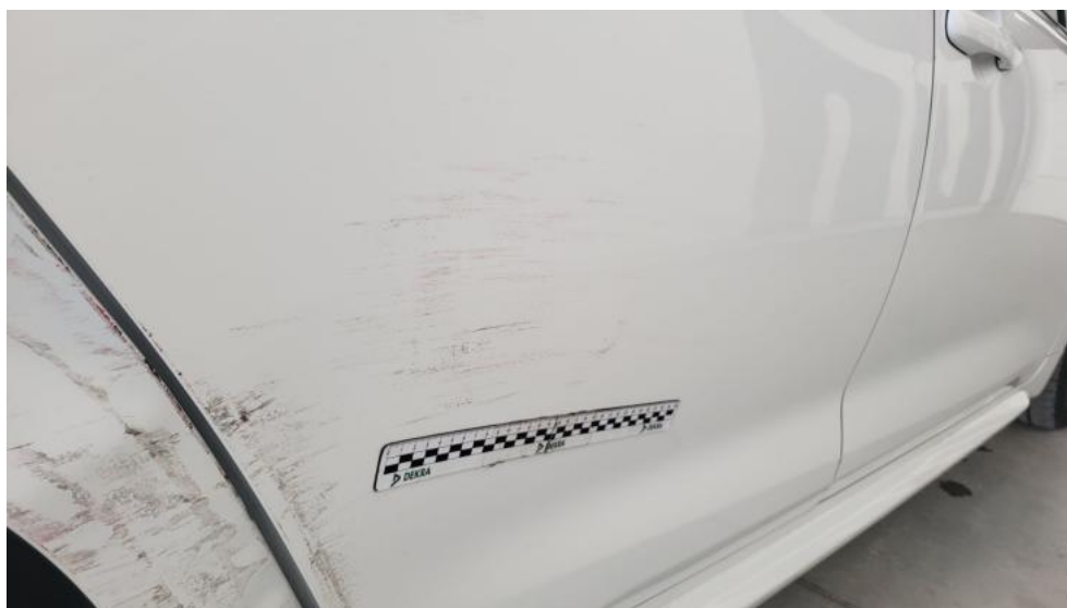
Fot. 64. Drzwi tylne P - Rysa/odprysk 1
