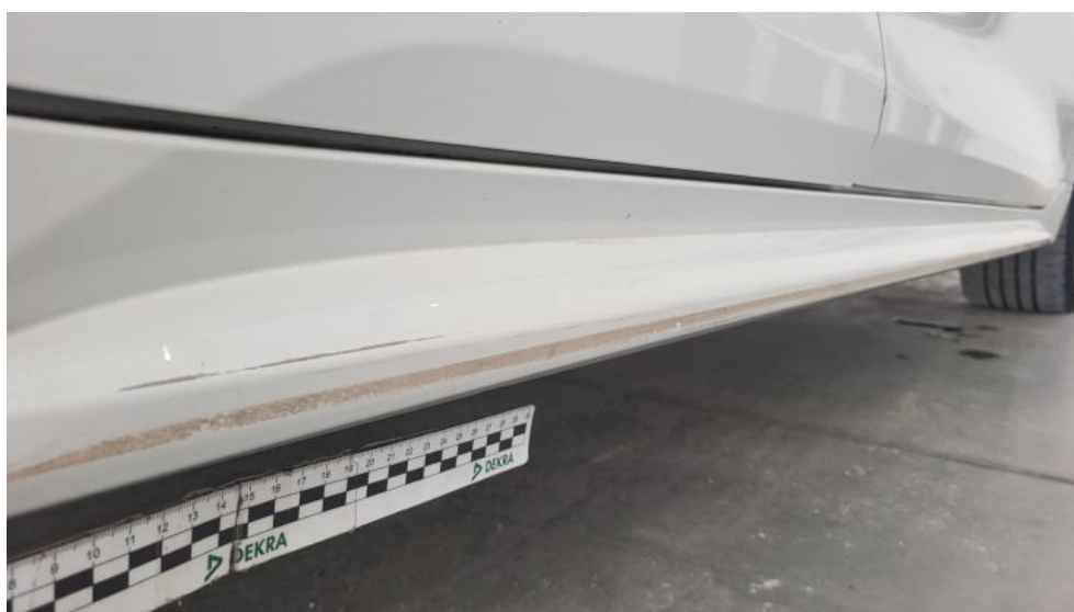
Fot. 74. Próg P() - Rysa/odprysk 3
