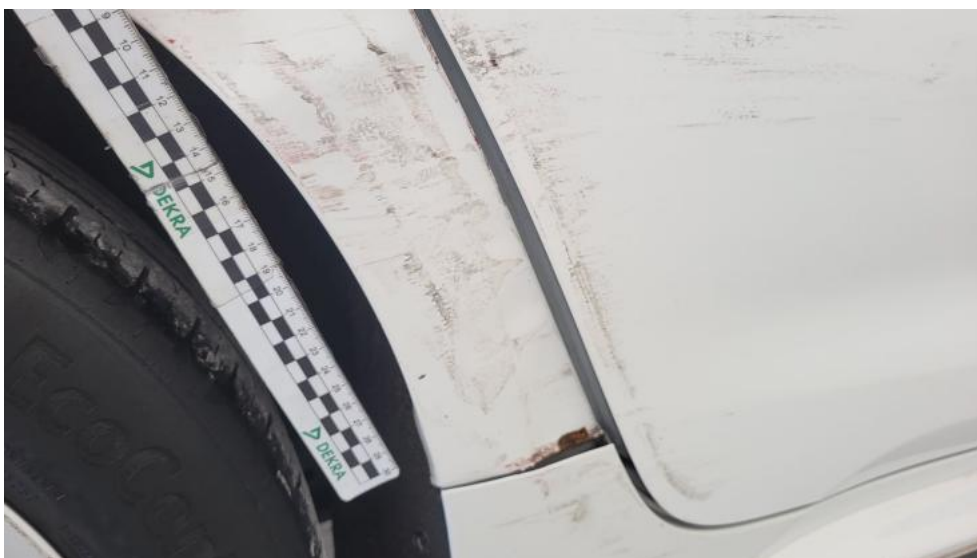
Fot. 76. Błotnik tylny P / Ściana boczna P - Rysa/odprysk 1
