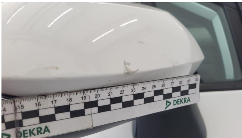
Fot. 69. Lusterko zew P - Rysa/odprysk 1
