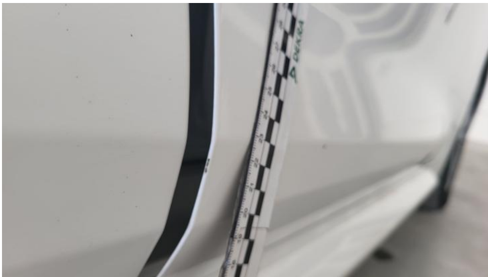
Fot. 59. Drzwi przednie P() - Rysa/odprysk 3
