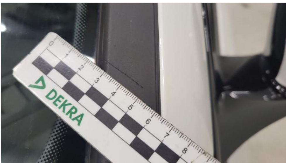
Photo 40. Uszczelka/listwa szyby czołowej - Rysa/odprysk 1
