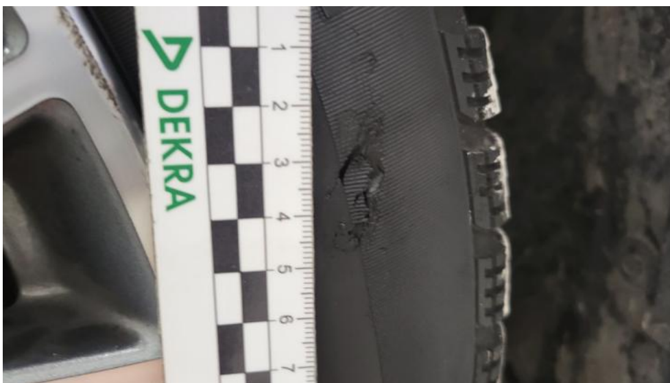
Photo 53. Opona przednia P - Pęknięcie/rozerwanie 1
