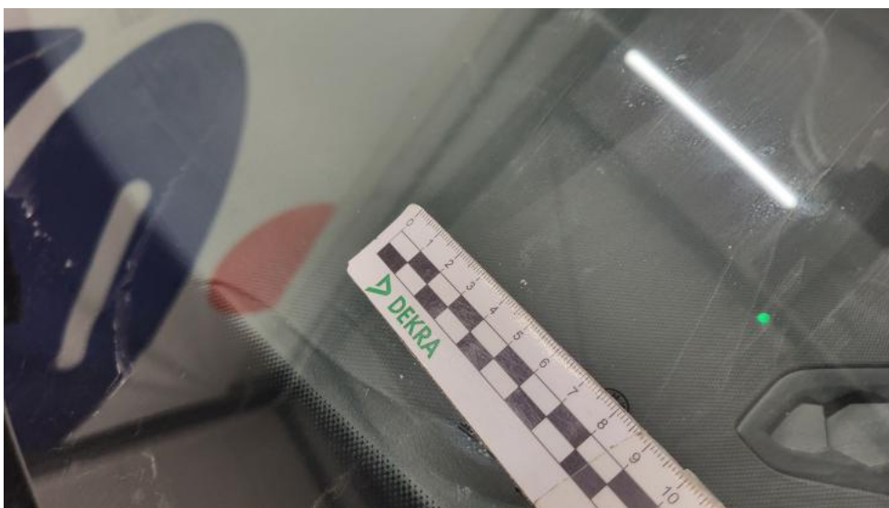
Photo 39. Szyba czołowa - Rysa/odprysk 1
