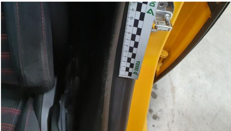
Fot. 37. Wykładzina słupka środkowego lewego (Rysa/Odprysk)
