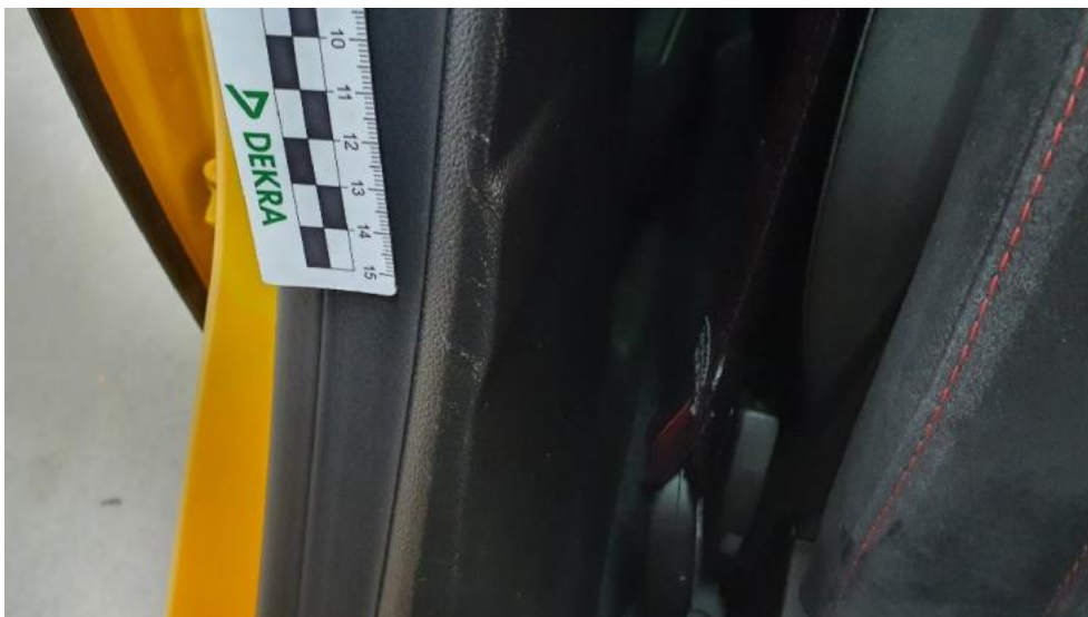
Fot. 40. Wykładzina słupka środkowego prawego (Rysa/Odprysk)
