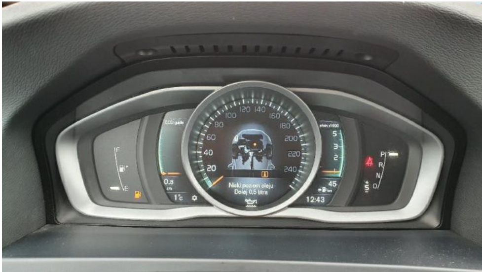
Fot. 29. Poziom oleju
