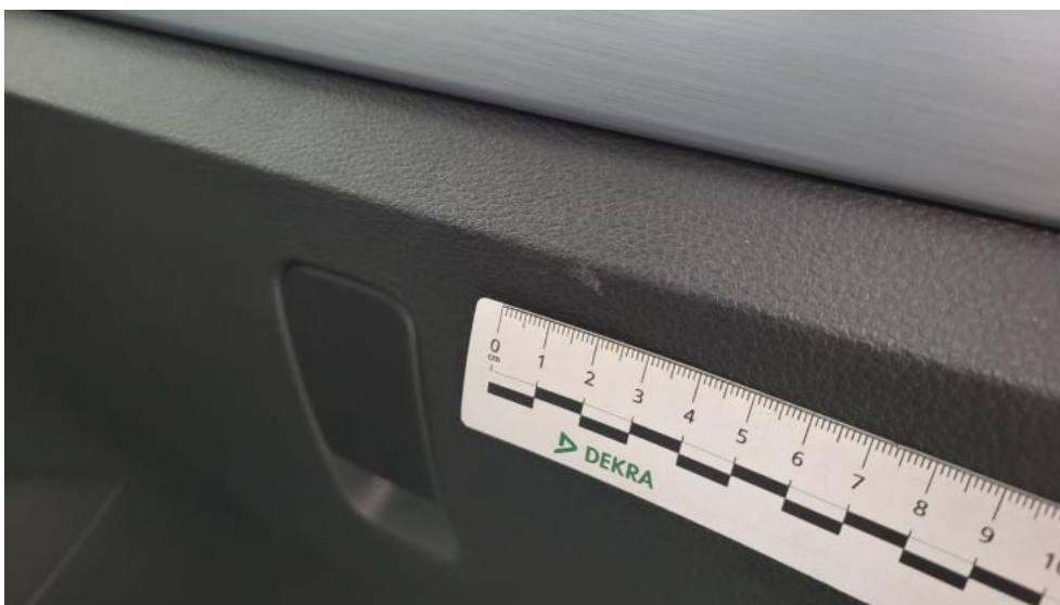
Photo 74. Pokrywa schowka deski rozdź - Rysa/odprysk 1
