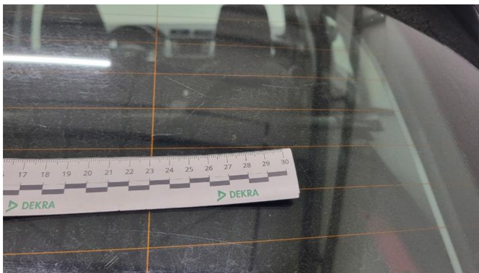
Photo 61. Szyba tylna - Rysa/odprysk 1
