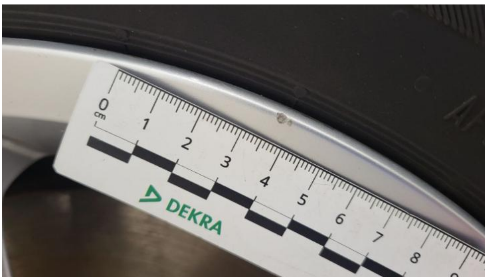
Photo 70. Felga Aluminiowa przednia L - Rysa/odprysk 1
