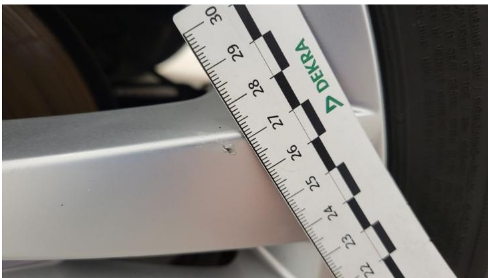
Photo 56. Felga aluminiowa tylna P - Rysa/odprysk 1
