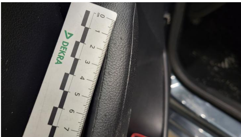
Photo 80. Uchwyt drzwi prze L - Rysa/odprysk 1
