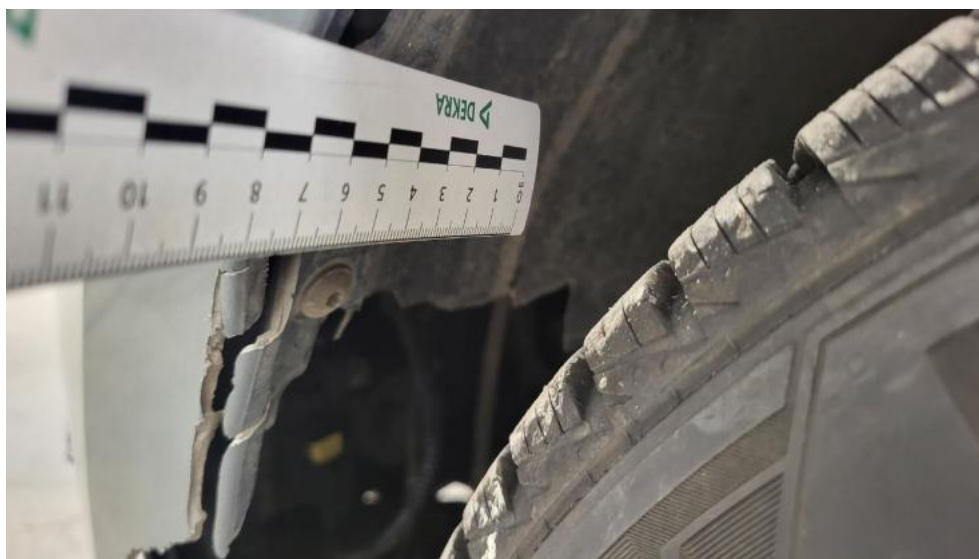
Photo 71. Nadkole przednie L - Pęknięcie/rozerwanie 1
