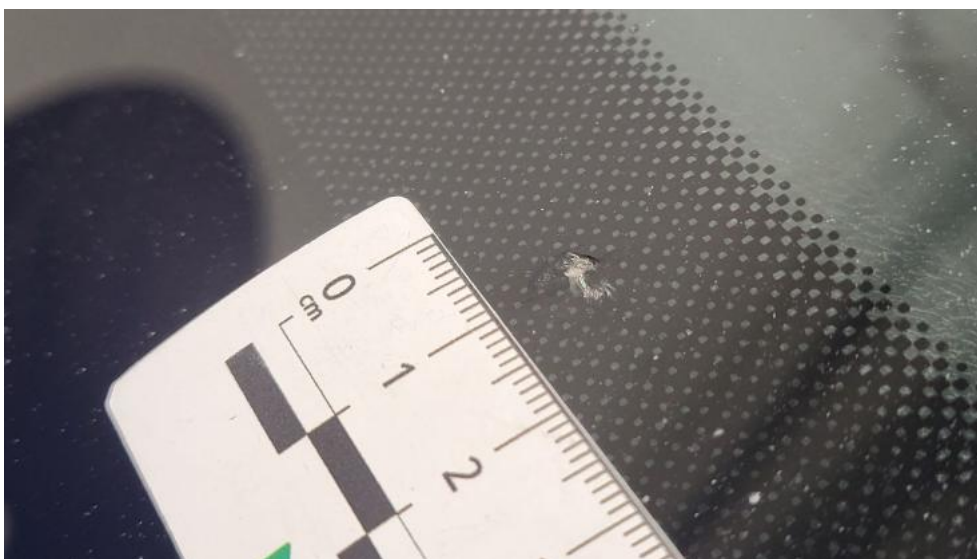
Photo 45. Szyba czołowa - Pęknięcie/rozerwanie 1
