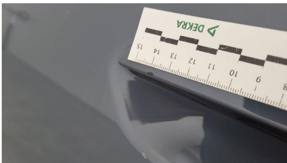
Fot. 54. Klamka drzwi prz L - Rysa/odprysk 1
