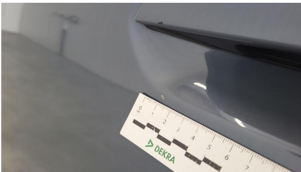
Fot. 50. Drzwi przed L - Rysa/odprysk 2
