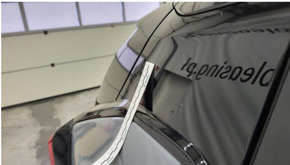
Photo 61. Błotnik tylny P / Ściana boczna P - Wgniecenie/odkształcenie 2
