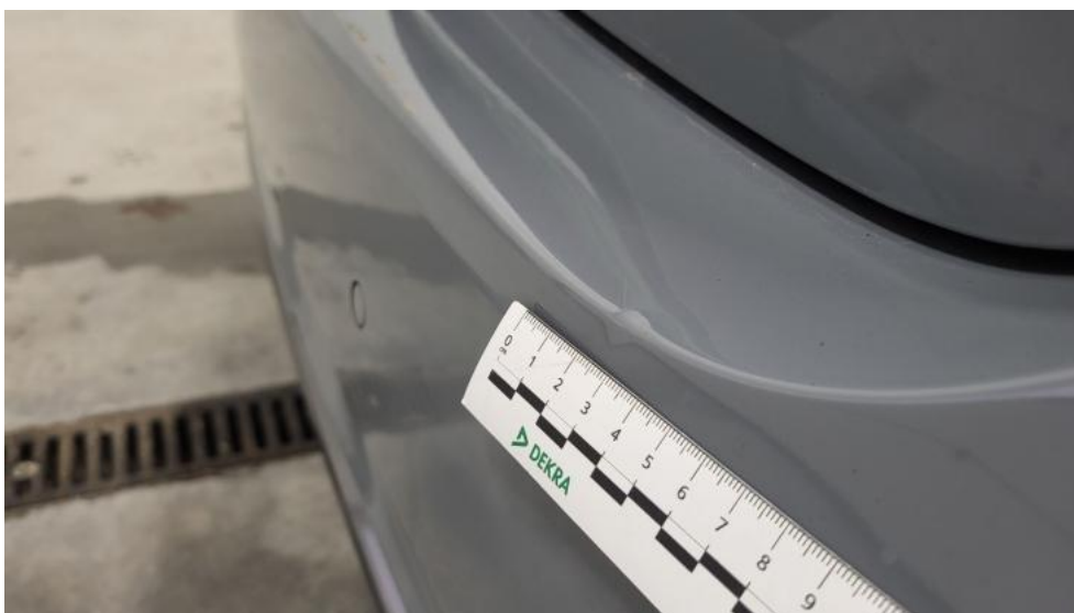
Photo 64. Zderzak tylny - Wgniecenie/odkształcenie 1
