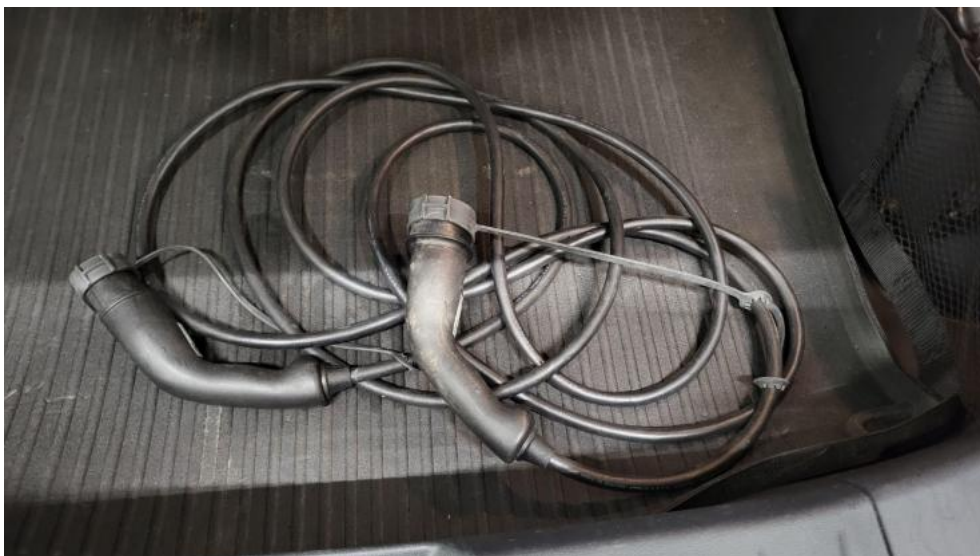
Photo 34. Przewód ładowania baterii trakcyjnej
