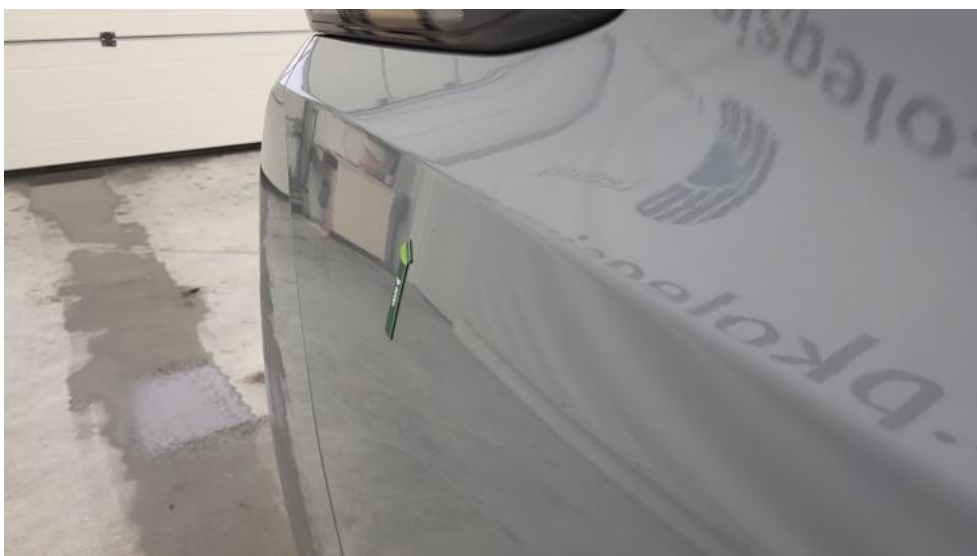
Photo 60. Błotnik tylny P / Ściana boczna P - Wgniecenie/odkształcenie 1
