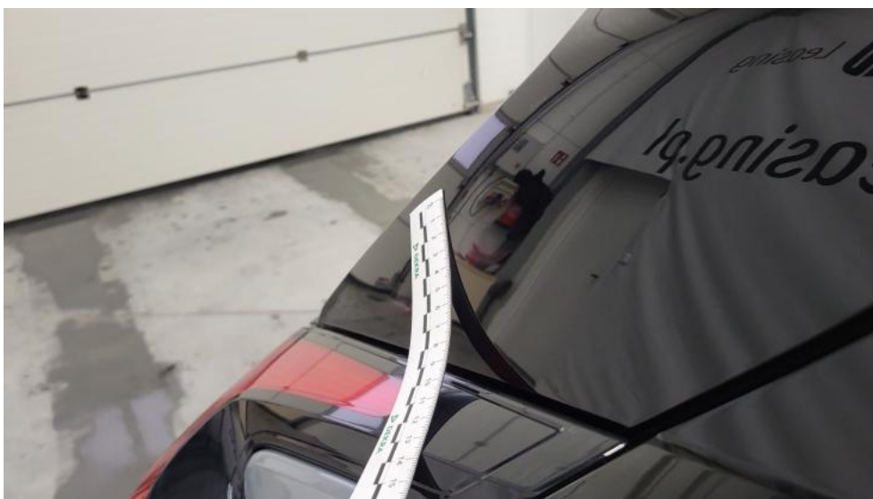
Photo 62. Pokrywy bagażnika - Wgniecenie/odkształcenie 1
