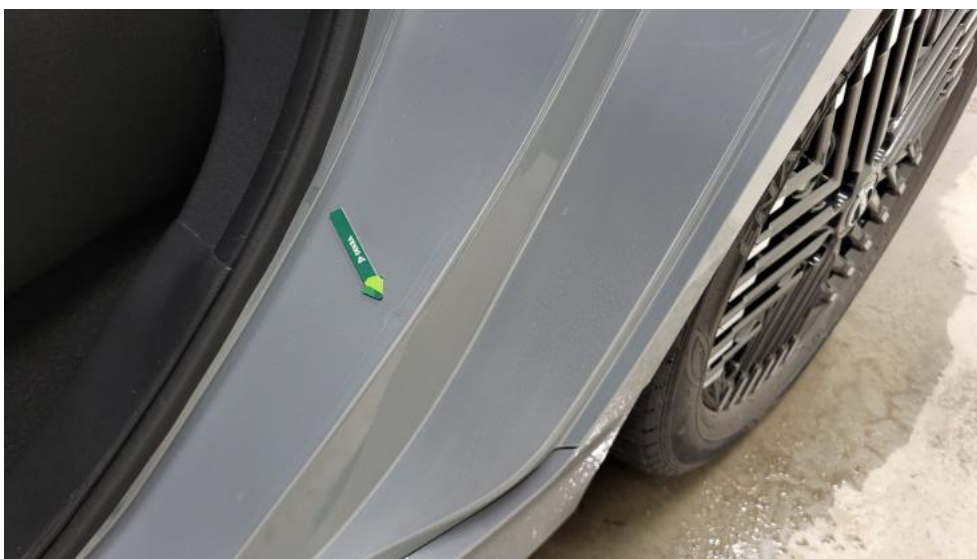
Photo 65. Błotnik tylny L / Ściana boczna L - Wgniecenie/odkształcenie 1
