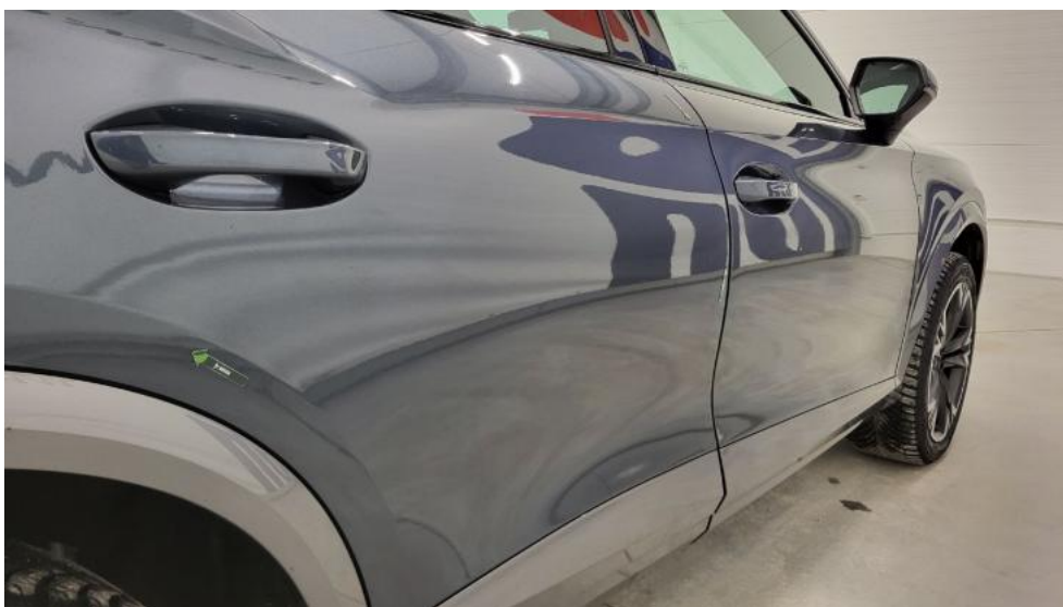
Photo 48. Drzwi tylne P - Wgniecenie/odkształcenie 1
