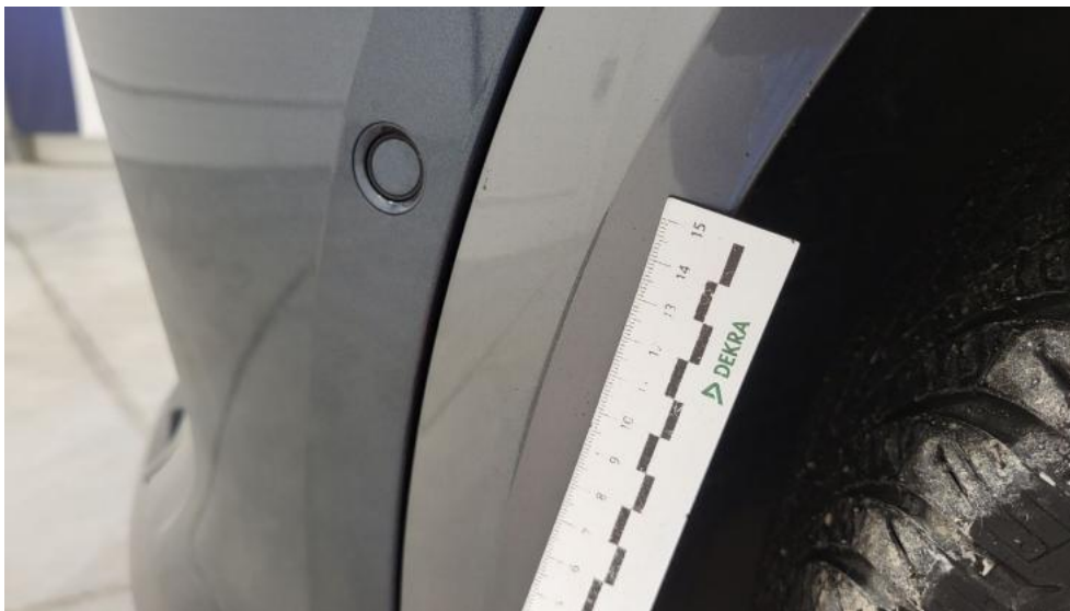
Photo 61. Listwa błotnika przedniego L - Rysa/odprysk 1
