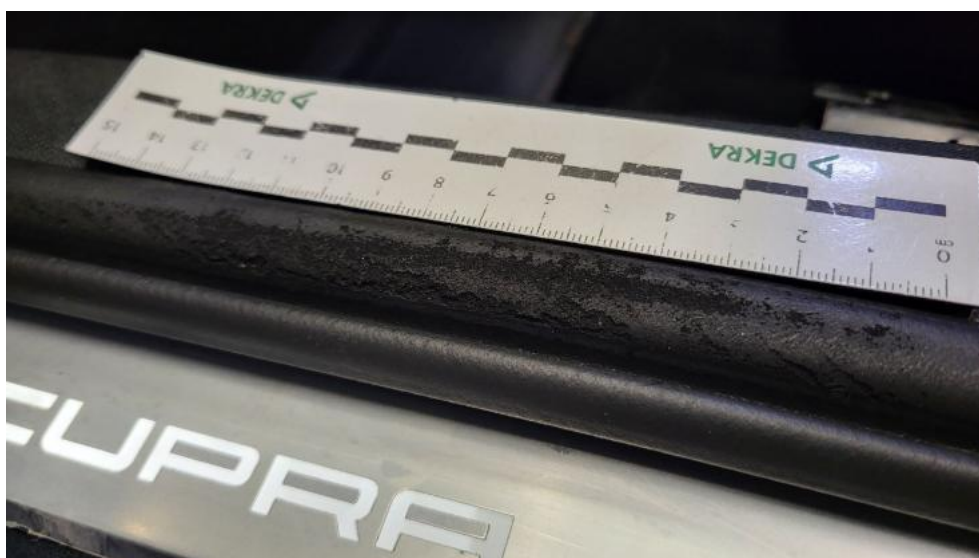
Photo 64. Uszczelka drzwi przednich L - Rysa/odprysk 1
