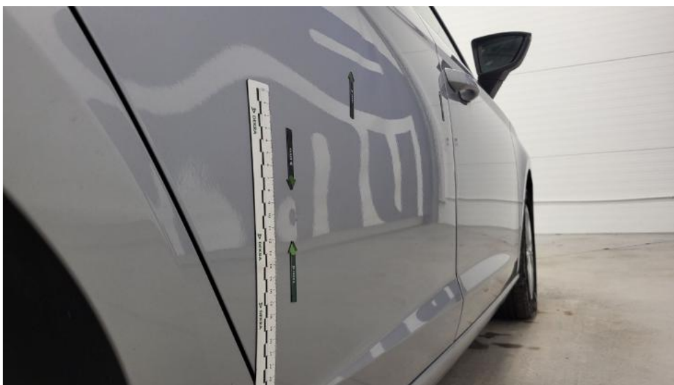
Photo 52. Drzwi tylne P - Wgniecenie/odkształcenie 1
