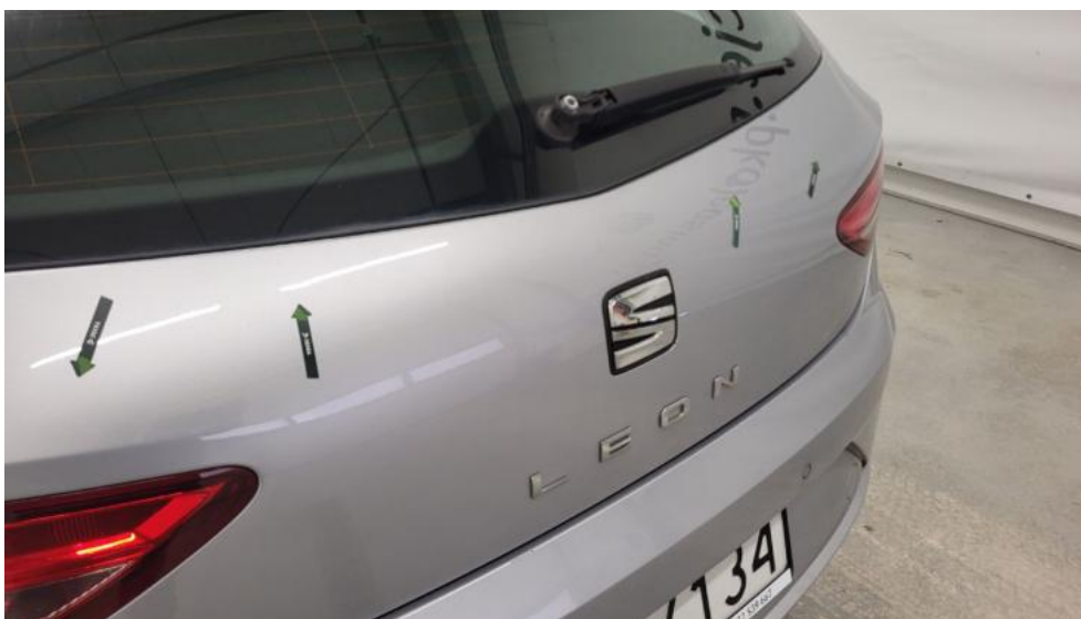
Photo 59. Pokrywy bagażnika - Wgniecenie/odkształcenie 1
