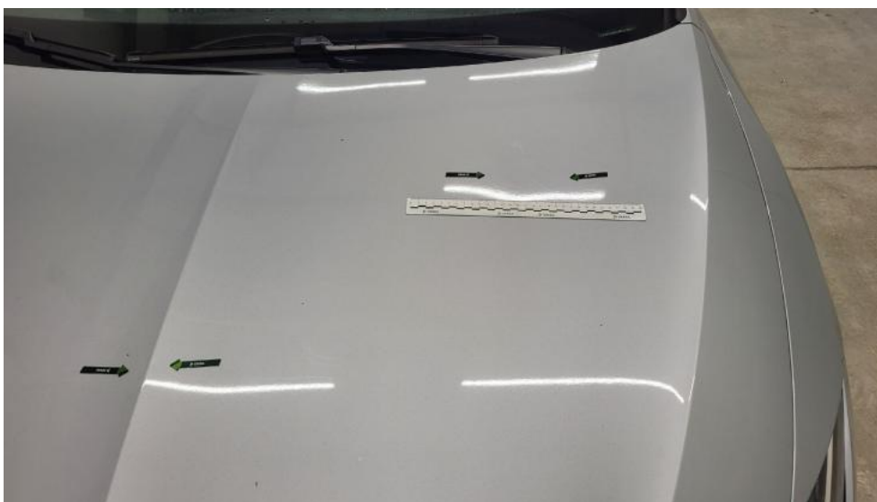
Photo 41. Pokrywa komory silnika - Wgniecenie/odkształcenie 1
