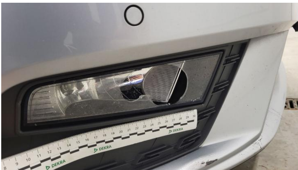
Photo 51. Reflektor przeciwmgielny P - Pęknięcie/rozerwanie 1
