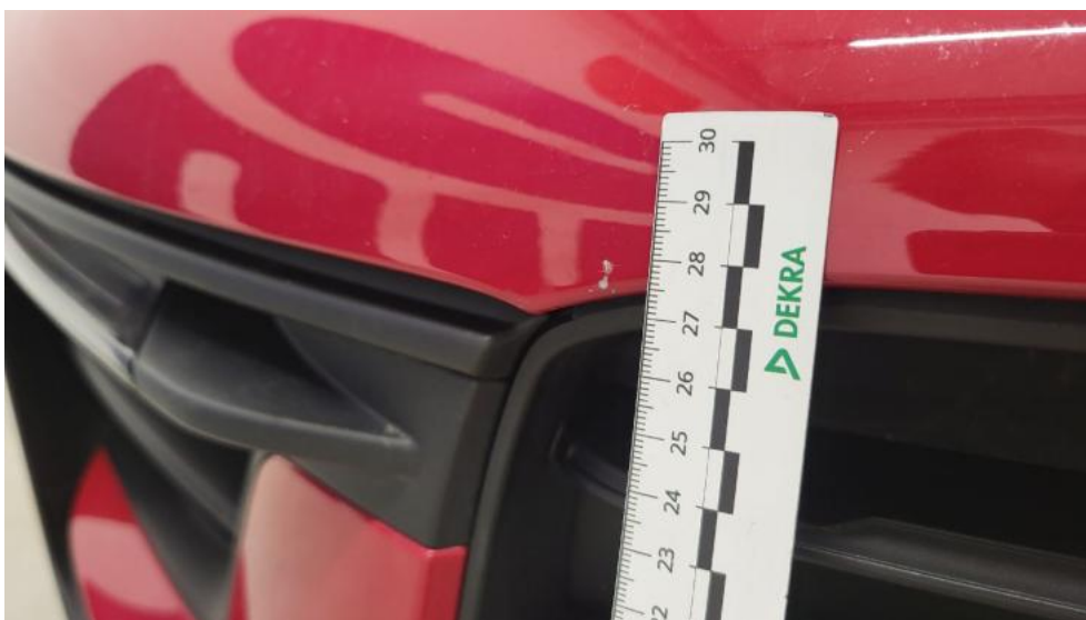
Photo 44. Pokrywa komory silnika - Rysa/odprysk 1
