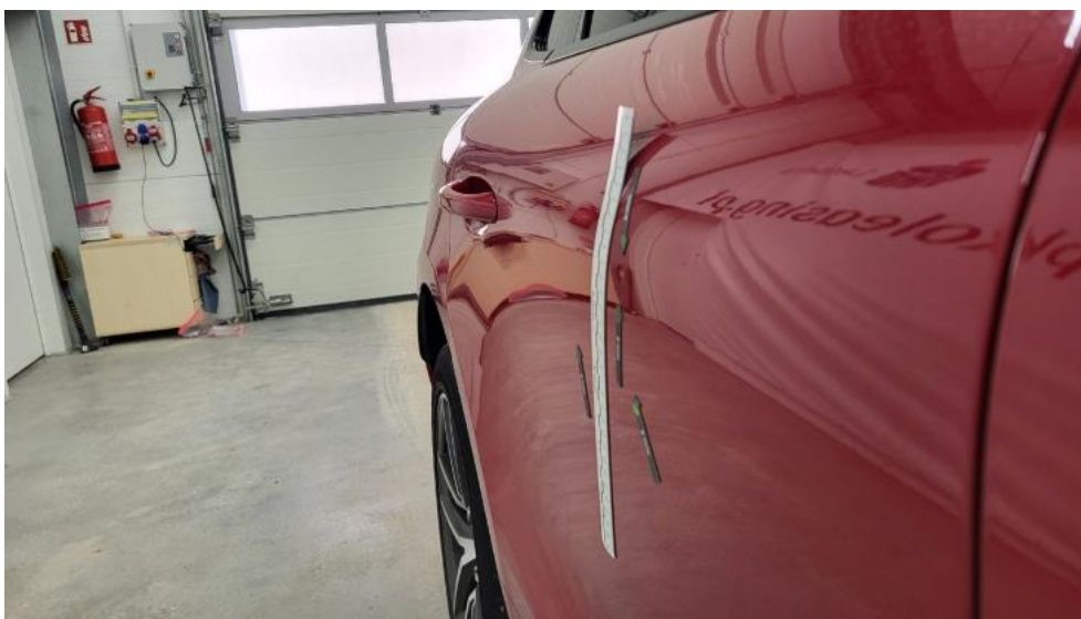
Photo 51. Drzwi tylne P - Wgniecenie/odkształcenie 1
