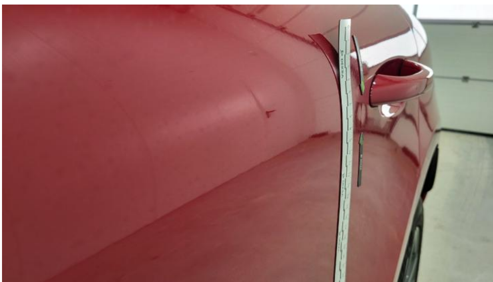
Photo 63. Drzwi tylne L - Wgniecenie/odkształcenie 1
