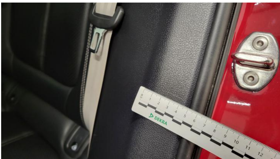
Photo 68. Wykładzina(y) słupka tylnego L - Rysa/odprysk 1
