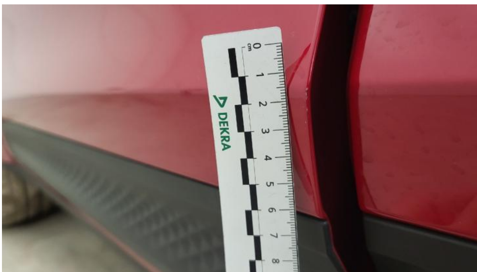
Photo 60. Drzwi przed L - Rysa/odprysk 1
