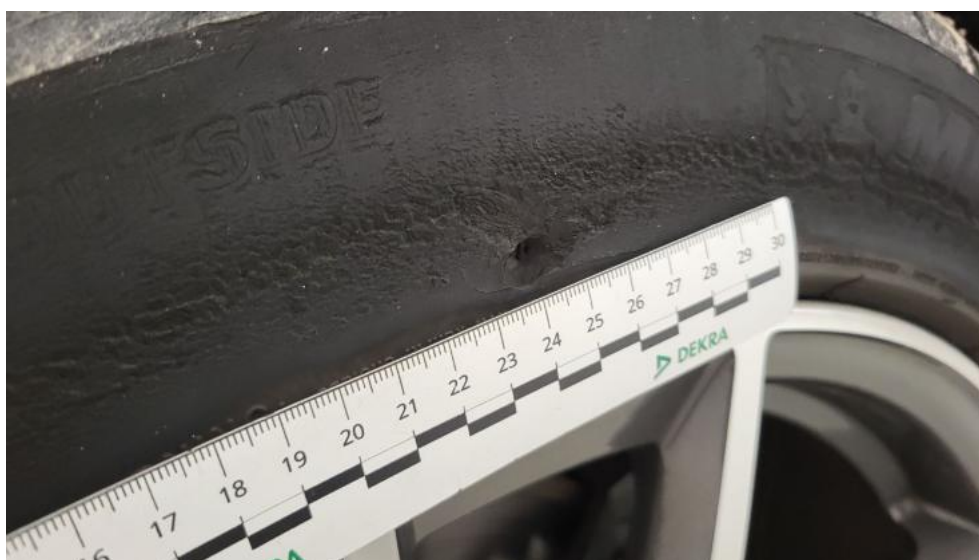
Photo 54. Opona tylna P - Pęknięcie/rozerwanie 1
