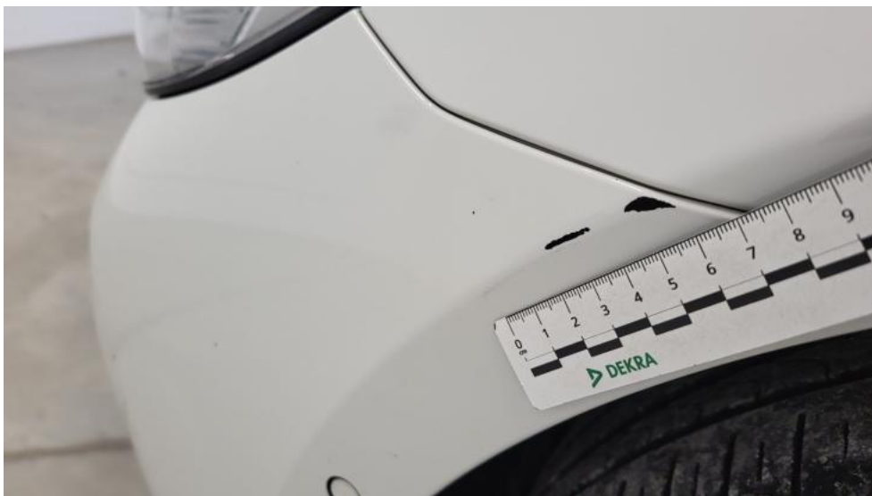
Fot. 45. Zderzak - Rysa/odprysk 1
