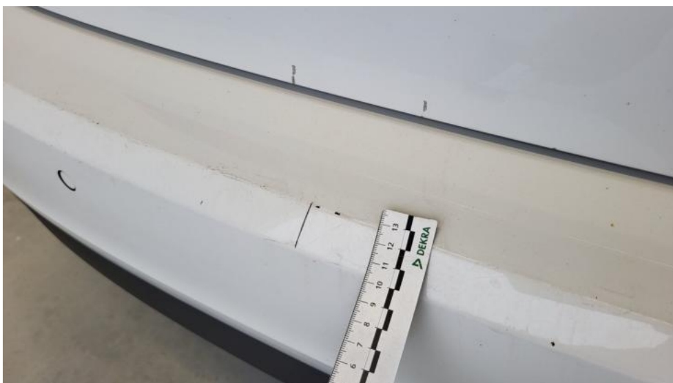
Fot. 58. Zderzak tylny - Rysa/odprysk 2
