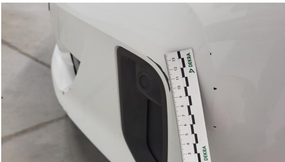
Fot. 46. Zderzak - Rysa/odprysk 2
