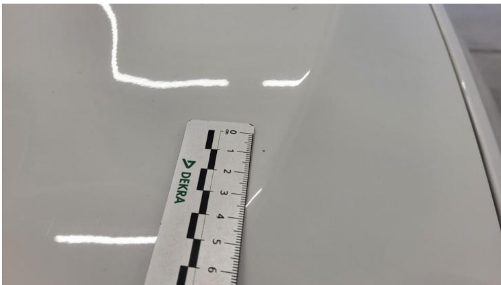
Fot. 43. Pokrywa komory silnika - Rysa/odprysk 1
