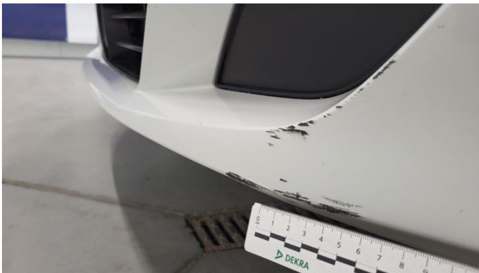
Fot. 47. Zderzak() - Rysa/odprysk 3
