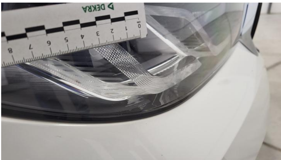
Fot. 48. Reflektor P - Rysa/odprysk 1
