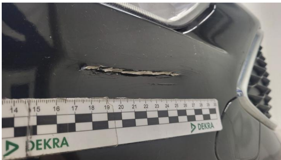
Fot. 41. Zderzak - Pęknięcie/rozerwanie 1
