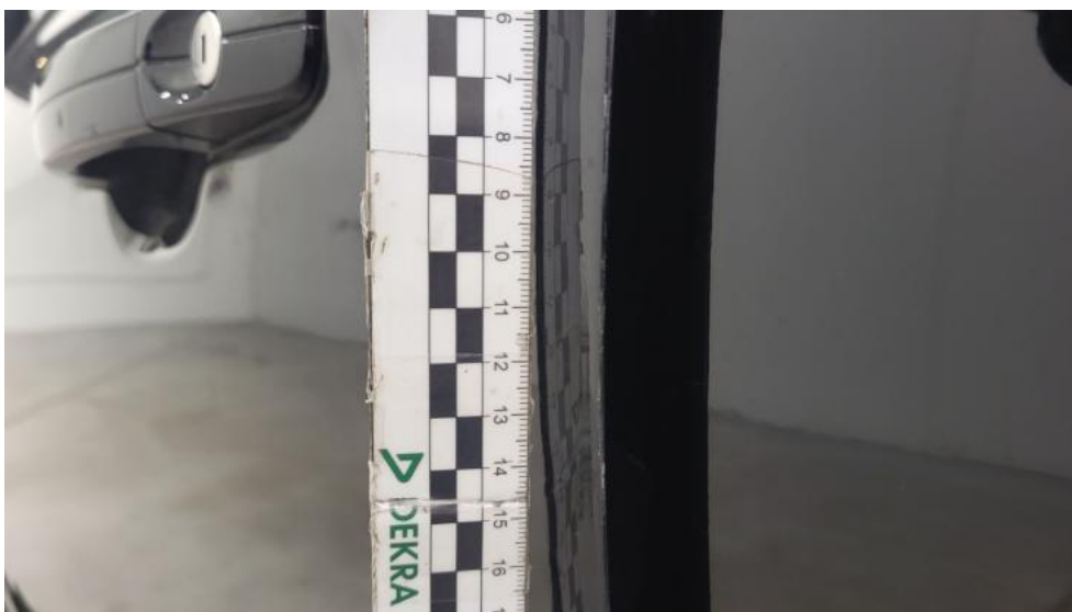
Fot. 56. Drzwi przed L - Rysa/odprysk 2
