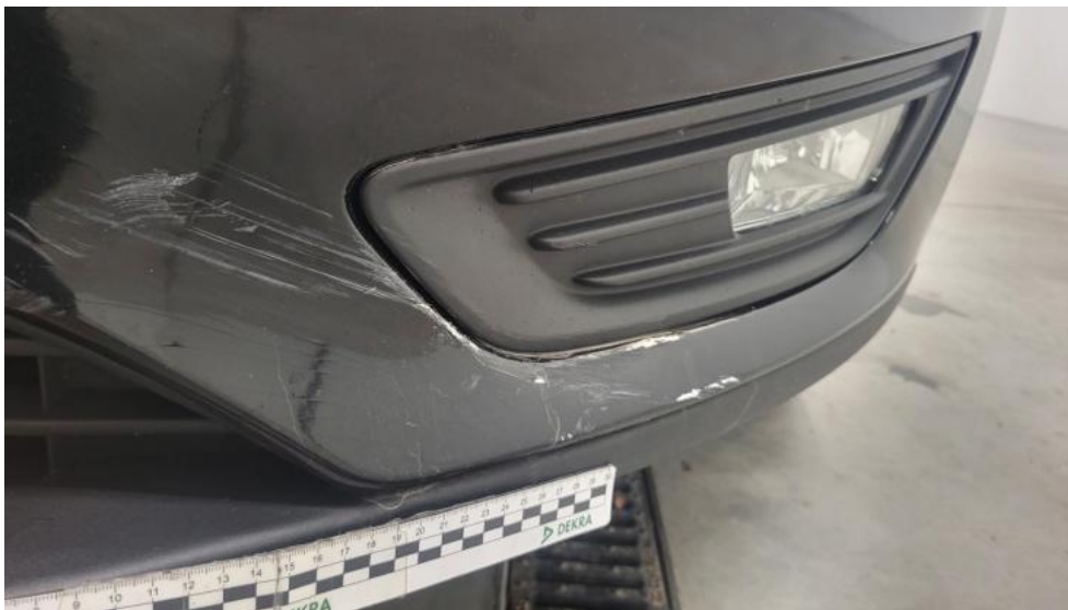
Fot. 39. Zderzak - Rysa/odprysk 1
