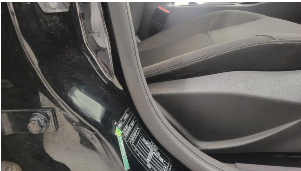
Fot. 49. Słupek środkowy P - Wgniecenie/odkształcenie 1
