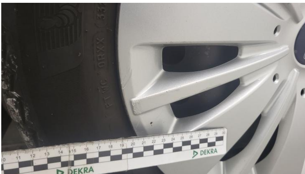
Fot. 60. Kołpak przedni L - Rysa/odprysk 1
