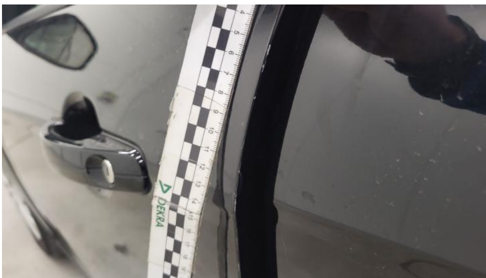
Fot. 55. Drzwi przed L - Rysa/odprysk 1
