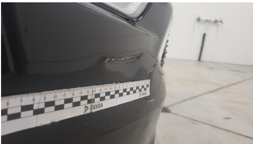
Fot. 40. Zderzak - Wgniecenie/odkształcenie 1
