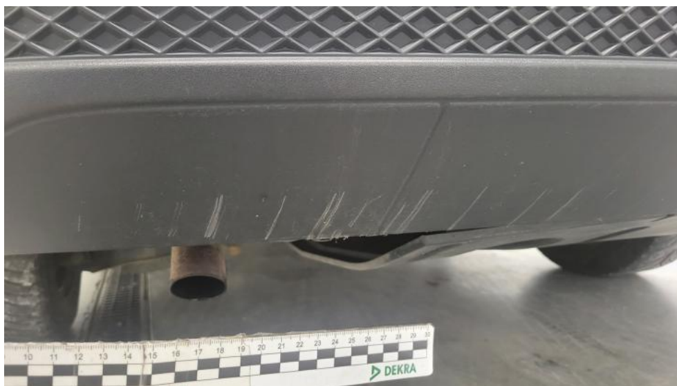
Fot. 51. Zderzak tylny - Rysa/odprysk 1
