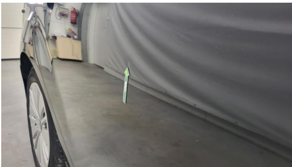
Fot. 47. Drzwi tylne P - Wgniecenie/odkształcenie 1
