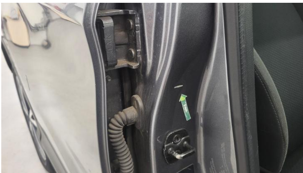
Photo 65. Stupek środkowy P - Wgniecenie/odkształcenie 1
