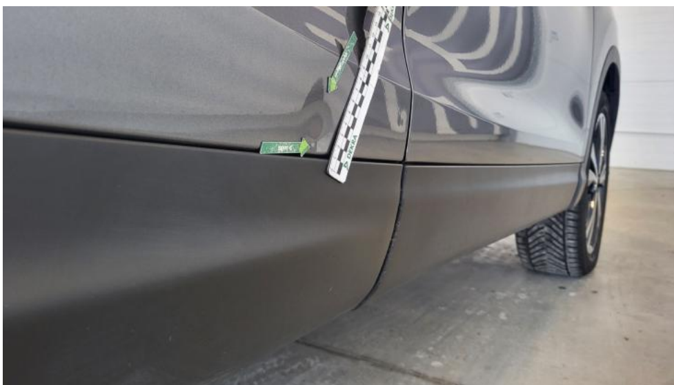
Photo 57. Drzwi tylne P - Wgniecenie/odkształcenie 2
