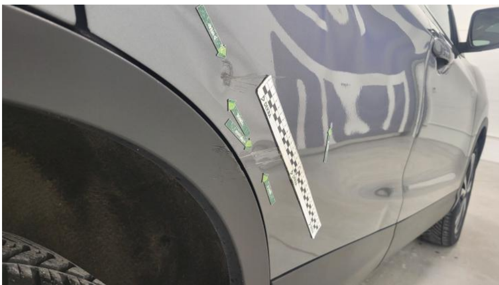
Photo 58. Drzwi tylne P() - Wgniecenie/odkształcenie 3
