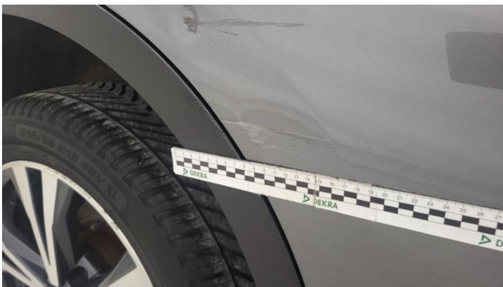
Photo 53. Drzwi tylne P - Rysa/odprysk 1
