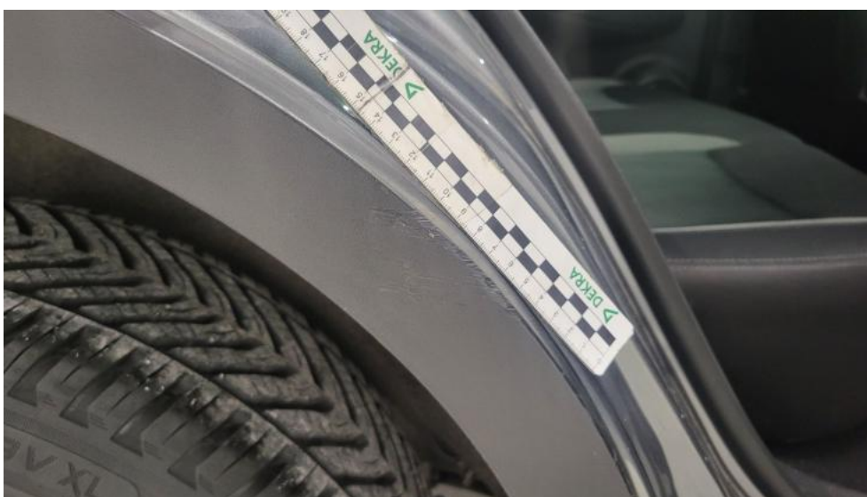
Photo 70. Listwa krawędzi błotnika tył P - Rysa/odprysk 1
