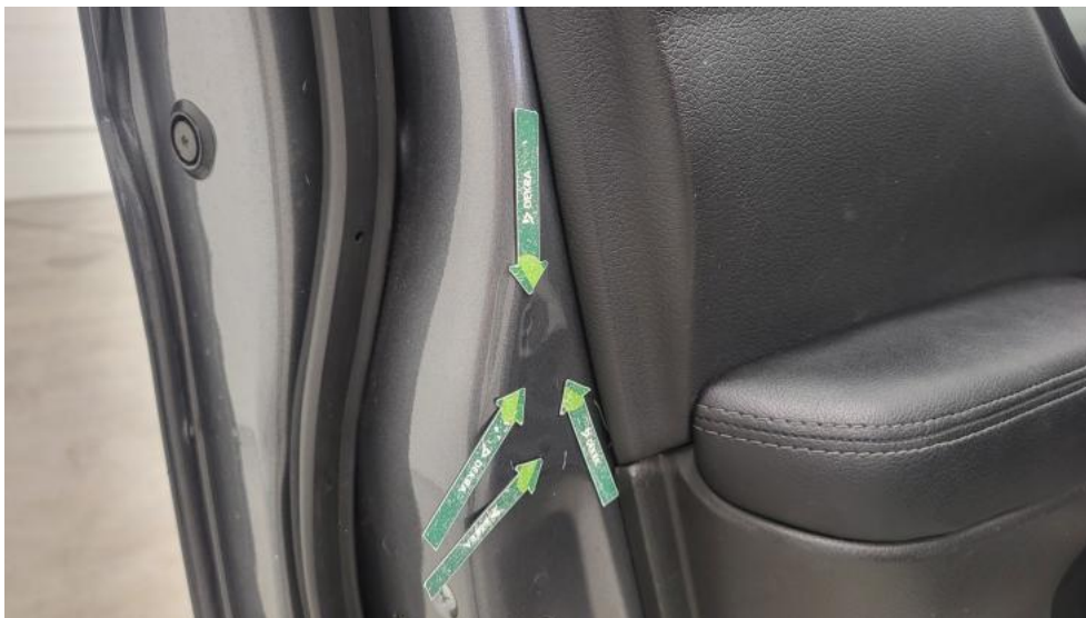
Photo 89. Drzwi przed L - Wgniecenie/odkształcenie 1
