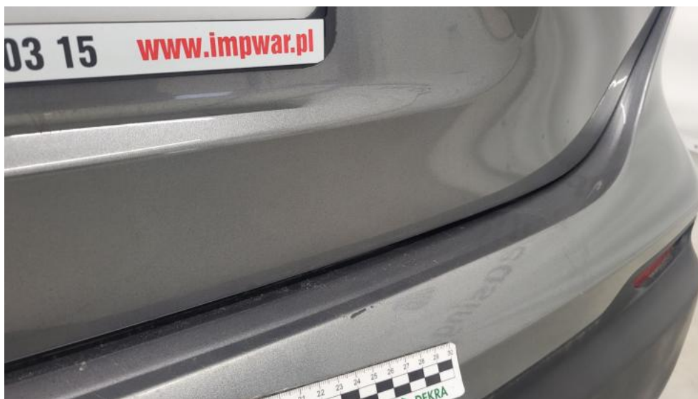
Photo 79. Zderzak tylny() - Rysa/odprysk 3
