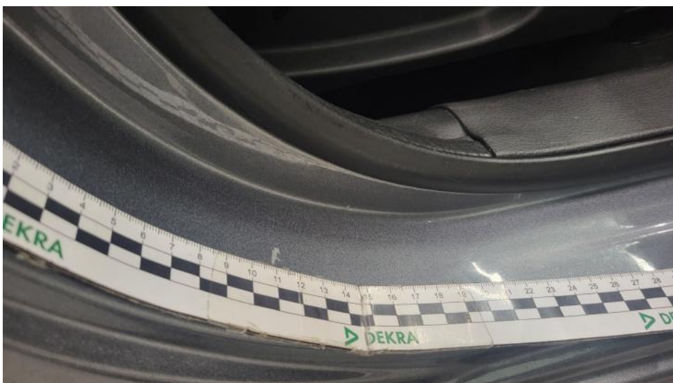
Photo 62. Próg P - Rysa/odprysk 2
