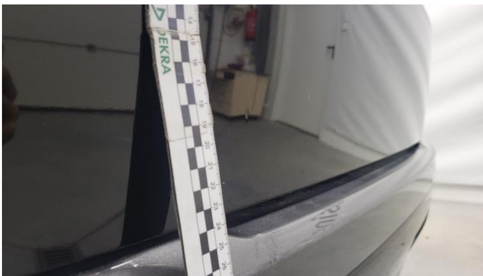
Fot. 51. Pokrywy bagażnika() - Wgniecenie/odkształcenie 3
