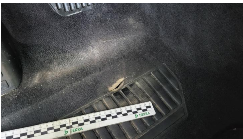
Fot. 70. Wykładzina podłogi - Pęknięcie/rozerwanie 1
