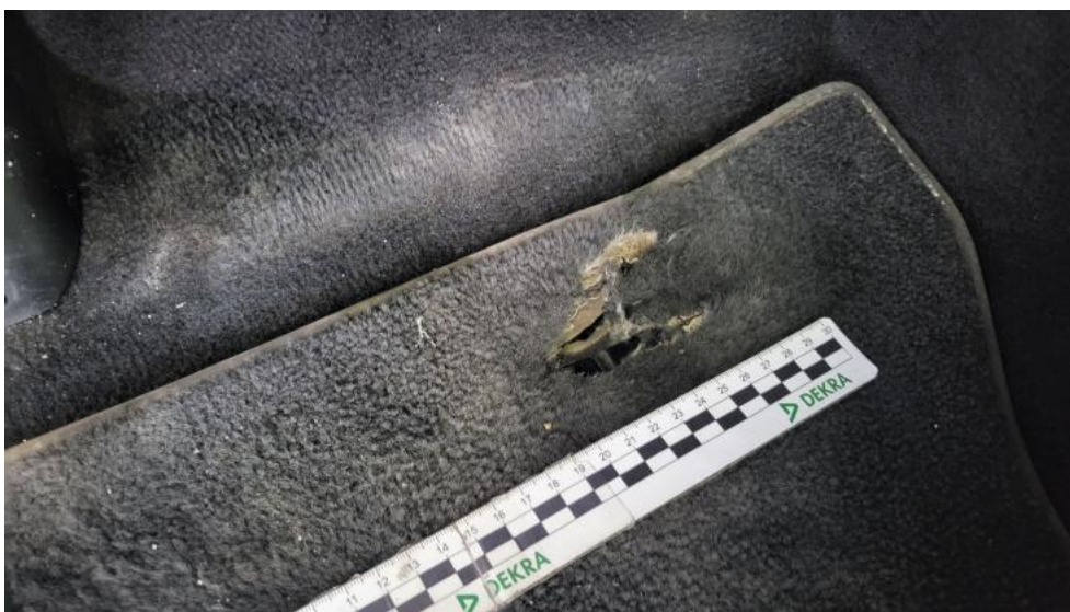
Fot. 69. Dywanik prze L - Pęknięcie/rozerwanie 1
