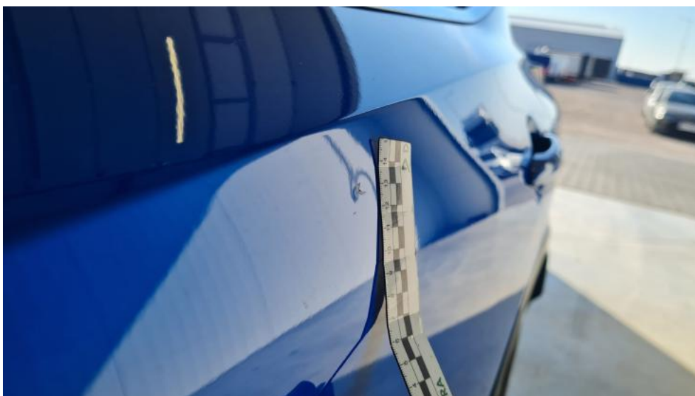
Photo 40. Drzwi tylne L - Wgniecenie/odkształcenie 1
