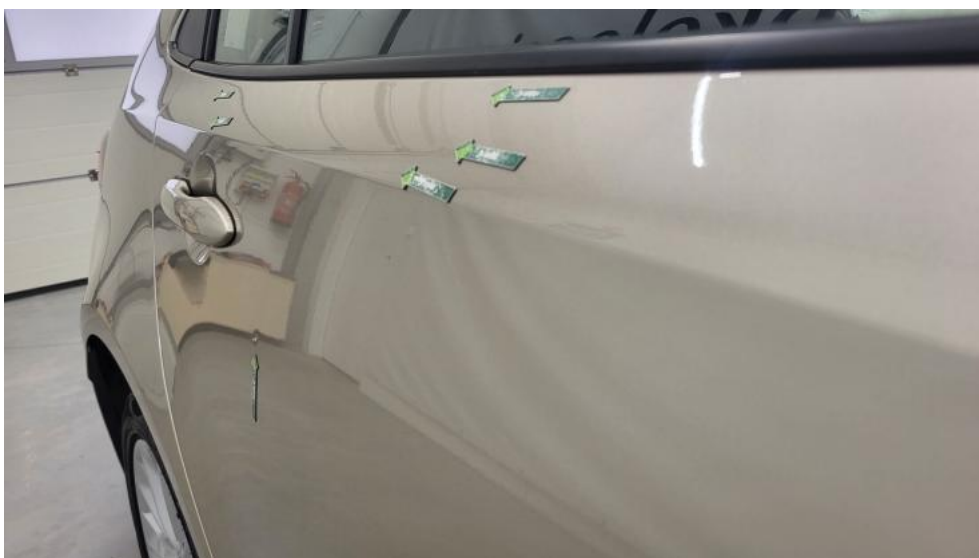
Photo 52. Drzwi tylne P - Wgniecenie/odkształcenie 2
