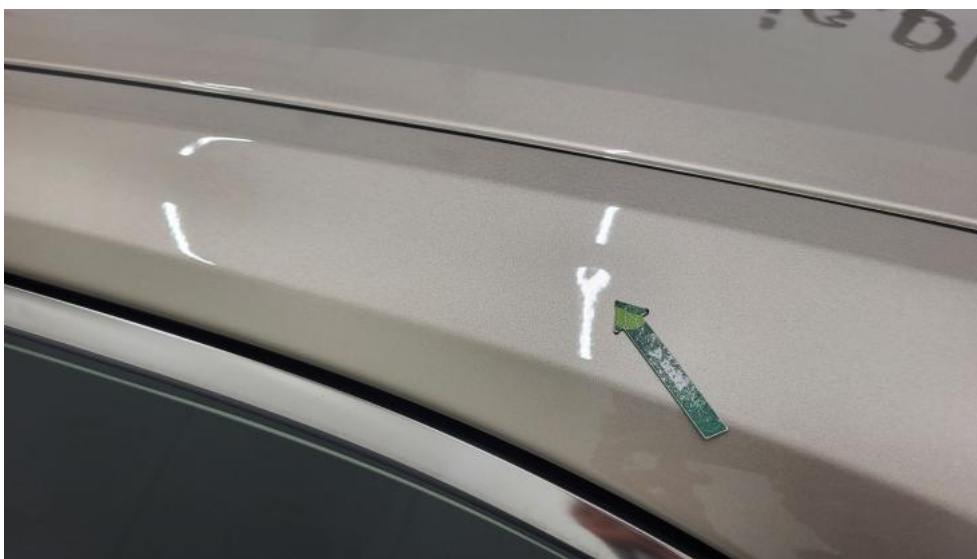
Photo 73. Błotnik tylny L / Ściana boczna L - Wgniecenie/odkształcenie 2
