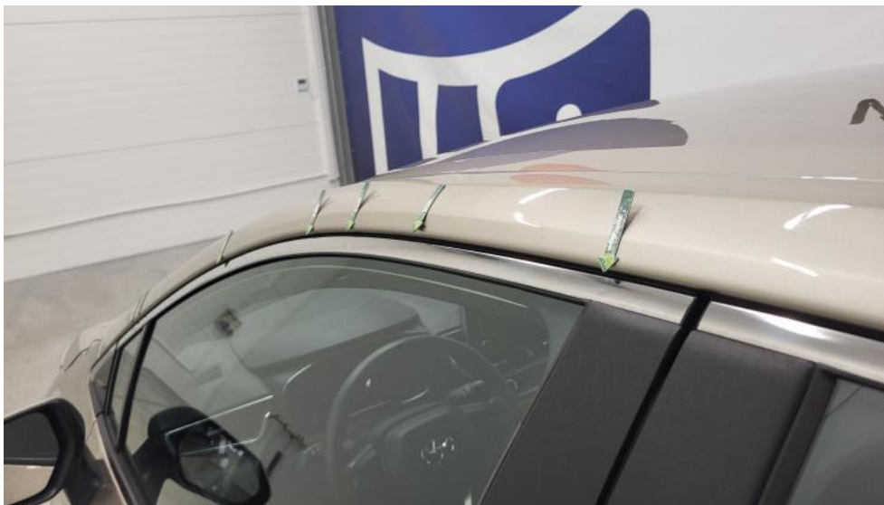
Photo 77. Drzwi przed L - Wgniecenie/odkształcenie 2
