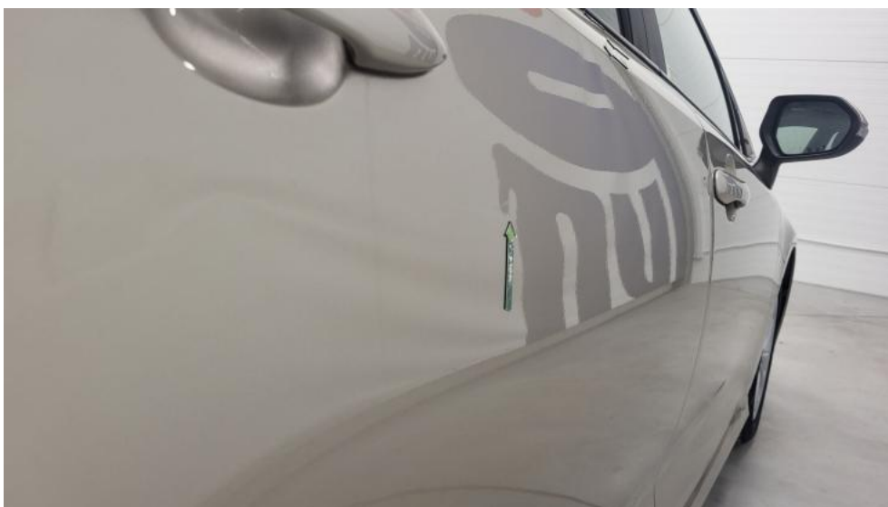
Photo 51. Drzwi tylne P - Wgniecenie/odkształcenie 1
