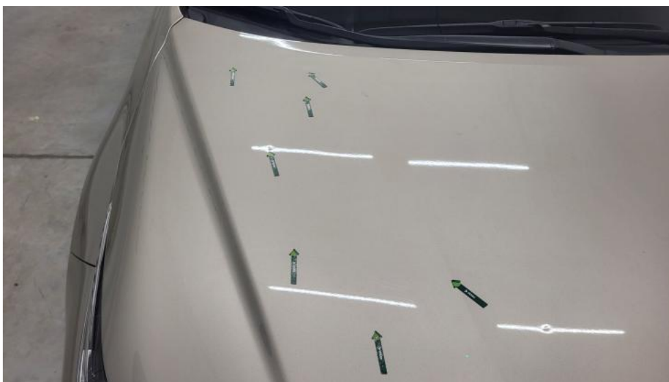
Photo 41. Pokrywa komory silnika() - Wgniecenie/odkształcenie 3
