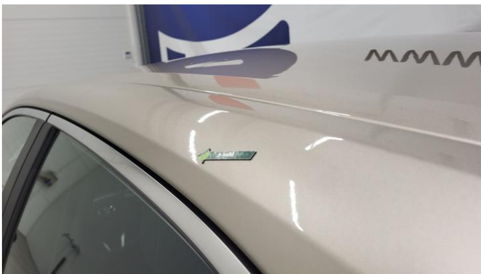
Photo 74. Błotnik tylny L / Ściana boczna L() - Wgniecenie/odkształcenie 3
