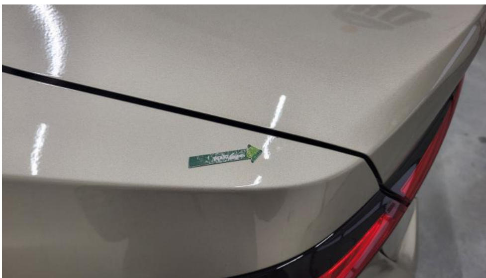
Photo 72. Błotnik tylny L / Ściana boczna L - Wgniecenie/odkształcenie 1
