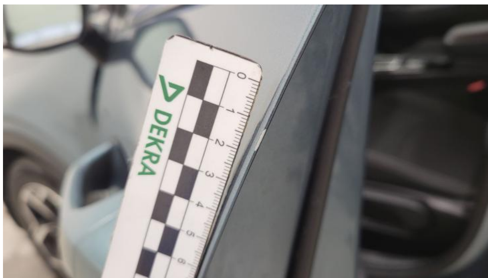
Photo 62. Drzwi przed L - Rysa/odprysk 1
