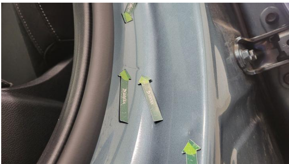
Photo 70. Słupek środkowy L - Wgniecenie/odkształcenie 2
