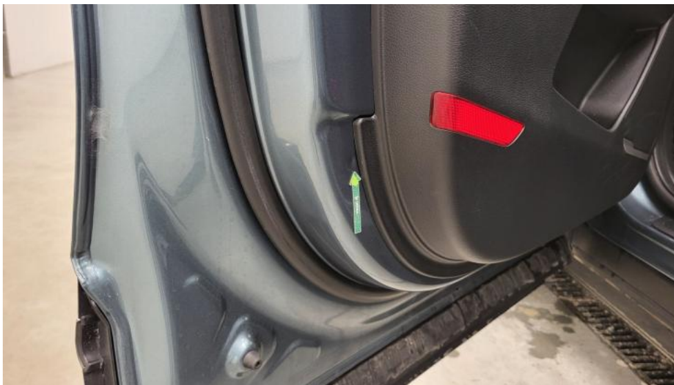
Photo 65. Drzwi przed L - Wgniecenie/odkształcenie 1
