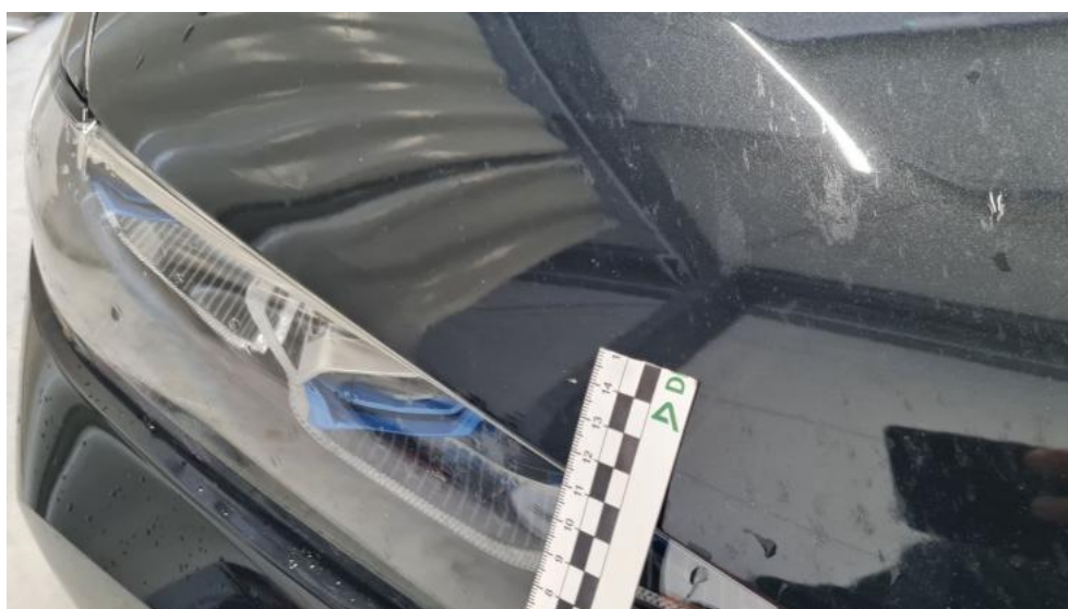
Photo 42. Pokrywa komory silnika - Rysa/odprysk 1
