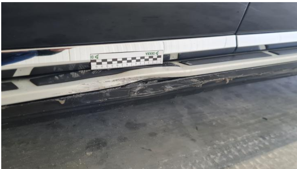
Photo 53. Próg L - Wgniecenie/odkształcenie 1
