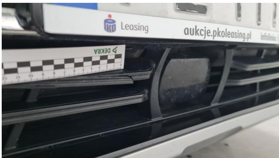
Photo 41. Kratka zderzaka prz. - Pęknięcie/rozerwanie 1
