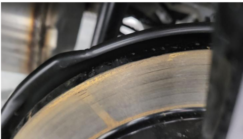
Fot. 16. Tarcza hamulcowa tylna prawa
