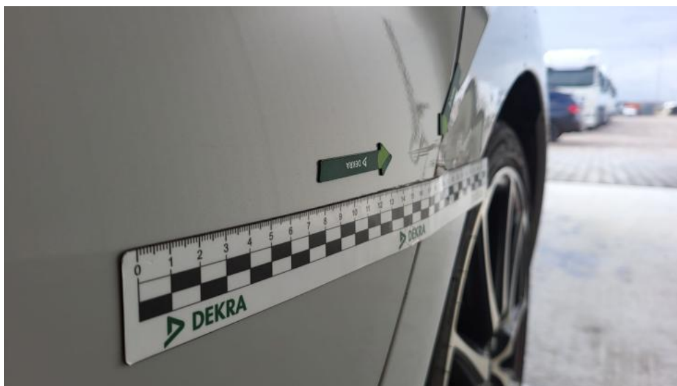
Fot. 49. Drzwi tylne L - Wgniecenie/odkształcenie 1
