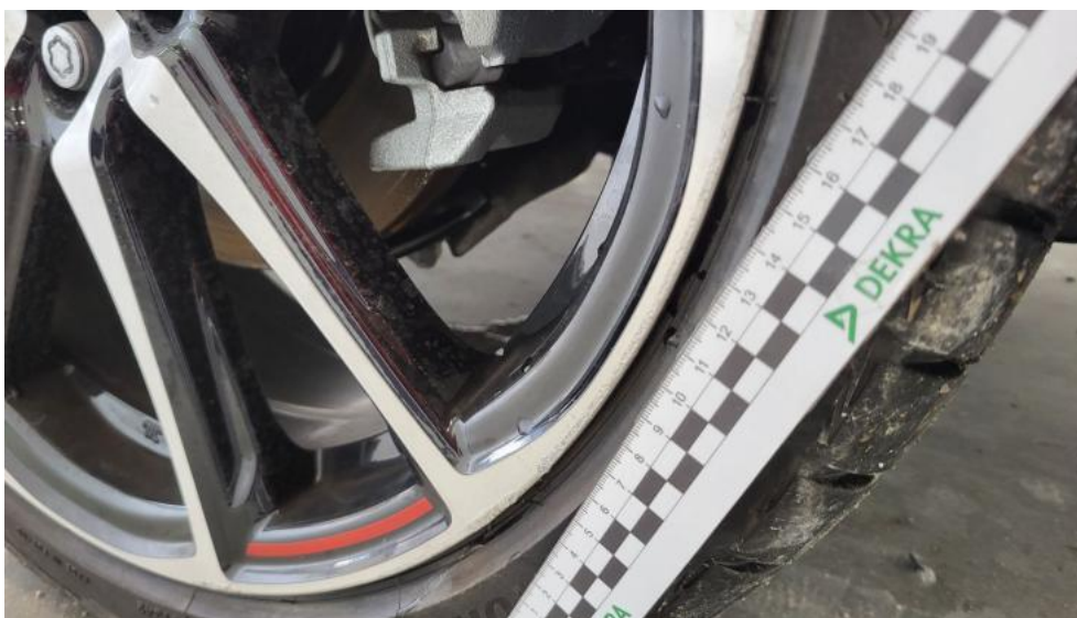
Fot. 43. Felga aluminiowa przednia P - Rysa/odprysk 1
