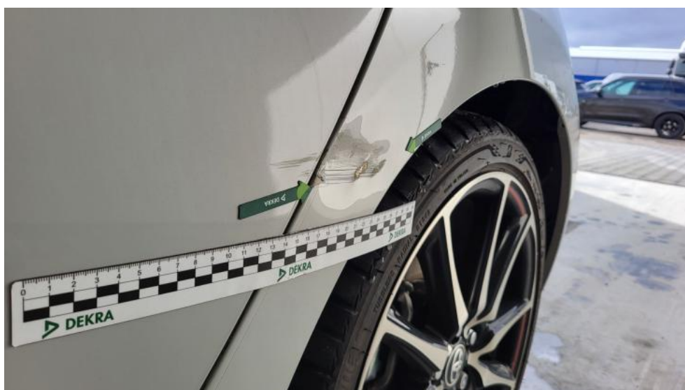
Fot. 46. Błotnik tylny L / Ściana boczna L - Wgniecenie/odkształcenie 1
