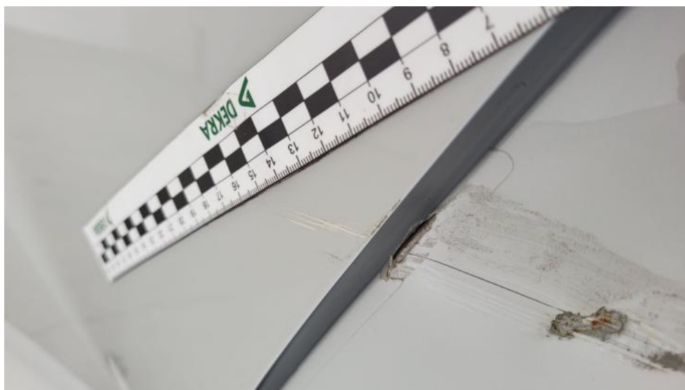
Fot. 48. Drzwi tylne L - Rysa/odprysk 1
