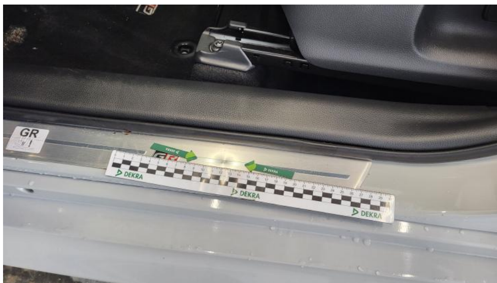
Fot. 50. Próg L - Wgniecenie/odkształcenie 1
