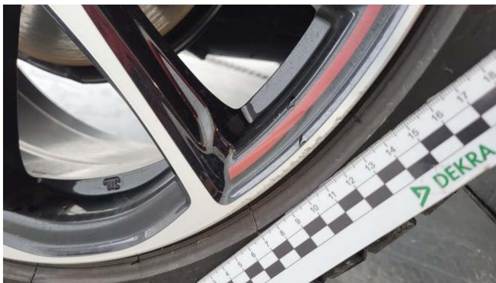
Fot. 45. Felga aluminiowa tylna P - Rysa/odprysk 1
