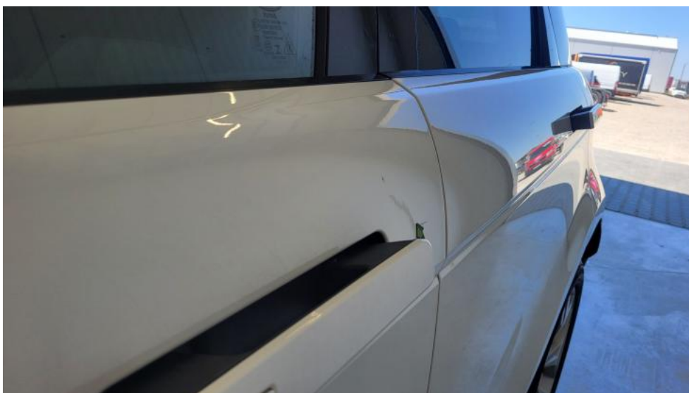
Photo 54. Drzwi przed L - Wgniecenie/odkształcenie 2
