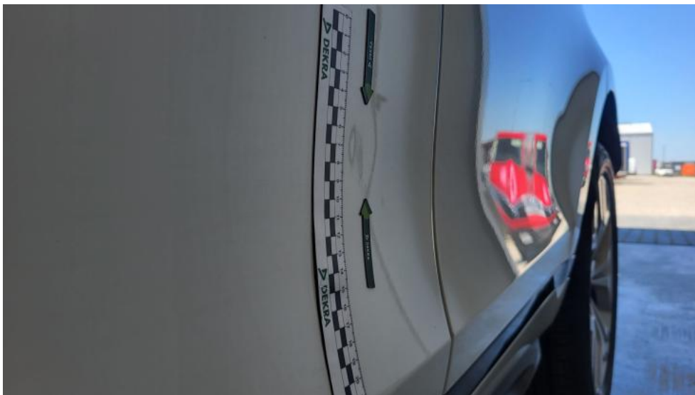
Photo 53. Drzwi przed L - Wgniecenie/odkształcenie 1
