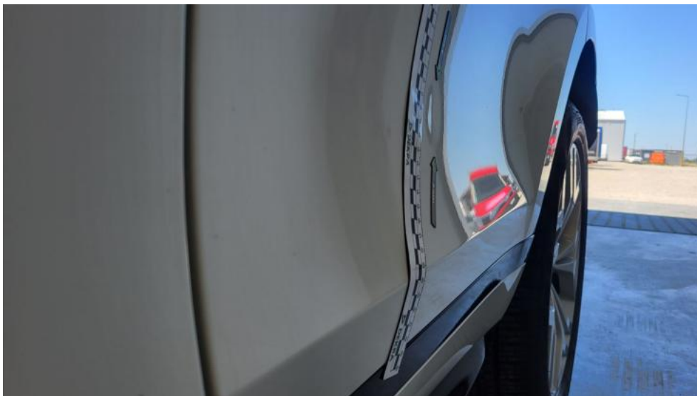
Photo 55. Drzwi tylne L - Wgniecenie/odkształcenie 1
