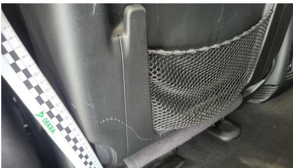
Fot. 72. Fotel prz. lew. - Rysa/odprysk 1
