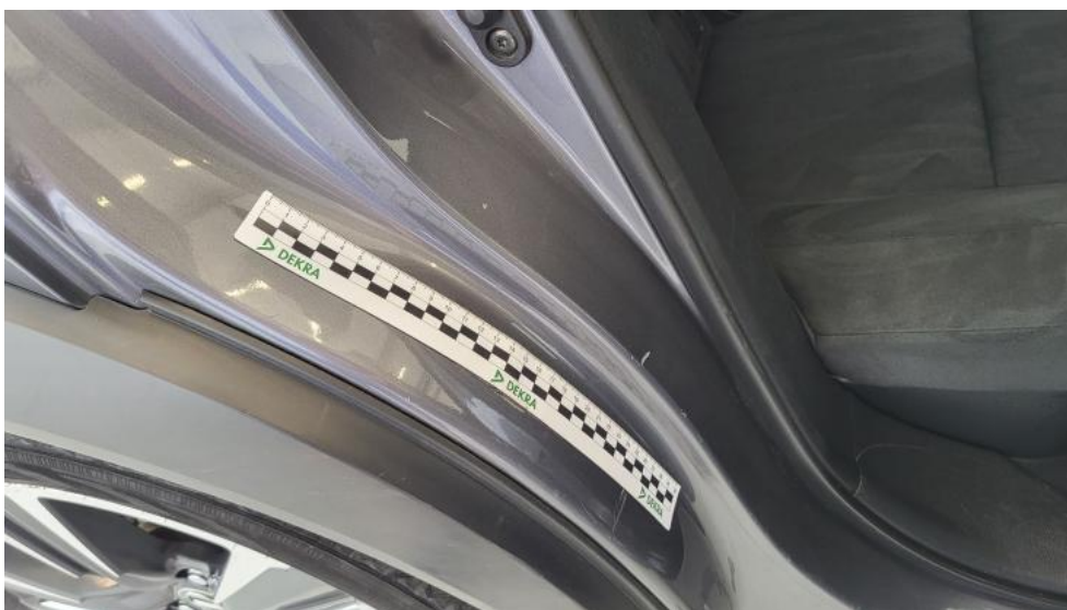
Photo 57. Błotnik tylny P / Ściana boczna P - Rysa/odprysk 1
