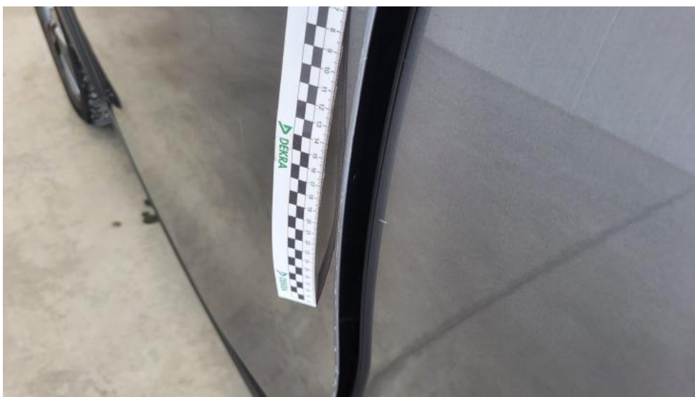
Photo 72. Drzwi przed L - Rysa/odprysk 1
