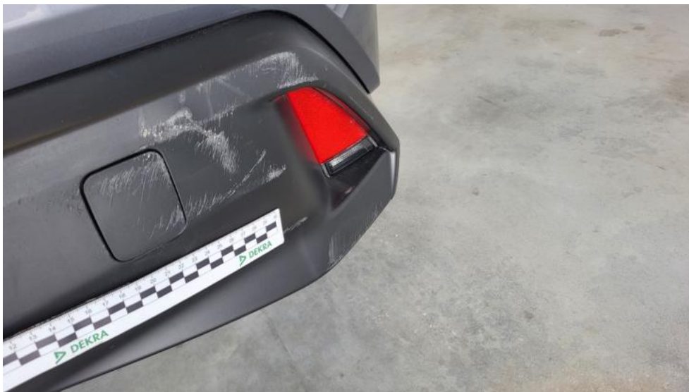
Photo 65. Zderzak tylny cz dolna - Rysa/odprysk 1
