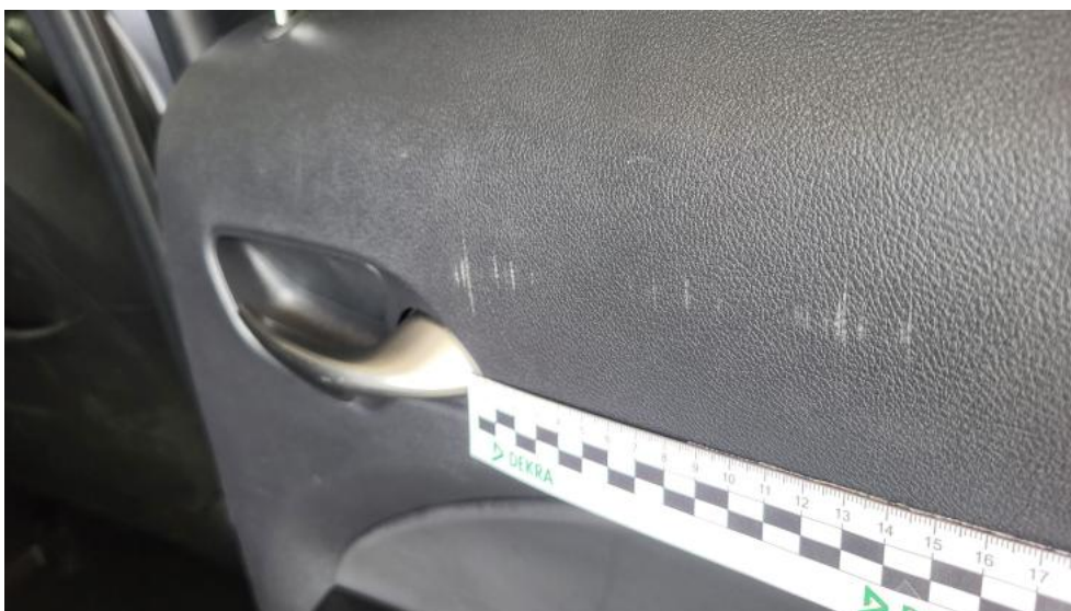
Photo 92. Tapicerka drzwi tylnych P - Rysa/odprysk 1
