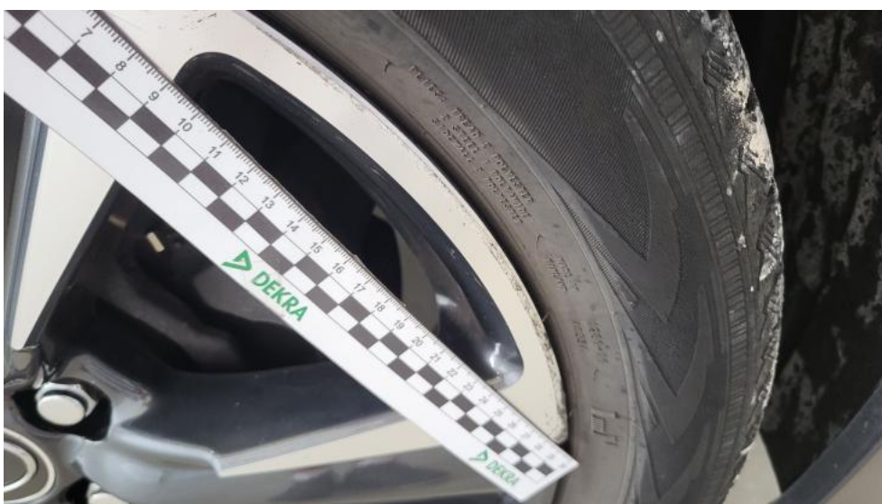
Photo 46. Felga aluminiowa przednia P - Rysa/odprysk 1
