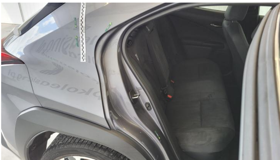
Photo 58. Błotnik tylny P / Ściana boczna P - Wgniecenie/odkształcenie 1
