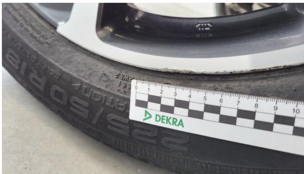
Photo 59. Felga aluminiowa tylna P - Rysa/odprysk 1
