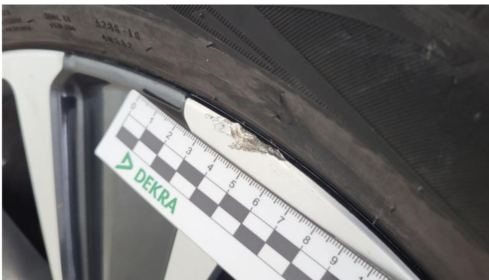
Photo 81. Felga Aluminiowa przednia L - Rysa/odprysk 1
