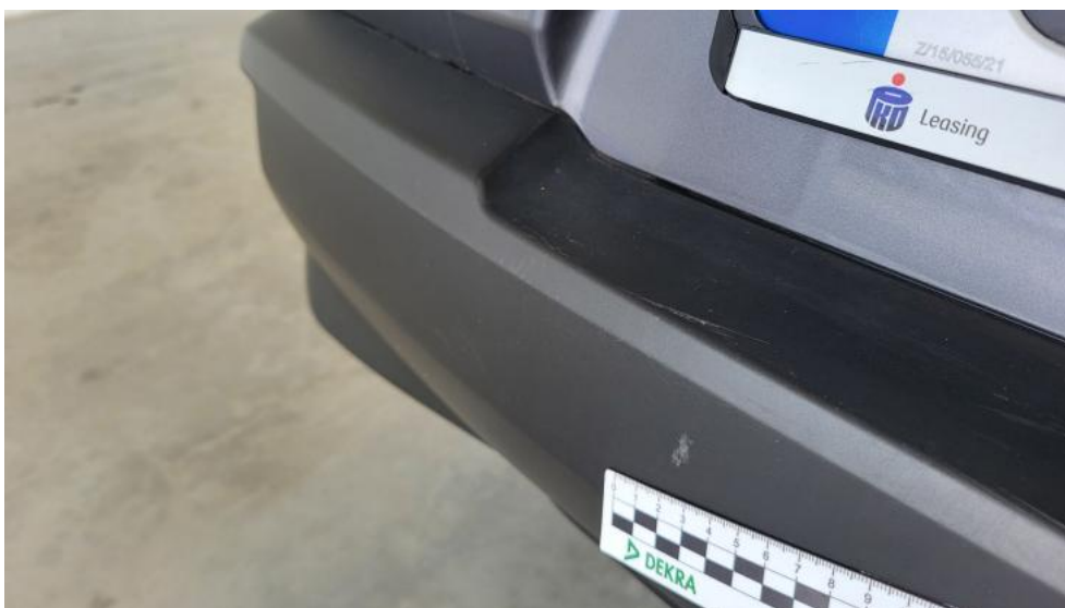
Photo 66. Zderzak tylny cz dolna - Rysa/odprysk 2
