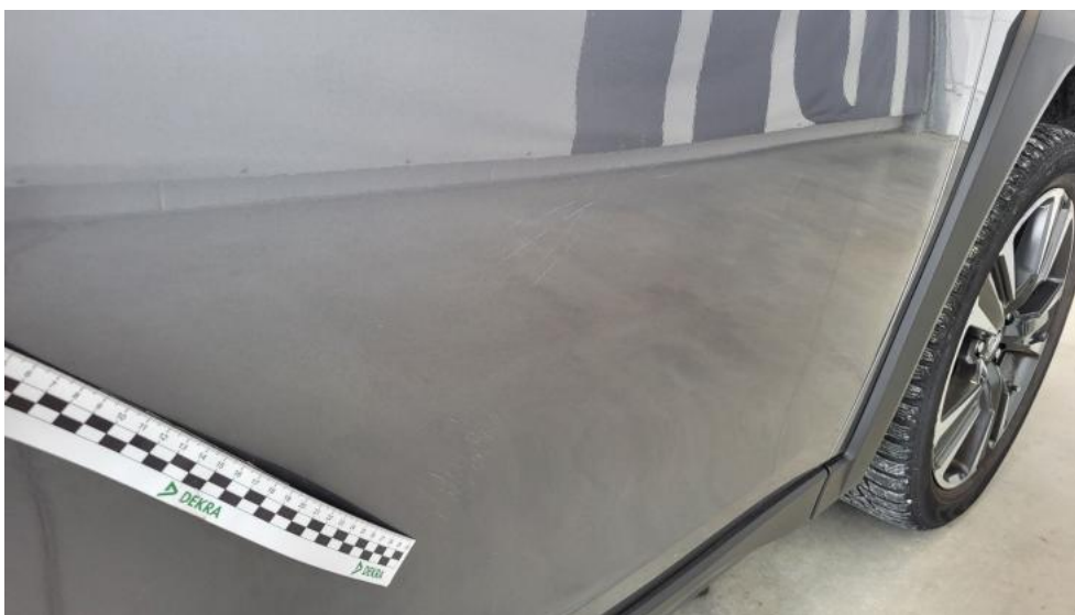
Photo 47. Drzwi przednie P - Rysa/odprysk 1
