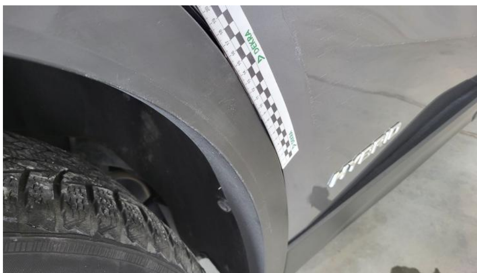
Photo 60. Listwa krawędzi błotnika tył P - Rysa/odprysk 1
