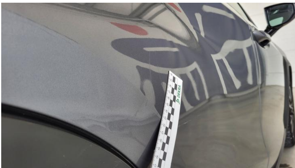
Photo 53. Drzwi tylne P - Wgniecenie/odkształcenie 1
