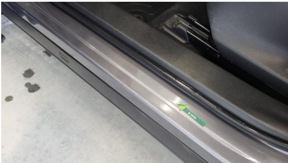
Photo 79. Próg L - Wgniecenie/odkształcenie 1
