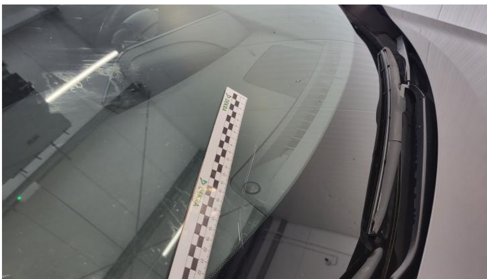
Photo 43. Szyba czołowa - Pęknięcie/rozerwanie 2
