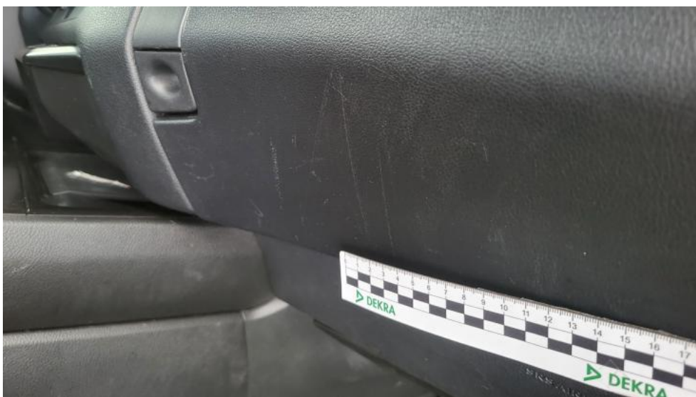
Photo 82. Deska rozdzielcza - Rysa/odprysk 1
