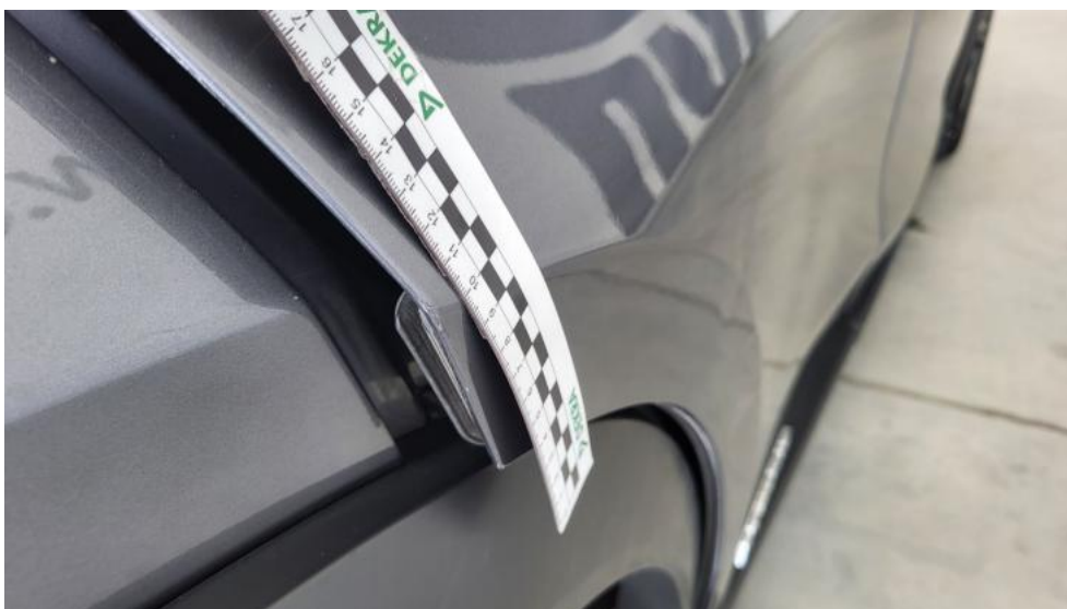
Photo 52. Drzwi tylne P() - Rysa/odprysk 3
