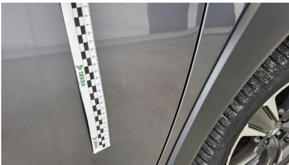
Photo 48. Drzwi przednie P - Rysa/odprysk 2
