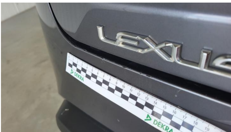
Photo 64. Zderzak tylny() - Rysa/odprysk 3
