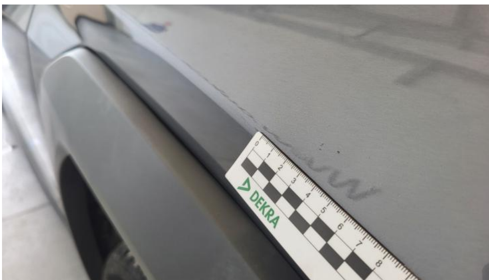
Photo 45. Błotnik przedni P - Rysa/odprysk 1
