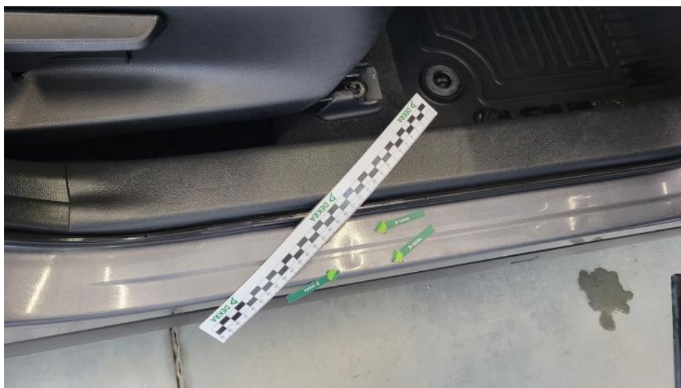
Photo 56. Próg P - Wgniecenie/odkształcenie 1
