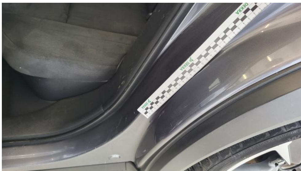
Photo 68. Błotnik tylny L / Ściana boczna L - Rysa/odprysk 1
