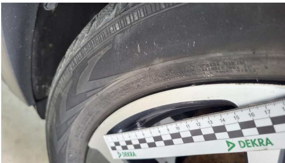
Photo 71. Felga aluminiowa tylna L - Rysa/odprysk 1
