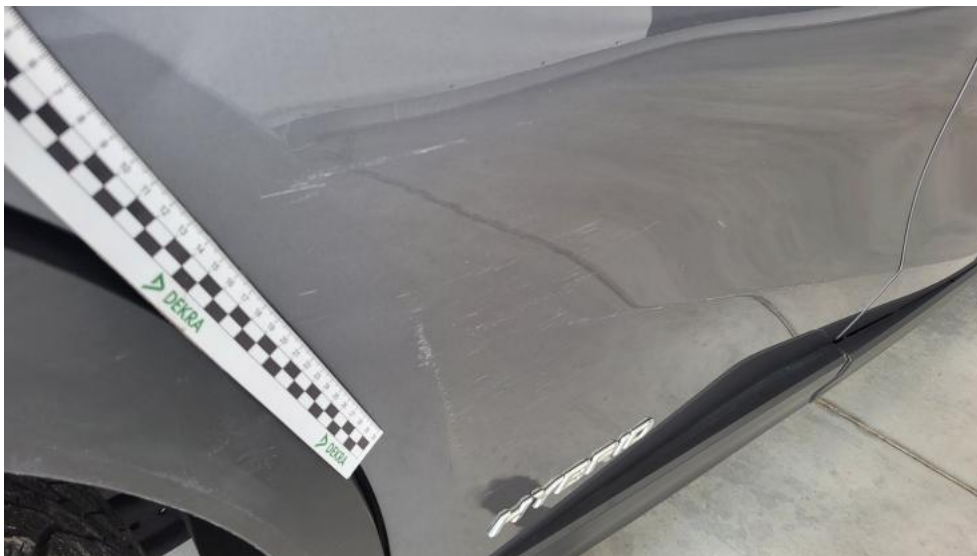
Photo 51. Drzwi tylne P - Rysa/odprysk 2
