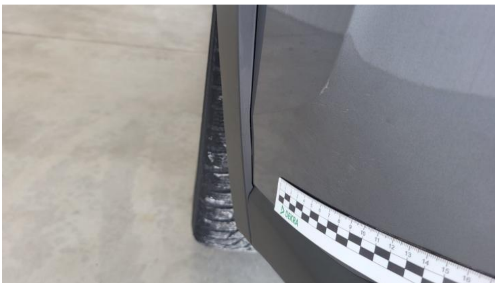
Photo 62. Zderzak tylny - Rysa/odprysk 1
