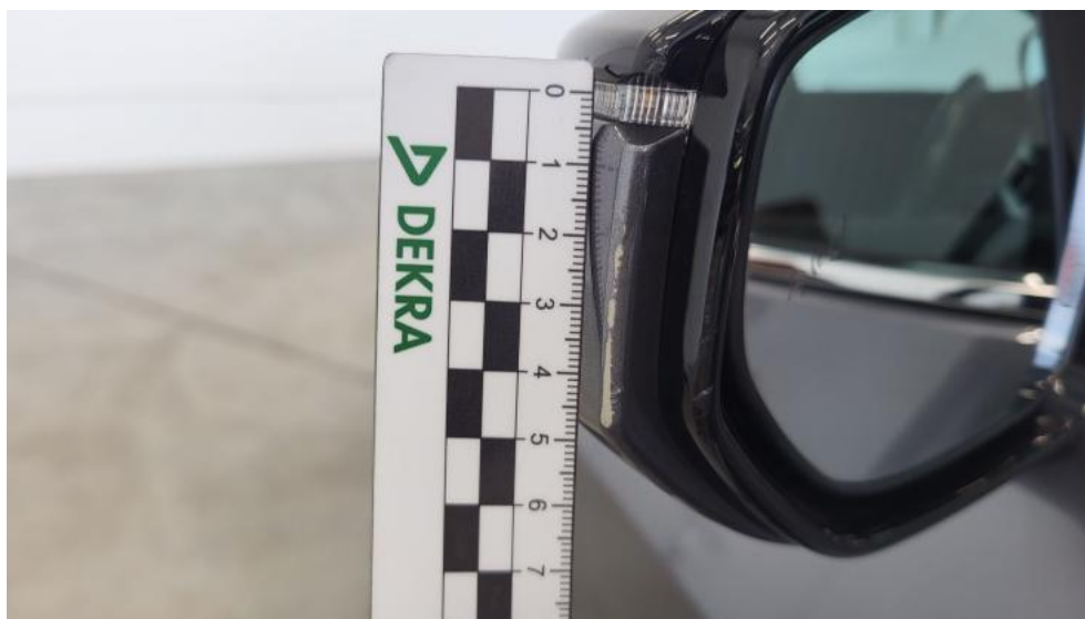
Photo 55. Lusterko zew P - Rysa/odprysk 1
