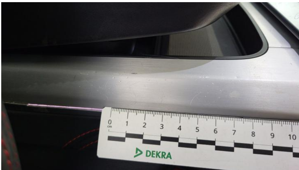
Fot. 95. Konsola tunelu śr. - Rysa/odprysk 1
