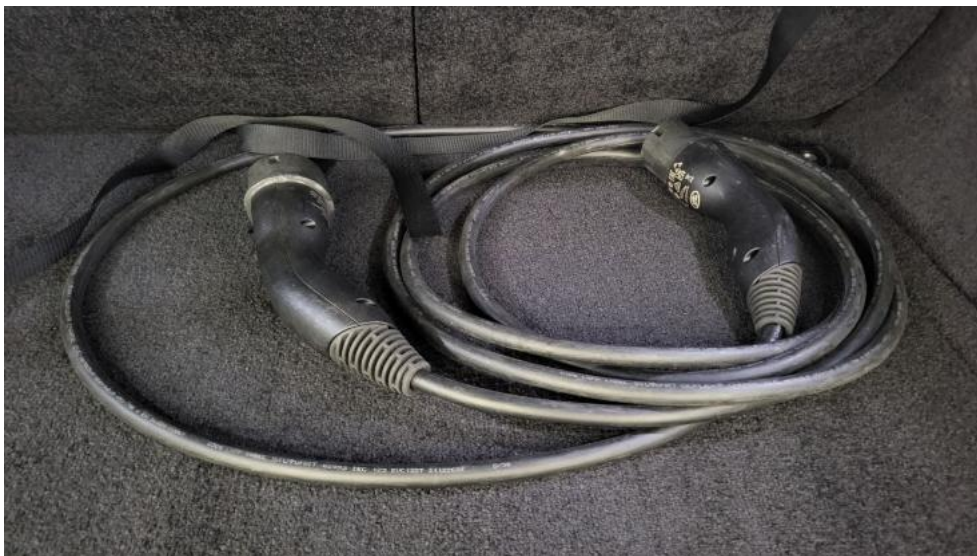
Fot. 33. Przewód ładowania baterii trakcyjnej
