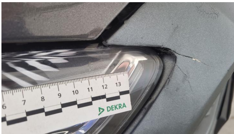
Photo 61. Reflektor P - Rysa/odprysk 1
