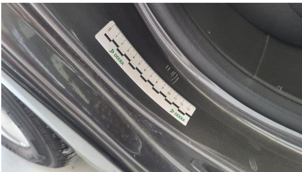
Photo 68. Błotnik tylny P / Ściana boczna P - Rysa/odprysk 1
