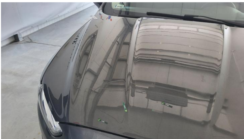
Photo 40. Pokrywa komory silnika - Wgniecenie/odkształcenie 2
