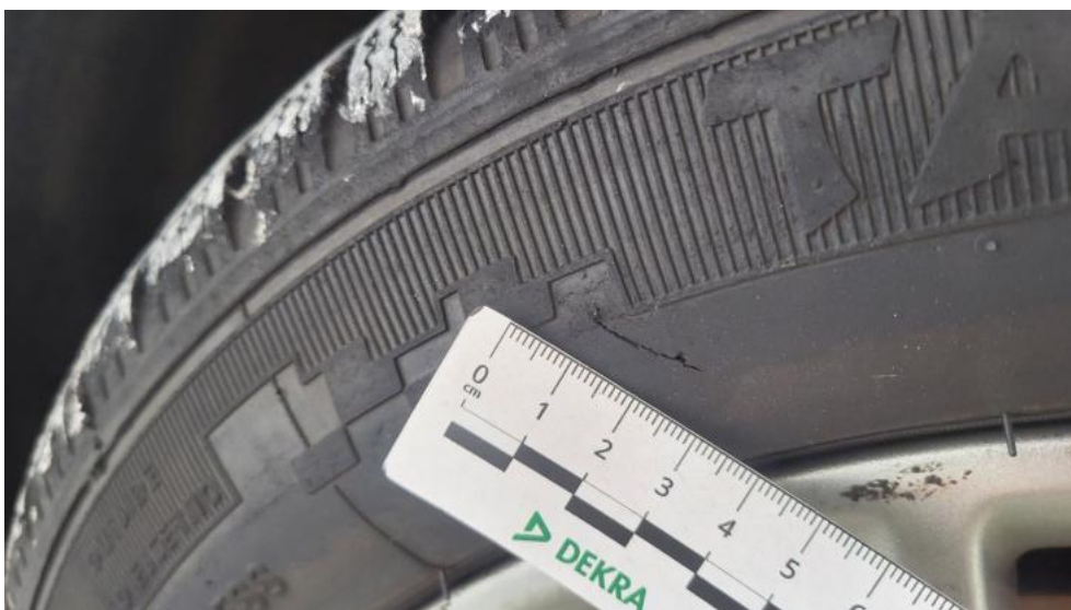
Photo 60. Opona przednia P - Pęknięcie/rozerwanie 1
