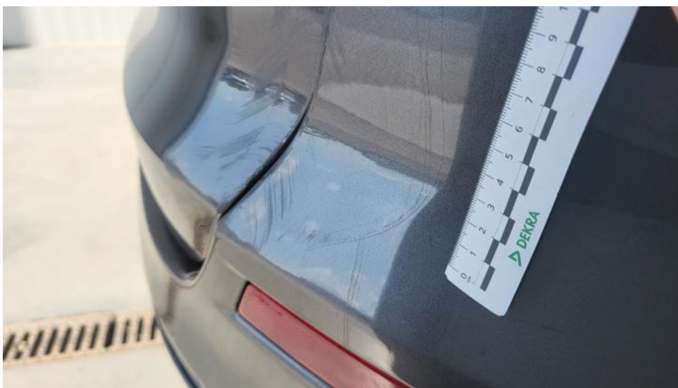
Photo 81. Zderzak tylny - Pęknięcie/rozerwanie 1
