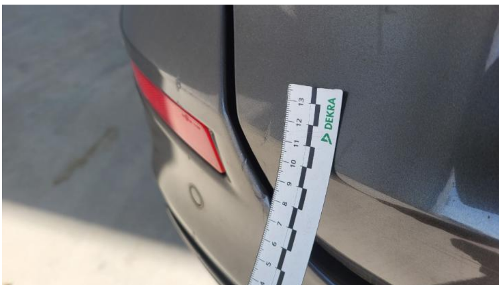
Photo 76. Pokrywy bagażnika - Wgniecenie/odkształcenie 2
