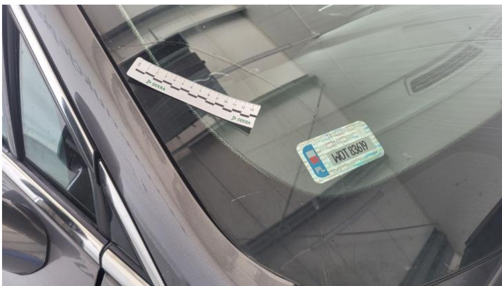
Photo 44. Szyba czołowa - Pęknięcie/rozerwanie 2
