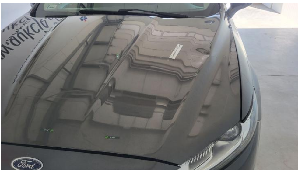
Photo 39. Pokrywa komory silnika - Wgniecenie/odkształcenie 1
