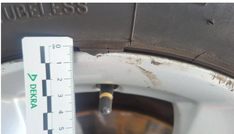
Photo 88. Opona tylna L - Pęknięcie/rozerwanie 1
