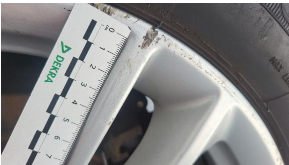
Photo 87. Felga aluminiowa tylna L - Rysa/odprysk 1
