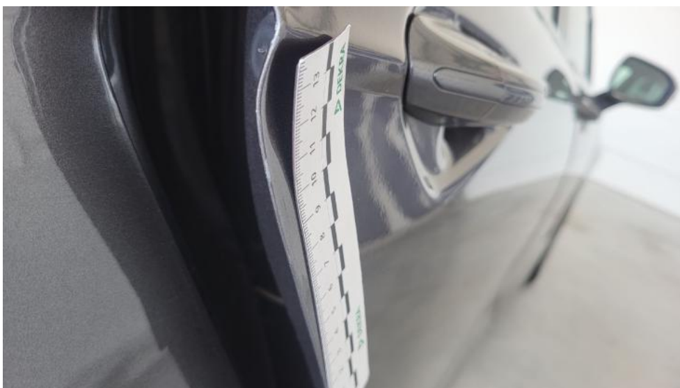
Photo 64. Drzwi tylne P - Rysa/odprysk 1
