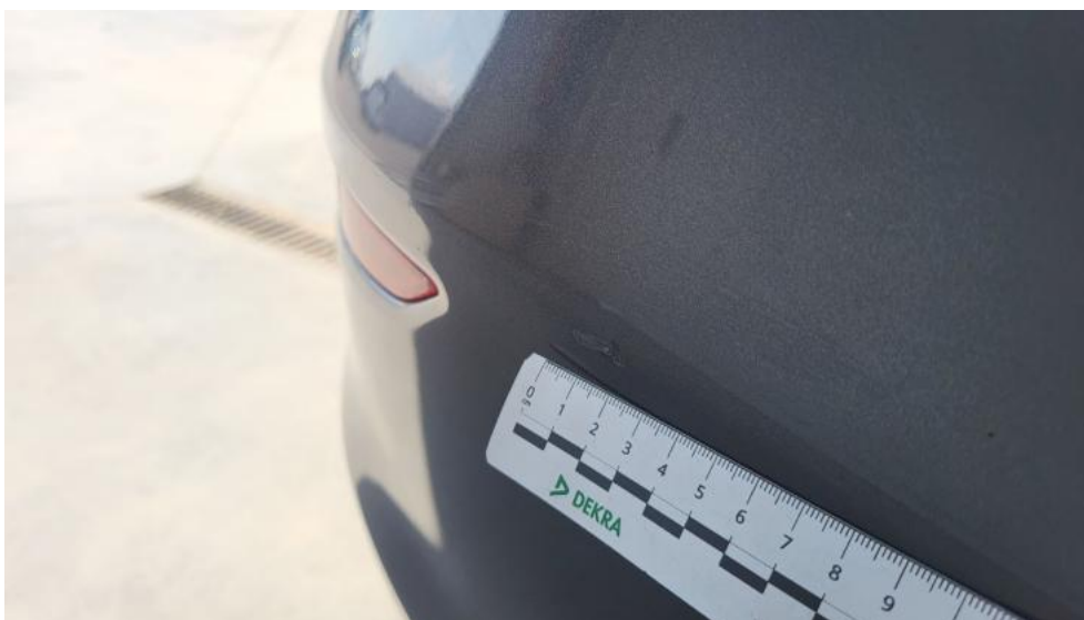
Photo 77. Zderzak tylny - Rysa/odprysk 1
