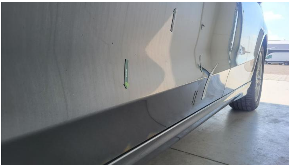
Photo 91. Drzwi przed L - Wgniecenie/odkształcenie 2
