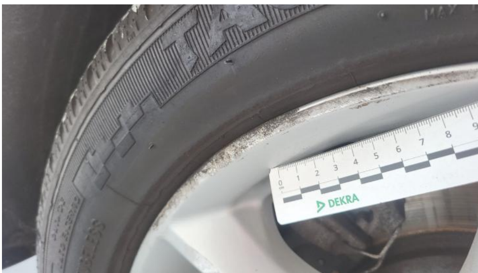
Photo 71. Felga aluminiowa tylna P - Rysa/odprysk 1
