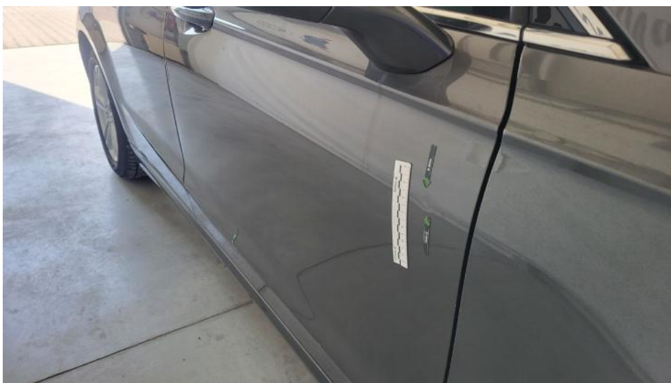
Photo 63. Drzwi przednie P - Wgniecenie/odkształcenie 1
