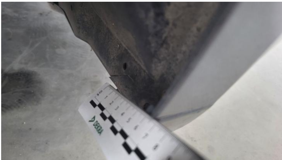
Photo 59. Nadkole przednie P - Pęknięcie/rozerwanie 1
