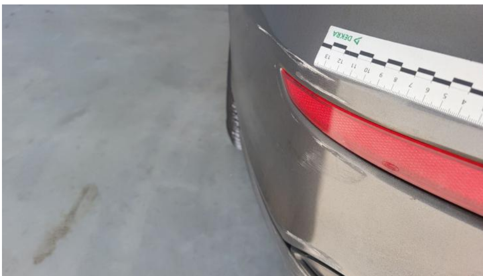
Photo 78. Zderzak tylny - Rysa/odprysk 2
