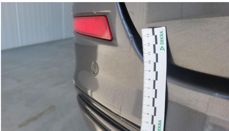
Photo 79. Zderzak tylny - Wgniecenie/odkształcenie 1
