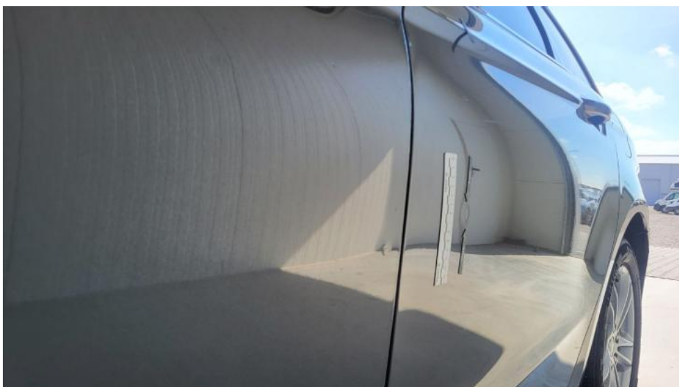
Photo 93. Drzwi tylne L - Wgniecenie/odkształcenie 1
