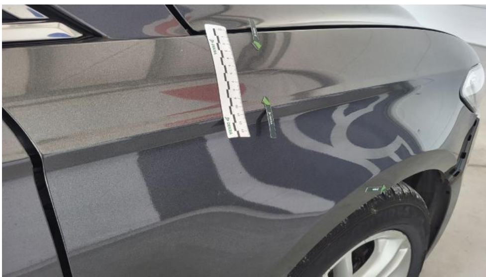
Photo 56. Błotnik przedni P - Wgniecenie/odkształcenie 1
