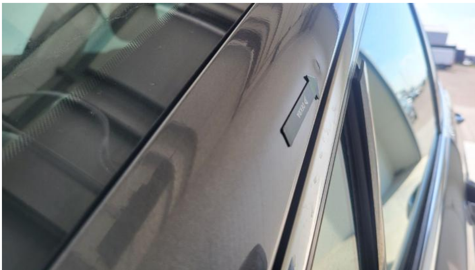
Photo 97. Słupek przedni L - Wgniecenie/odkształcenie 1
