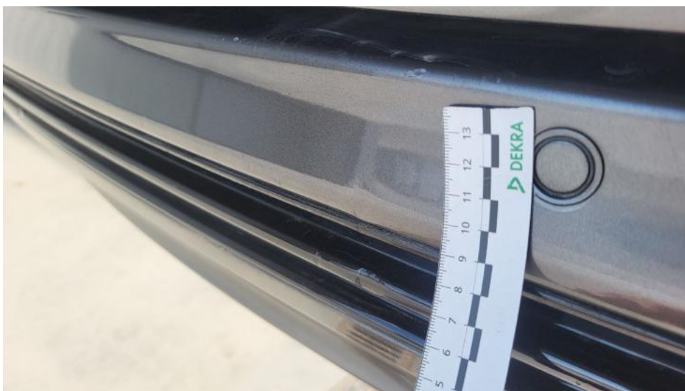
Photo 80. Zderzak tylny - Wgniecenie/odkształcenie 2
