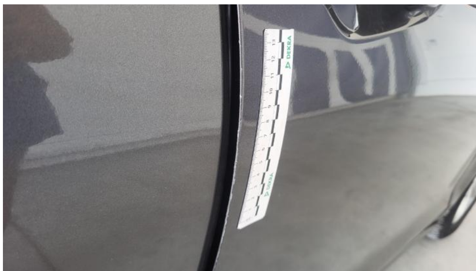
Photo 62. Drzwi przednie P - Rysa/odprysk 1
