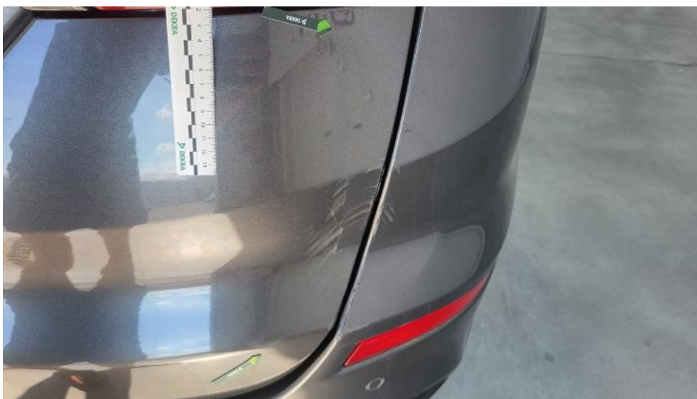
Photo 75. Pokrywy bagażnika - Wgniecenie/odkształcenie 1
