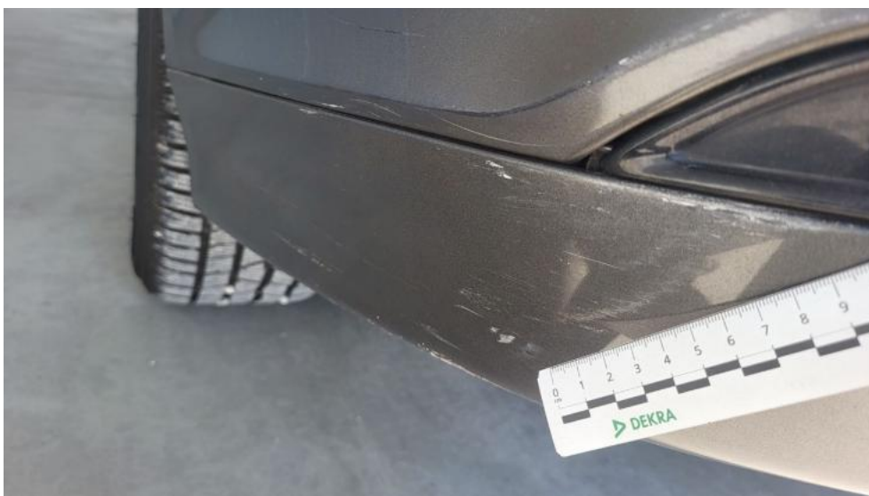
Photo 82. Zderzak tylny cz dolna - Rysa/odprysk 1
