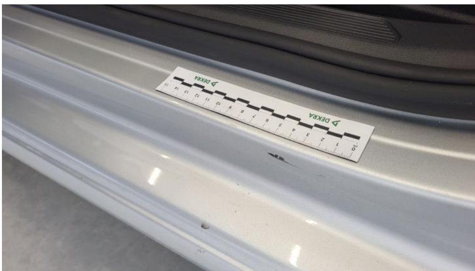
Fot. 65. Próg L - Rysa/odprysk 1
