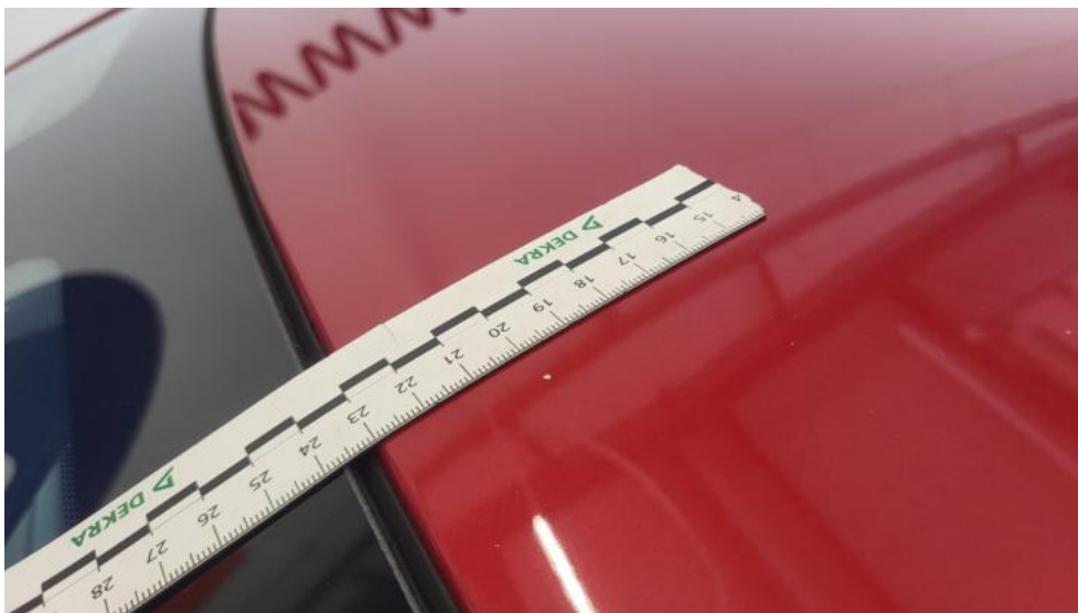
Fot. 61. Dach - Rysa/odprysk 1
