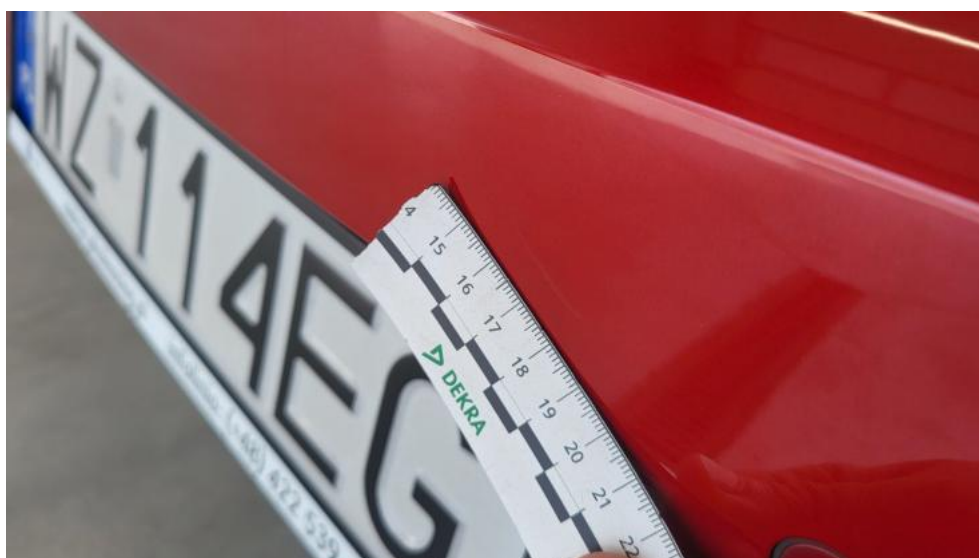
Fot. 58. Zderzak tylny - Rysa/odprysk 1
