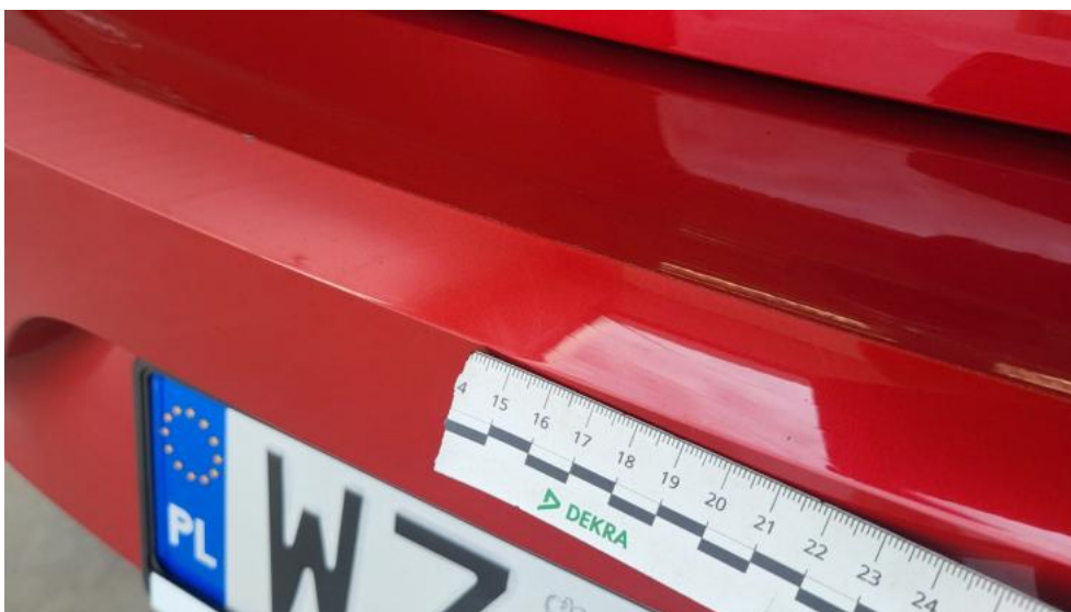
Fot. 60. Zderzak tylny - Pęknięcie/rozerwanie 1
