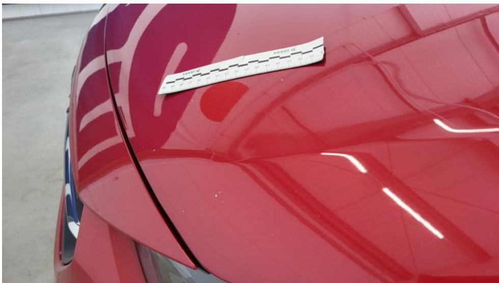
Fot. 40. Pokrywa komory silnika - Rysa/odprysk 1
