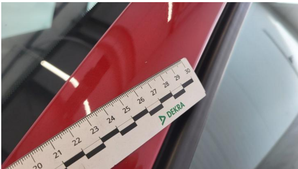
Fot. 73. Słupek przedni L - Rysa/odprysk 1
