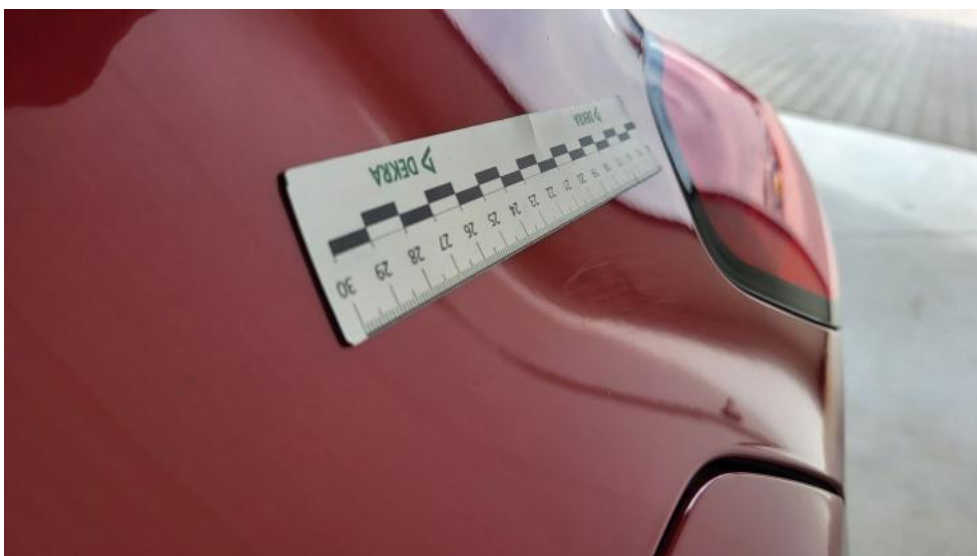
Fot. 62. Błotnik tylny L / Ściana boczna L - Rysa/odprysk 1
