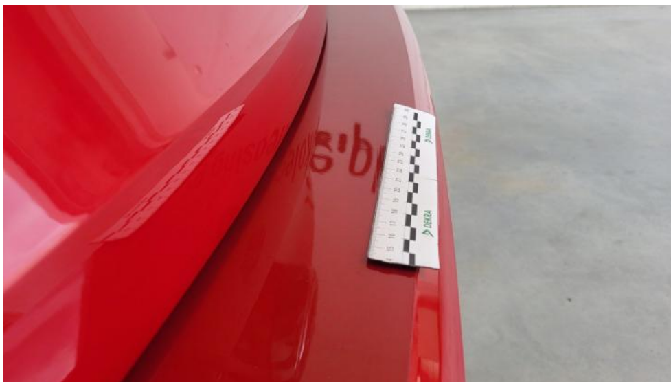
Fot. 59. Zderzak tylny - Wgniecenie/odkształcenie 1
