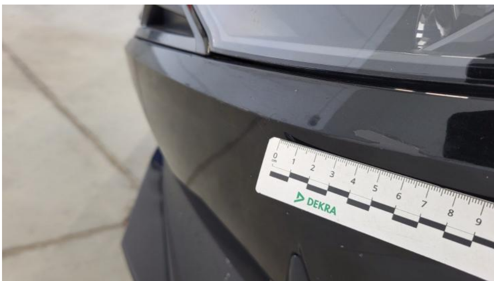
Fot. 46. Zderzak - Rysa/odprysk 1
