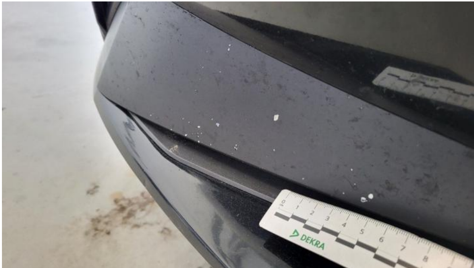
Fot. 51. Zderzak przedni cz P - Rysa/odprysk 1
