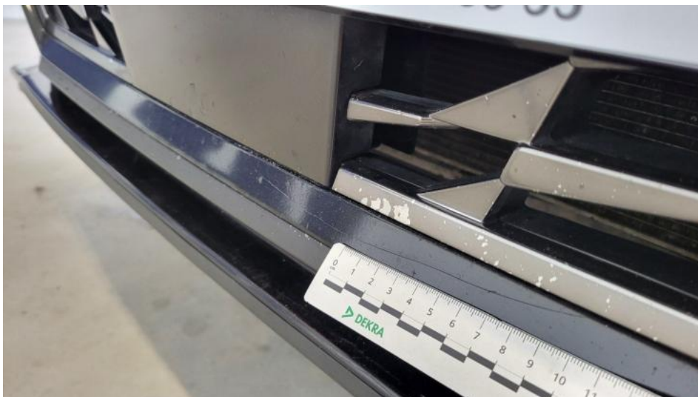
Fot. 49. Zderzak - Pęknięcie/rozerwanie 2
