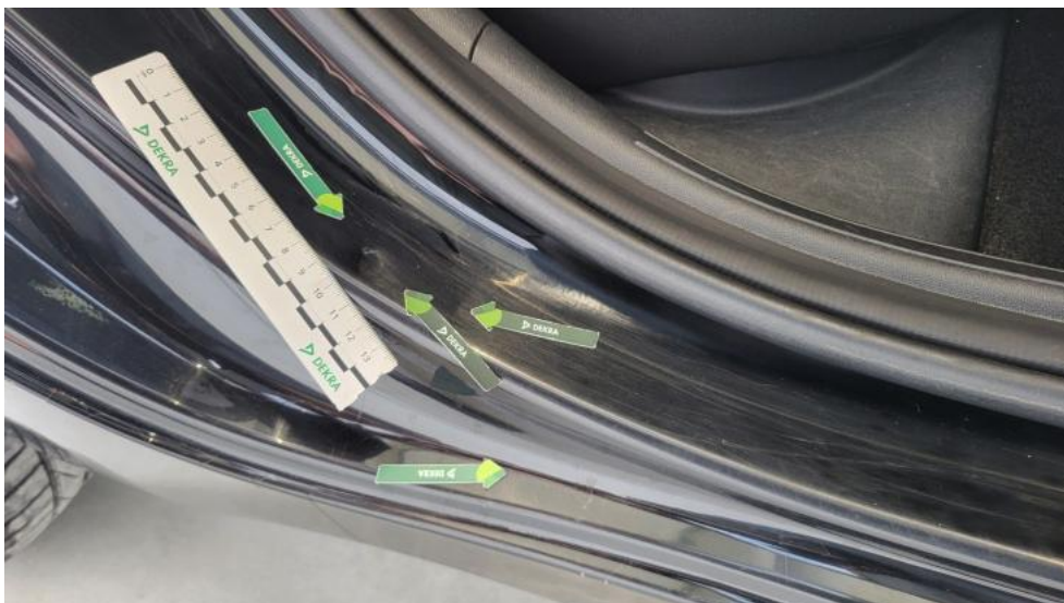
Fot. 63. Próg P - Wgniecenie/odkształcenie 2
