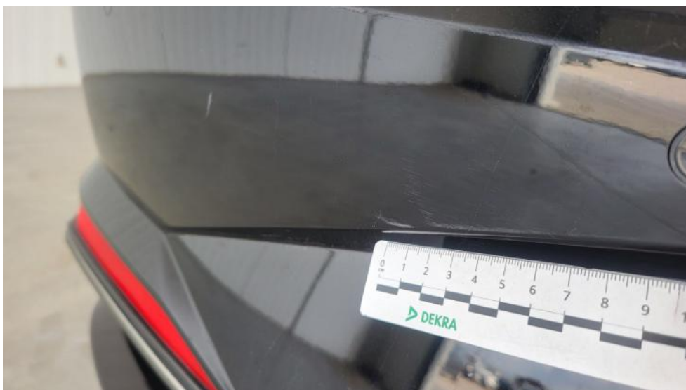
Fot. 76. Zderzak tylny() - Rysa/odprysk 3
