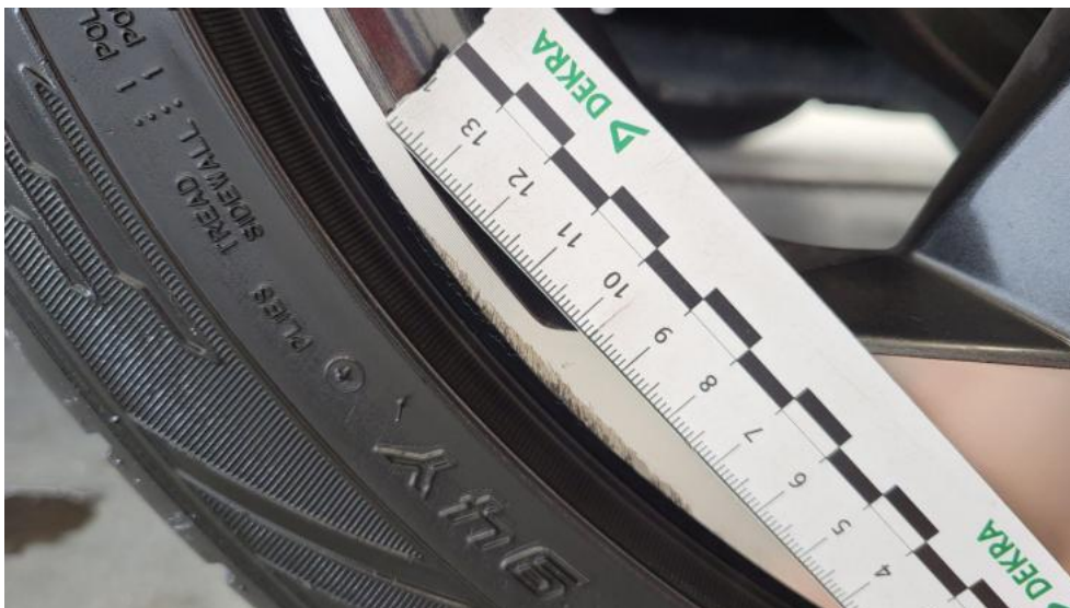
Fot. 52. Felga aluminiowa przednia P - Rysa/odprysk 1
