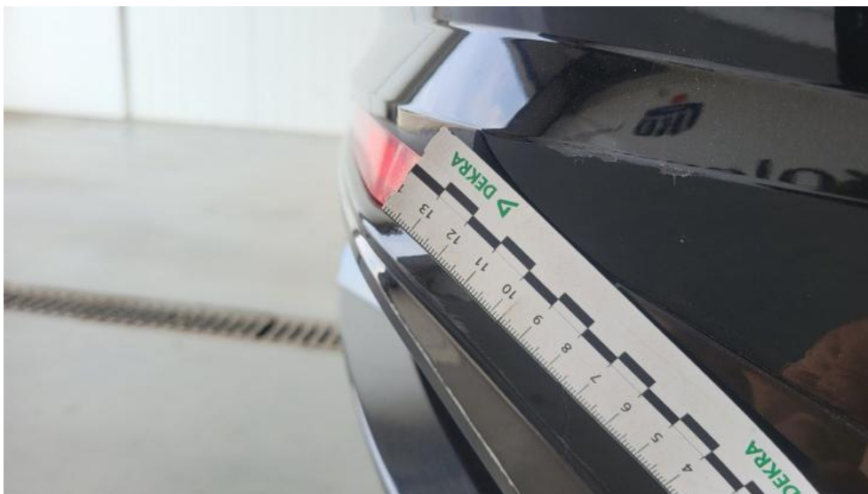
Fot. 75. Zderzak tylny - Rysa/odprysk 2
