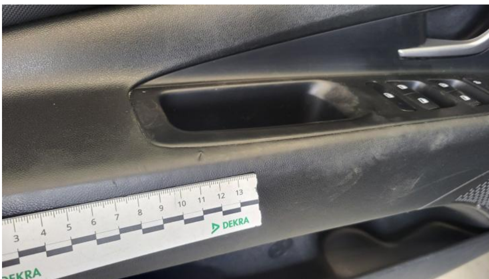
Fot. 108. Tapicerka drzwi przednich L - Pęknięcie/rozerwanie 1
