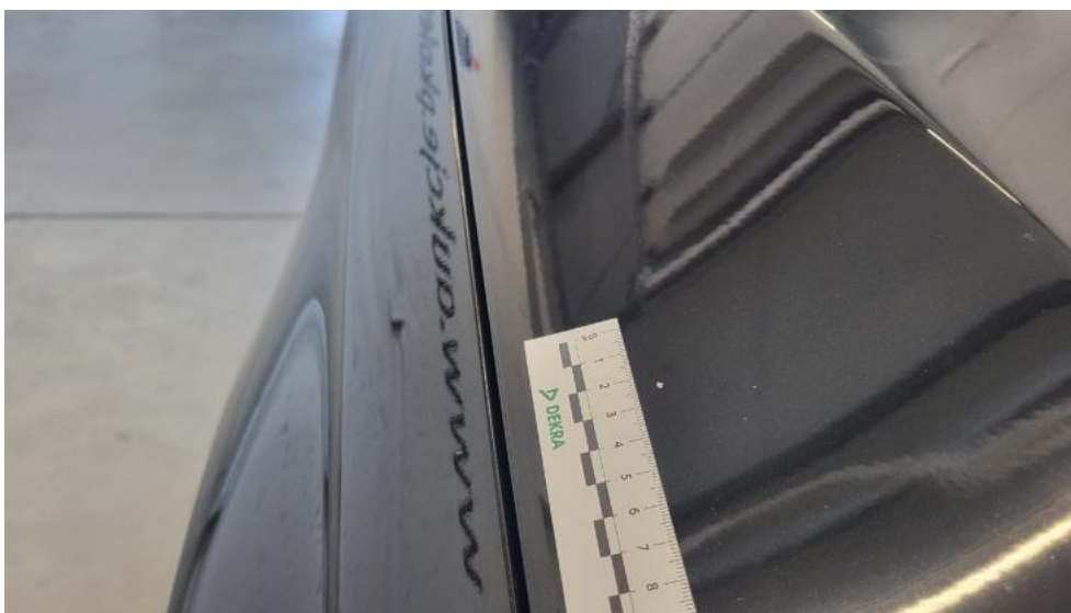
Photo 43. Pokrywa komory silnika - Rysa/odprysk 2
