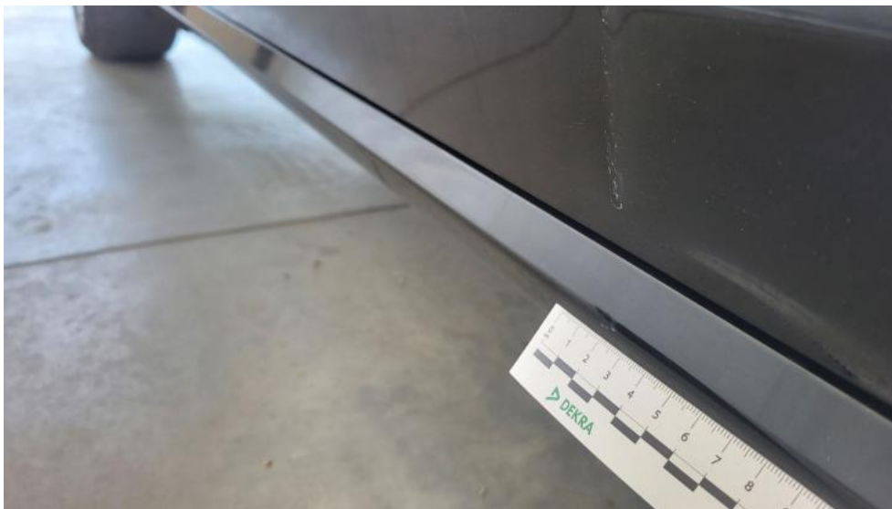
Photo 55. Próg P - Wgniecenie/odkształcenie 2
