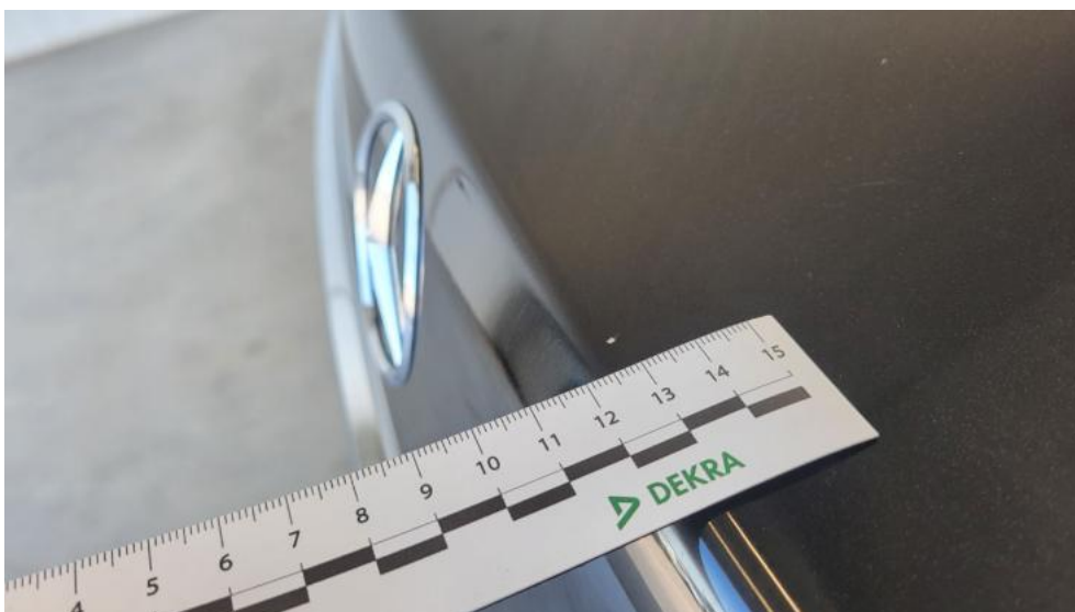
Photo 60. Pokrywy bagażnika - Rysa/odprysk 1
