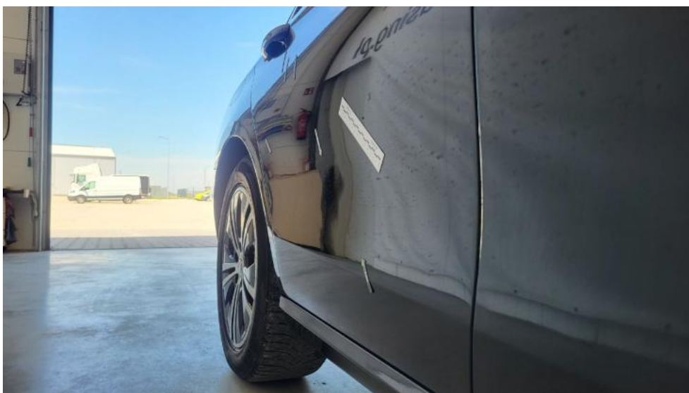
Photo 52. Drzwi tylne P - Wgniecenie/odkształcenie 1
