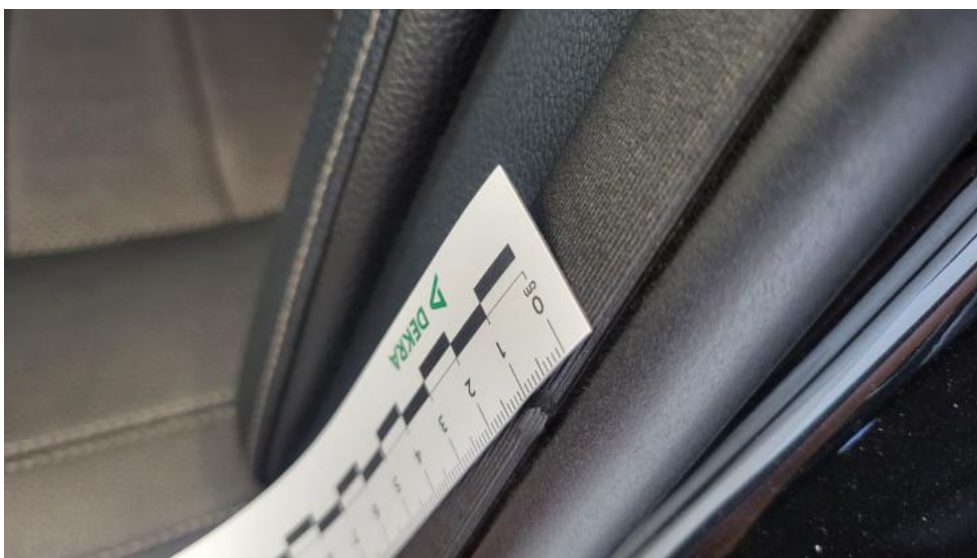
Photo 84. Wykładzina(y) słupka tylnego L - Pęknięcie/rozerwanie 1
