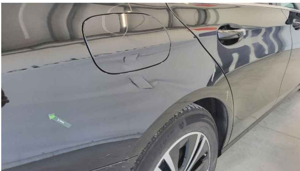
Photo 59. Błotnik tylny P / Ściana boczna P() - Wgniecenie/odkształcenie 3
