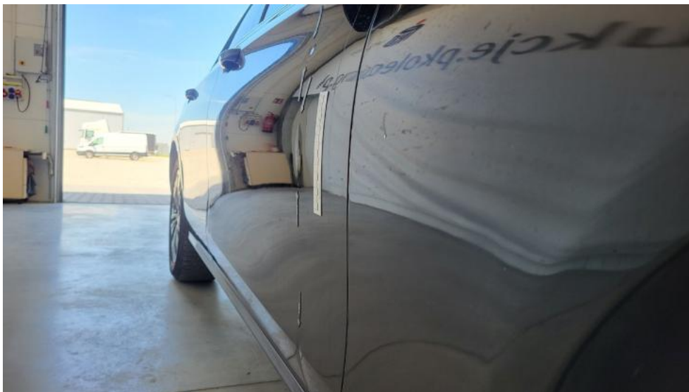
Photo 51. Drzwi przednie P - Wgniecenie/odkształcenie 1
