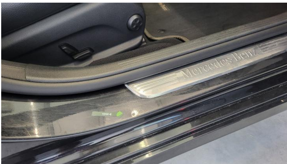
Photo 54. Próg P - Wgniecenie/odkształcenie 1
