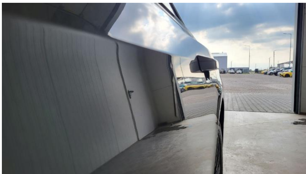
Fot. 67. Drzwi tylne L - Wgniecenie/odkształcenie 1
