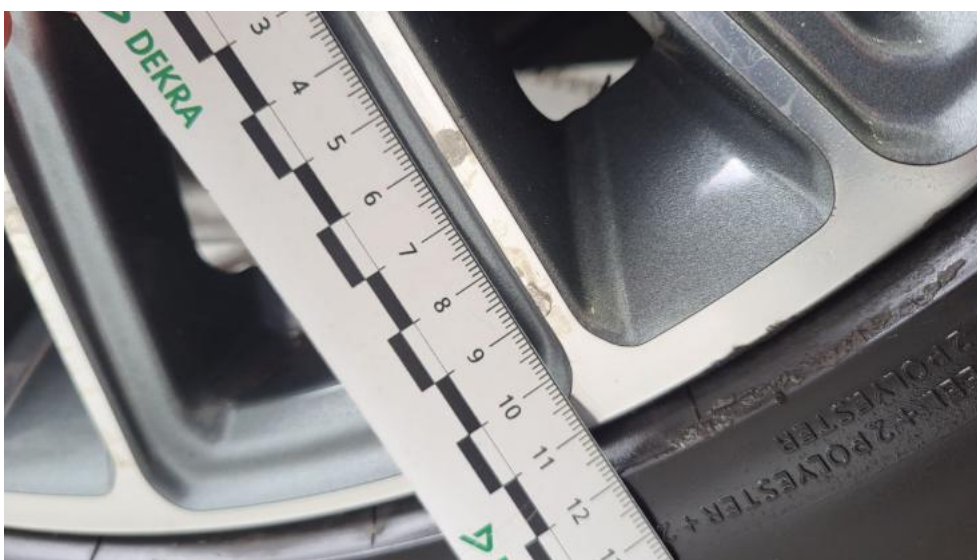
Fot. 62. Felga aluminiowa tylna P - Rysa/odprysk 1
