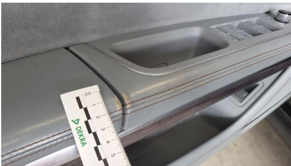
Fot. 70. Tapicerka drzwi przednich L - Rysa/odprysk 1
