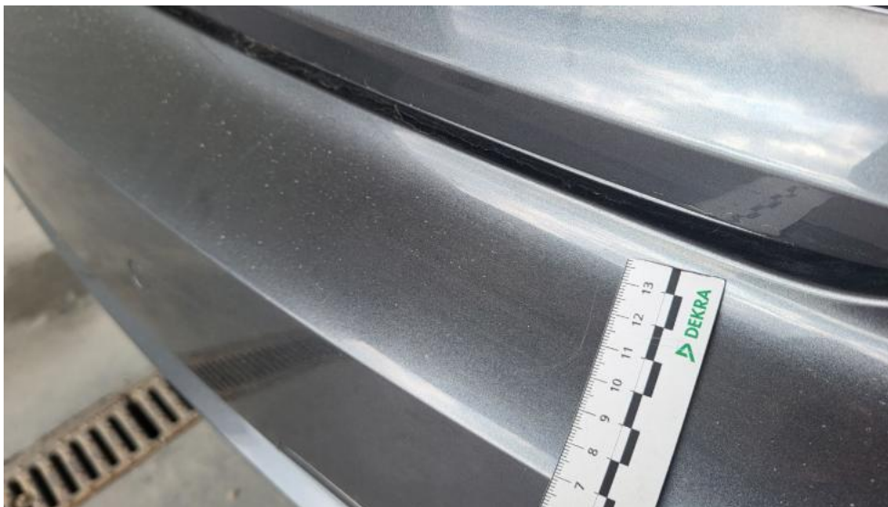
Fot. 65. Zderzak tylny() - Rysa/odprysk 3
