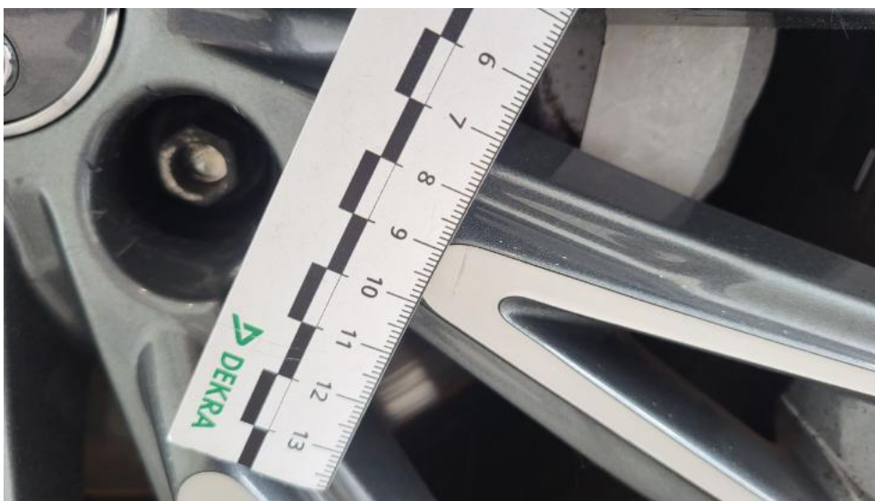
Fot. 69. Felga Aluminiowa przednia L - Rysa/odprysk 1
