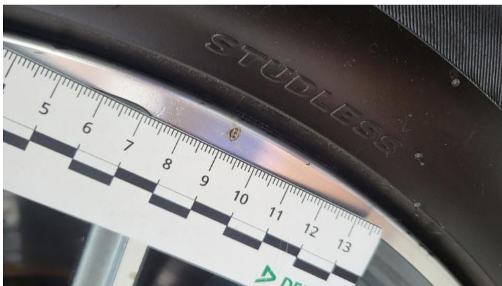
Fot. 55. Felga aluminiowa przednia P - Rysa/odprysk 1
