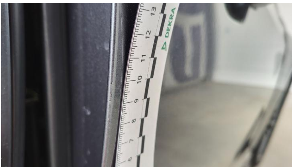
Fot. 57. Drzwi przednie P - Rysa/odprysk 1
