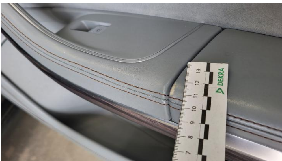
Fot. 71. Tapicerka drzwi przednich P - Rysa/odprysk 1
