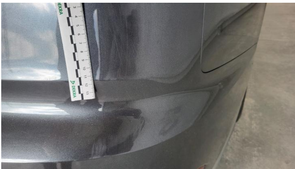
Fot. 63. Zderzak tylny - Rysa/odprysk 1
