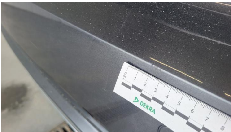
Fot. 64. Zderzak tylny - Rysa/odprysk 2
