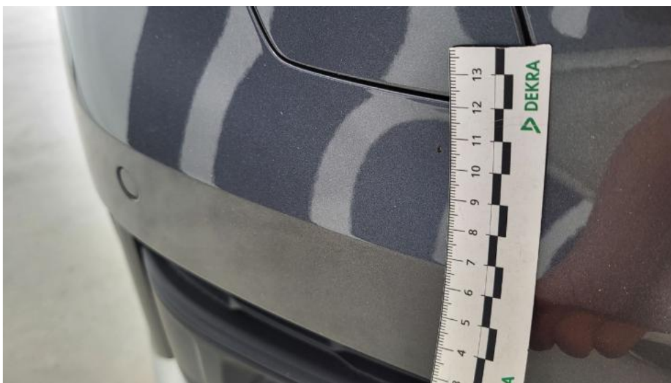
Fot. 54. Zderzak - Rysa/odprysk 1
