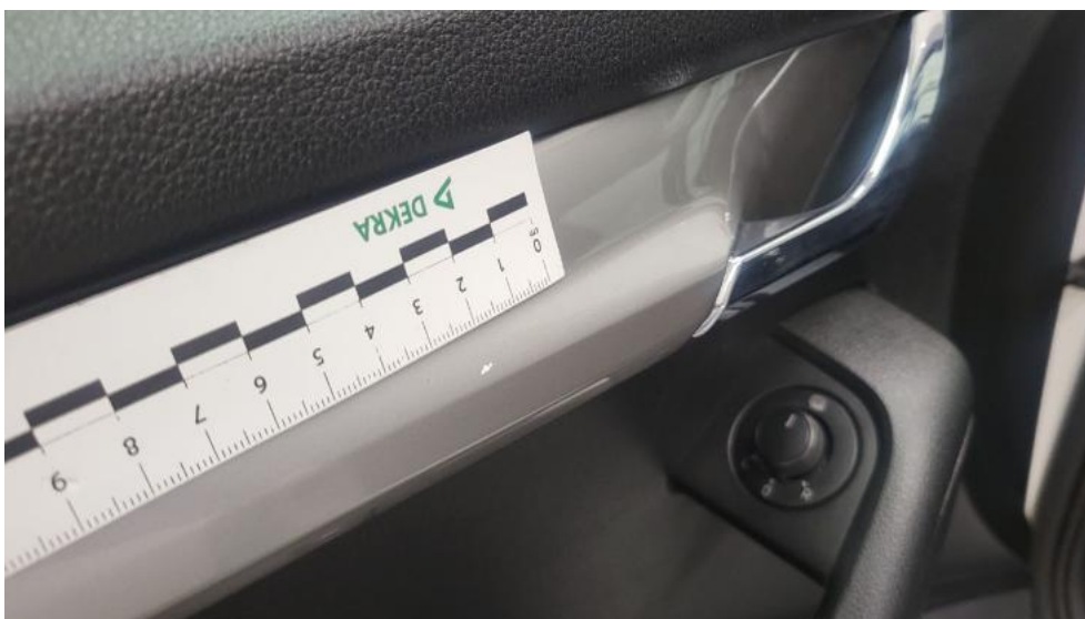
Photo 82. Tapicerka drzwi przednich L - Rysa/odprysk 1
