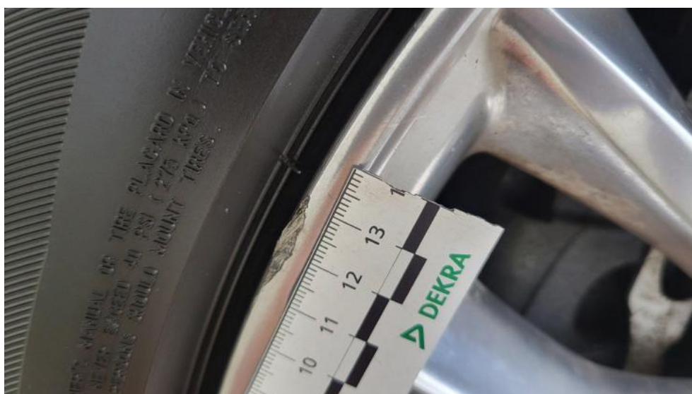
Fot. 60. Felga Aluminiowa przednia L - Rysa/odprysk 1
