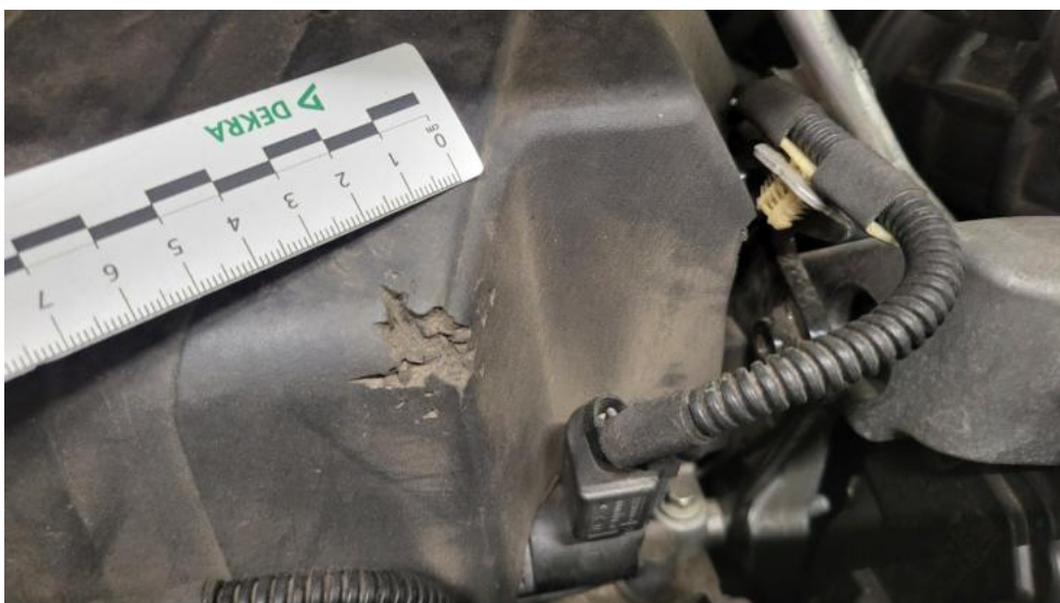
Fot. 40. Osłona silnika - ubytki materiału
