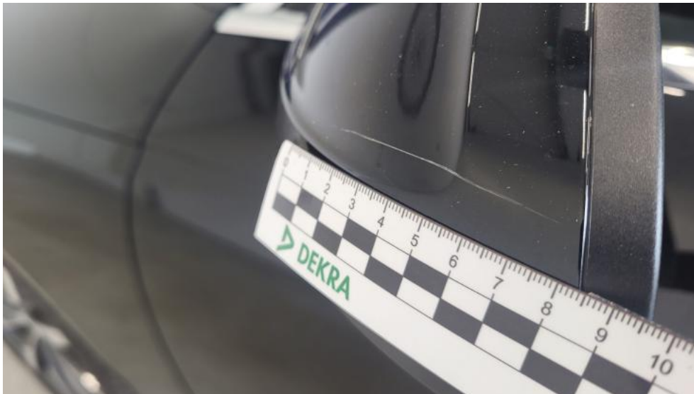
Fot. 43. Lusterko zew L - Rysa/odprysk 1
