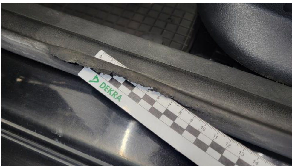
Photo 88. Uszczelka drzwi przednich L - Pęknięcie/rozerwanie 1
