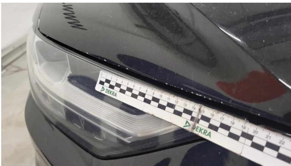
Fot. 52. Pokrywa komory silnika - Rysa/odprysk 1
