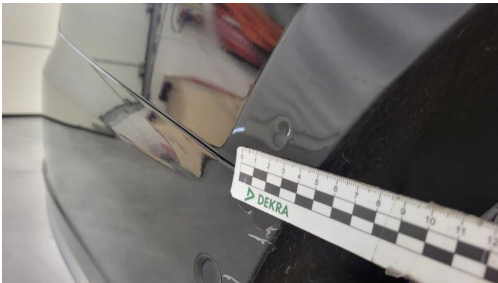
Fot. 69. Błotnik tylny P / Ściana boczna P - Wgniecenie/odkształcenie 1
