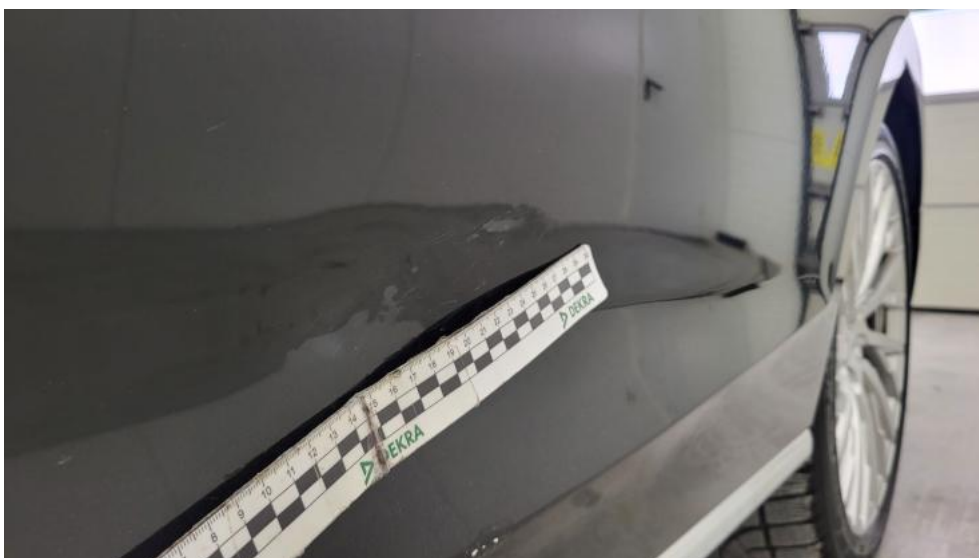
Fot. 80. Drzwi tylne L - Wgniecenie/odkształcenie 1
