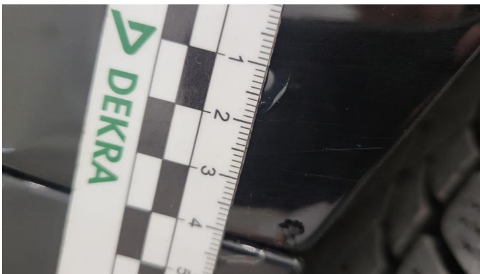
Fot. 70. Błotnik tylny P / Ściana boczna P - Pęknięcie/rozerwanie 1
