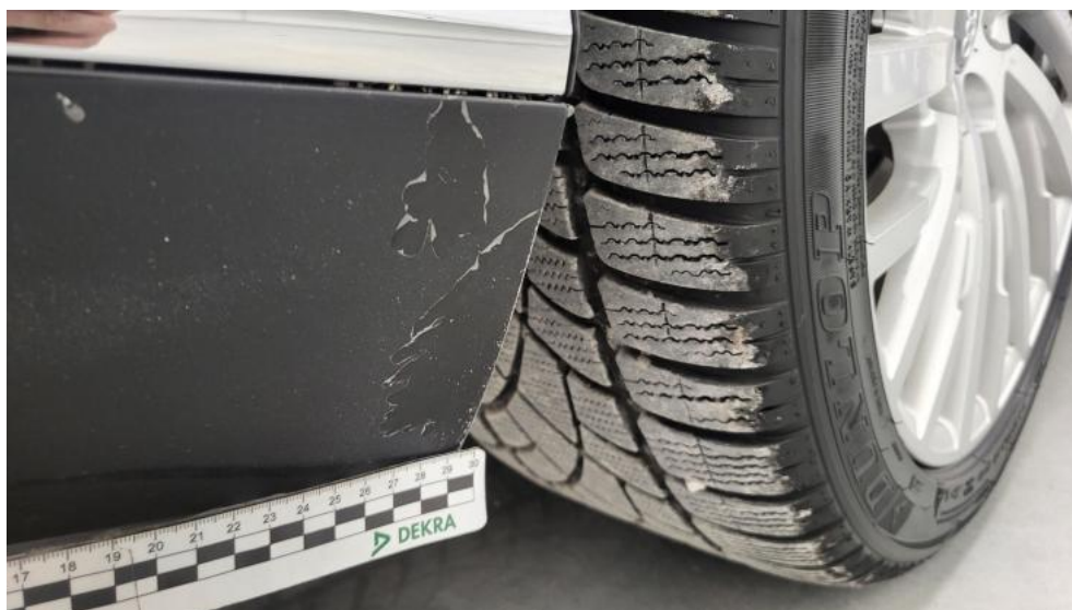
Fot. 74. Zderzak tylny cz dolna - Inne 2
