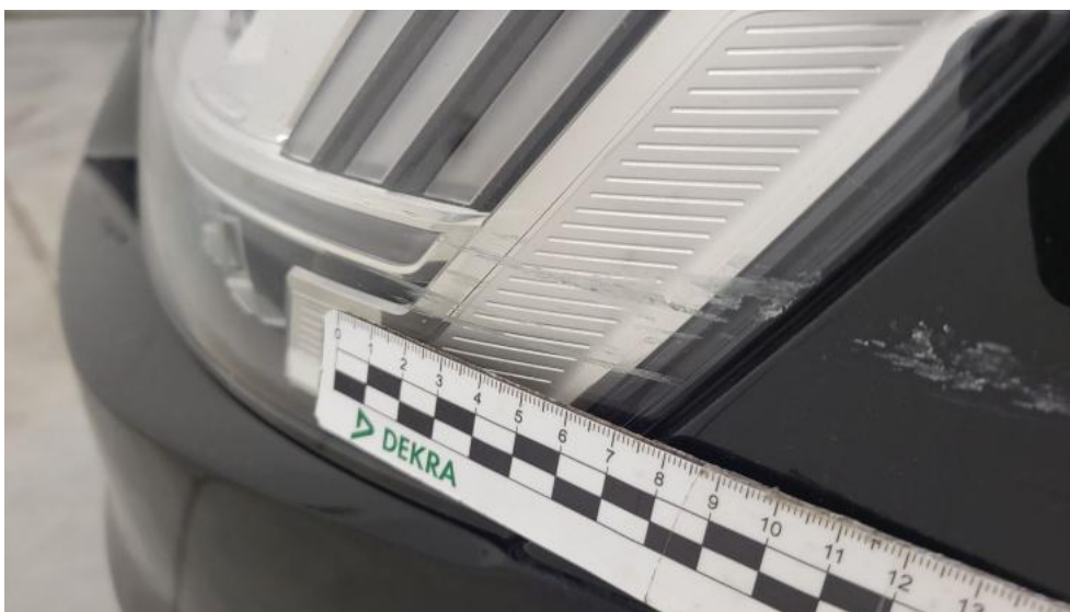
Fot. 85. Reflektor L - Rysa/odprysk 1
