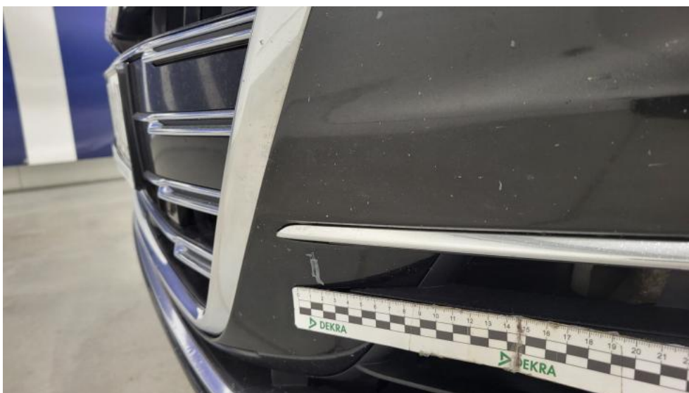
Fot. 61. Zderzak - Rysa/odprysk 2
