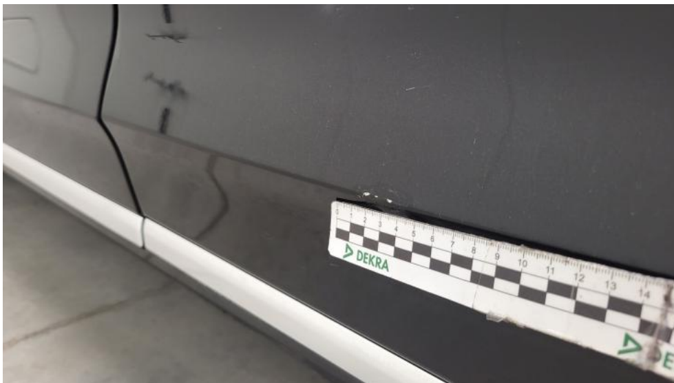
Fot. 79. Drzwi tylne L - Rysa/odprysk 2
