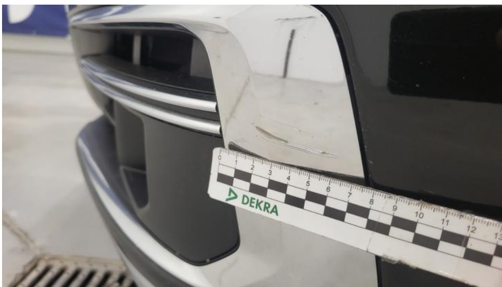
Fot. 50. Kratka/zaślepka halogenu L - Rysa/odprysk 1
