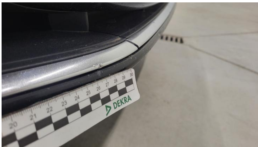
Fot. 63. Zderzak - Wgniecenie/odkształcenie 1
