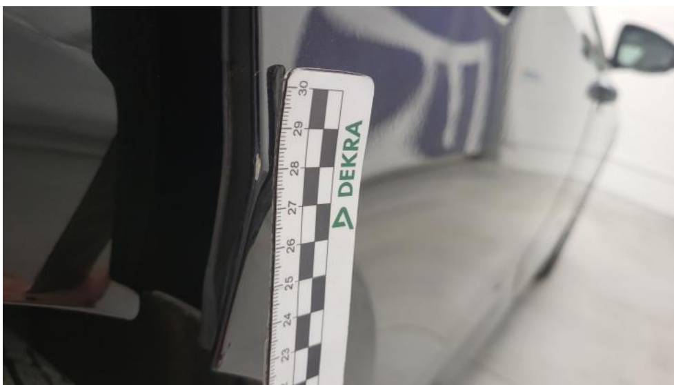
Fot. 66. Drzwi tylne P - Rysa/odprysk 1
