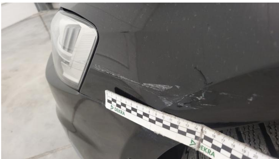
Fot. 82. Błotnik przedni L - Rysa/odprysk 1
