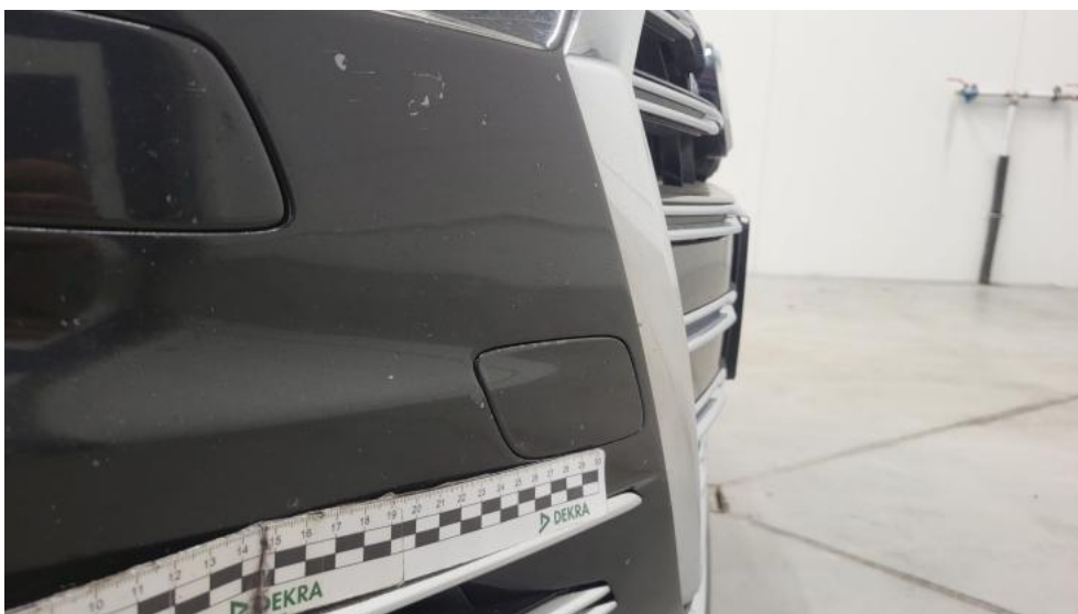
Fot. 62. Zderzak() - Rysa/odprysk 3
