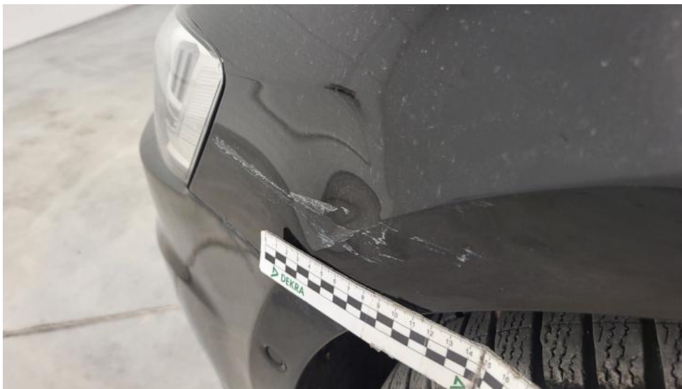
Fot. 83. Błotnik przedni L - Wgniecenie/odkształcenie 1
