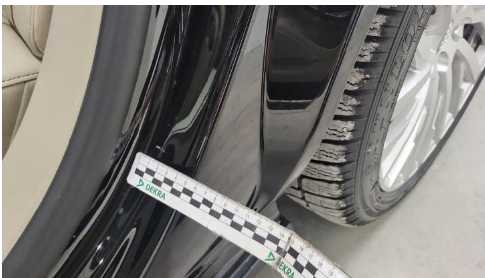
Fot. 76. Błotnik tylny L / Ściana boczna L - Rysa/odprysk 2
